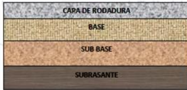
Figura 1. Partes de un pavimento flexible
