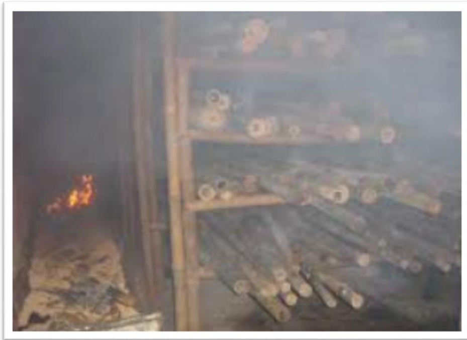
Figura 5. Curado del bambú por humo
