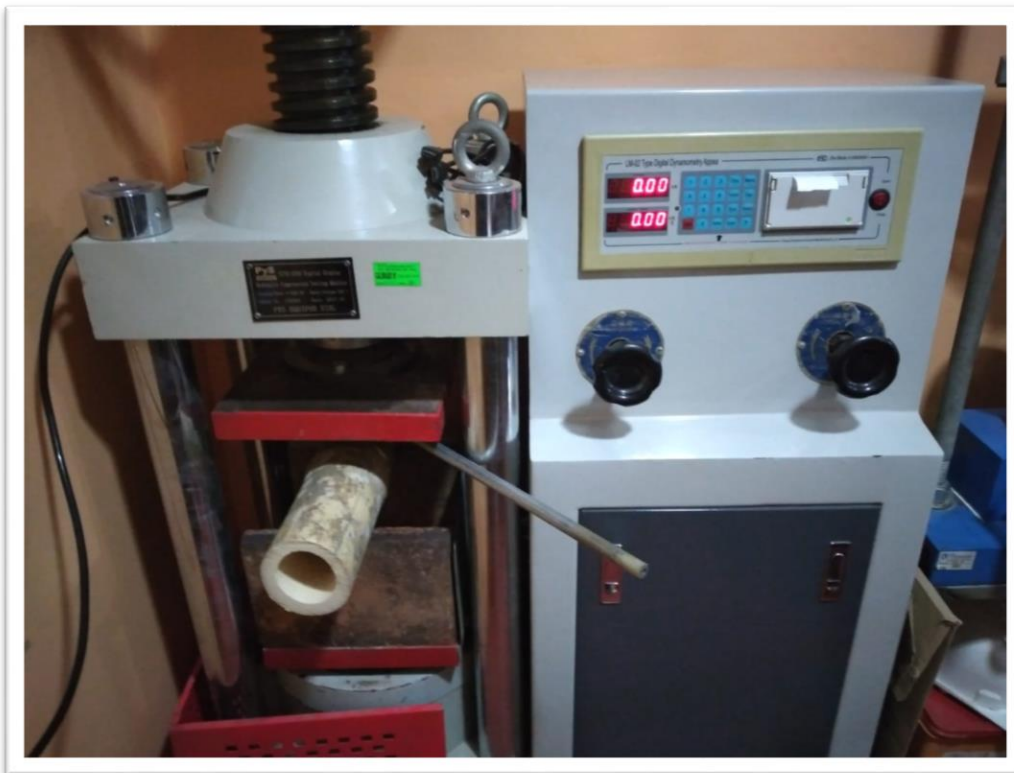
Ensayo de flexión del bambú.
