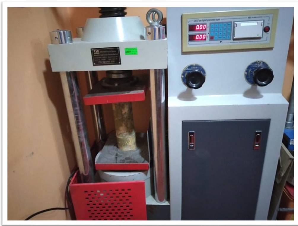
Resistencia del bambú a las fuerzas de compresión.
