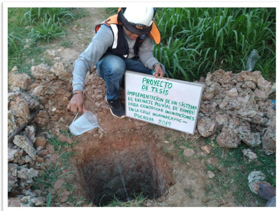
Prueba de infiltración de suelo.
