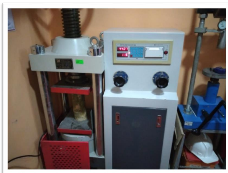
Figura 34. Ensayo de compresión del bambú
