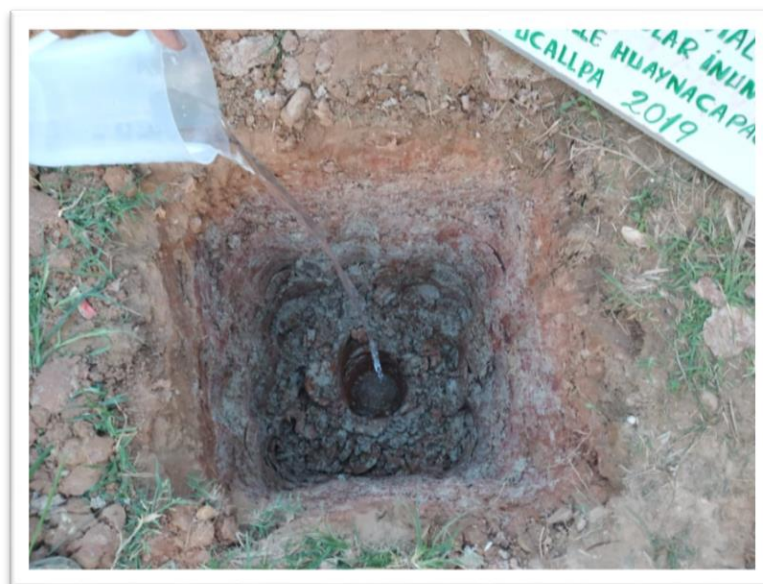
Figura 32. Prueba de infiltración del suelo in situ.
