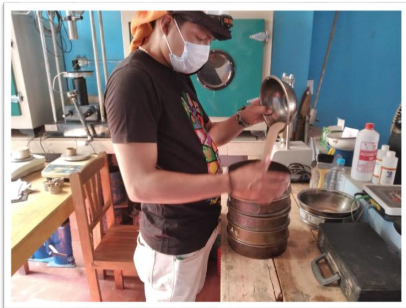
Figura 30. Ensayo de análisis granulométrico del suelo.
