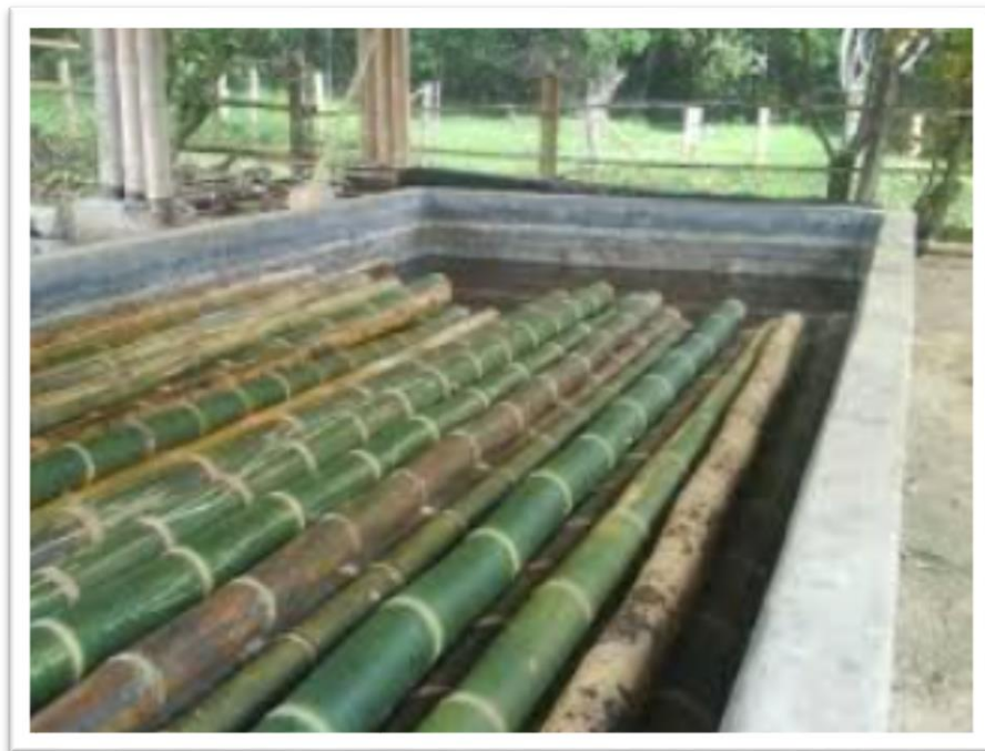
Figura 4. Curado del bambú por inmersión en agua.
