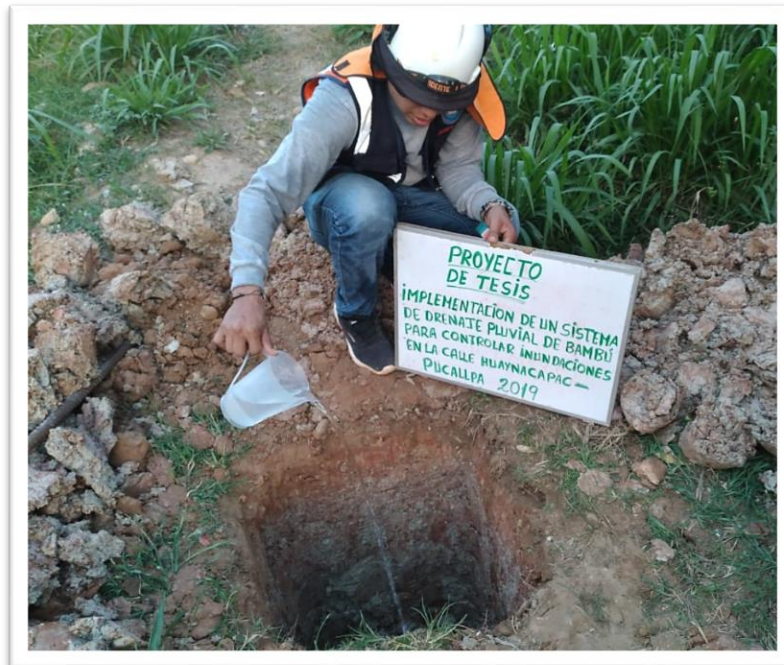
Figura 31. Prueba de infiltración del suelo in situ.
