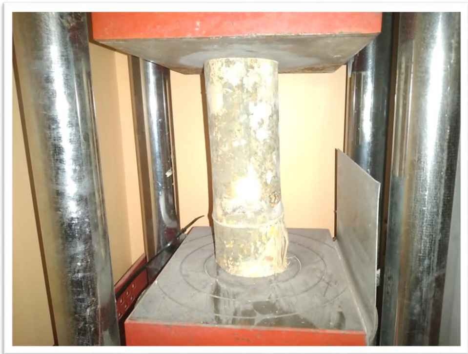
Ensayo de compresión a la muestra del bambú
