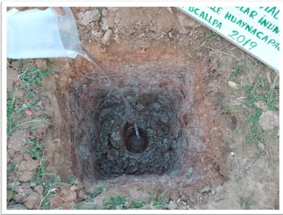
Infiltración de suelo método Porchet.
