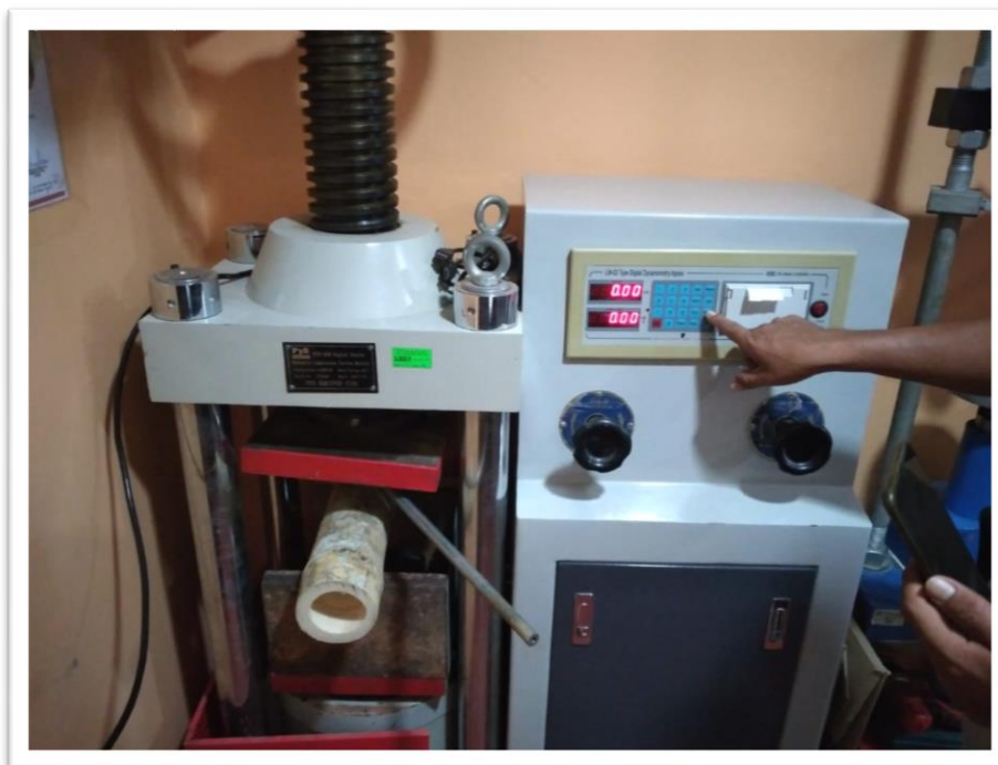
Figura 35. Bambú sometido a esfuerzos de flexión
