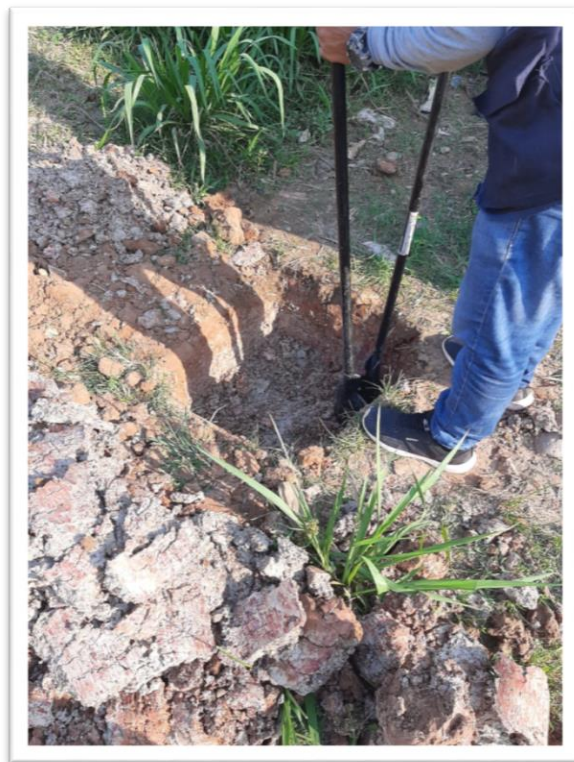
Excavación y extracción de la primera muestra del suelo.
