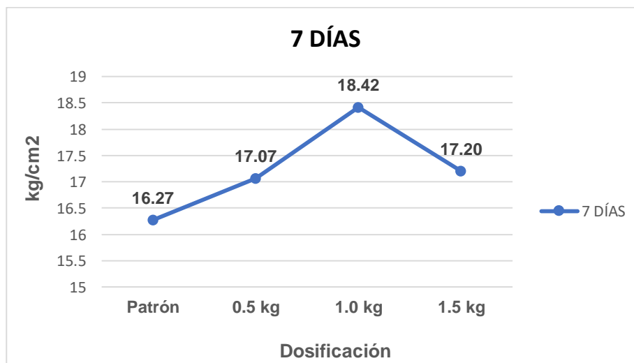
Figura 23- Gráfica de resistencia a la tracción a los 7 días
