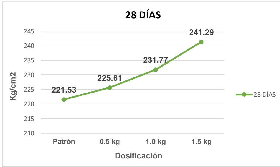
Figura 17- Gráfica de la resistencia a la compresión a los 28 días
