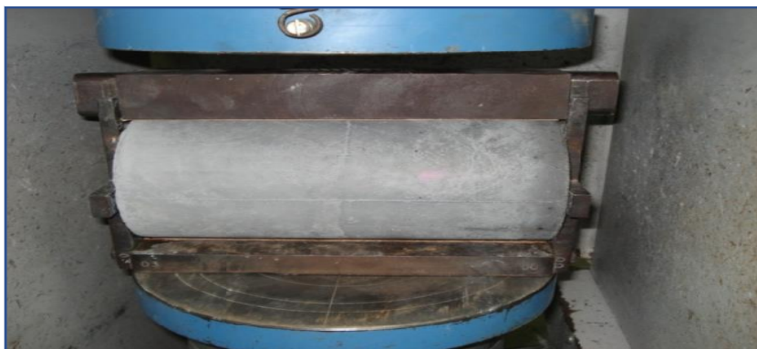
Figura 7- Ensayo de Tracción
