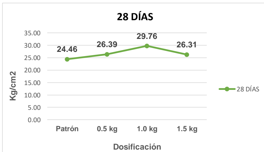
Figura 25- Gráfica de resistencia a la tracción a los 28 días
