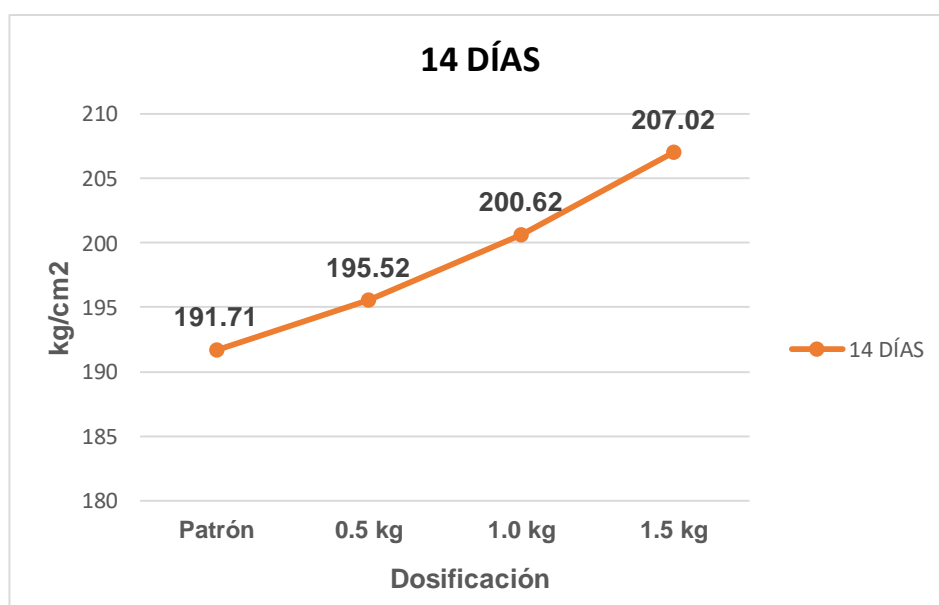
Figura 16- Gráfica de la resistencia a la compresión a los 14 días
