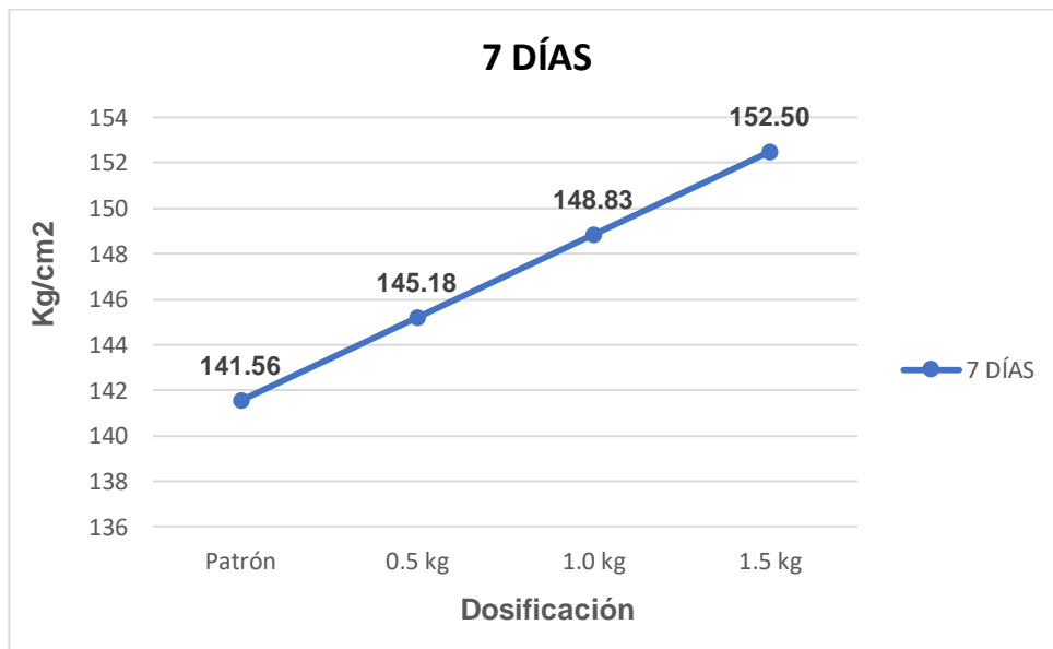
Figura 15- Gráfica de la resistencia a la compresión a los 7 días
