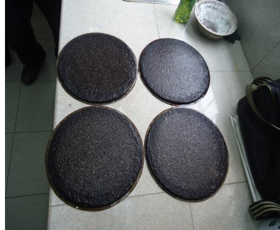
Moldeo para Rueda cargada y Abrasión en Húmedo
