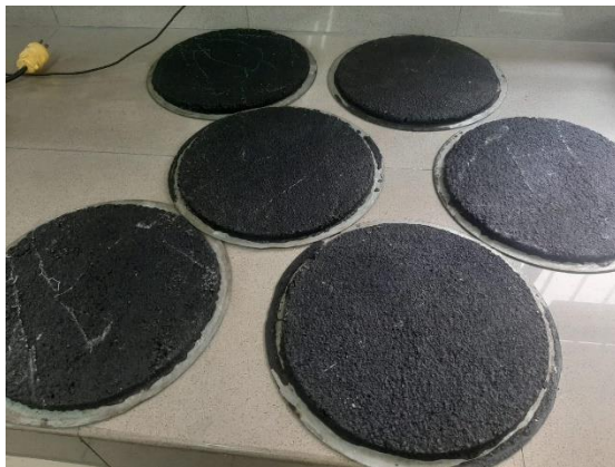
Desgaste de los moldes por Abrasion
