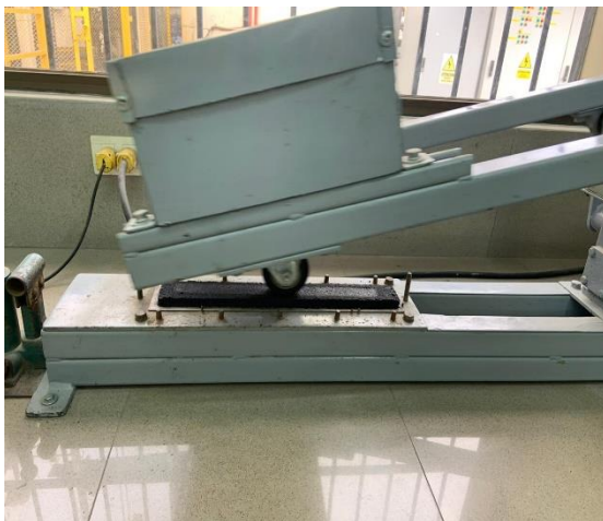
Ensayo de Rueda Cargada de los moldes
