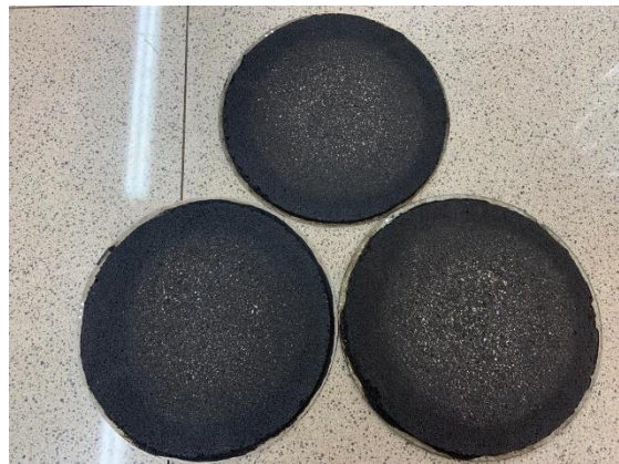
Desgaste de los moldes por Abrasion
