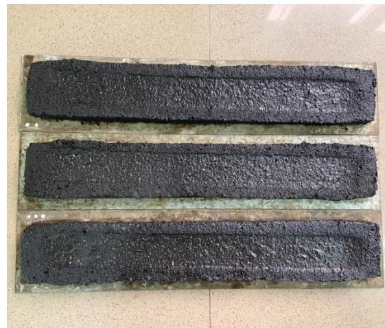
Ensayo de Rueda Cargada de los moldes
