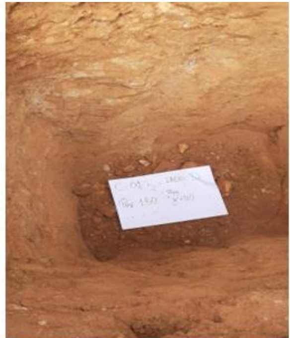
Foto Profundidad de las calicatas 1.5 m. Fuente: Elaboración propia.
