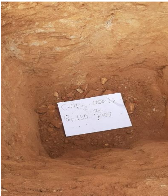
Figura 1: Foto de la ejecución de calicata.
