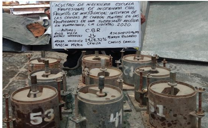
Figura 8. Foto de las probetas del ensayo CBR. Fuente: Elaboración propia.
