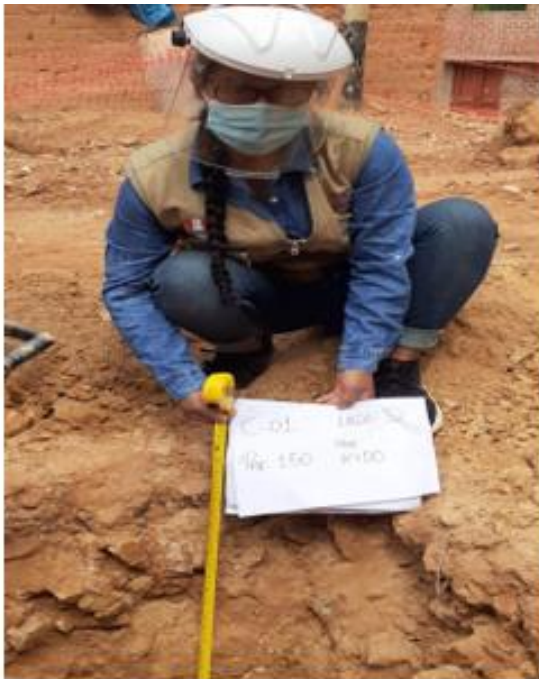
Foto de la ejecución calicata C1-M1. Fuente: Elaboración propia.
