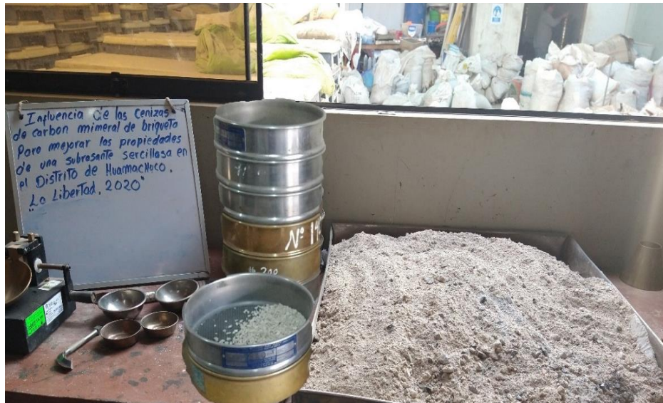
Figura 3. Foto del ensayo de Análisis granulométrico por tamizado. Fuente: Elaboración propia.
