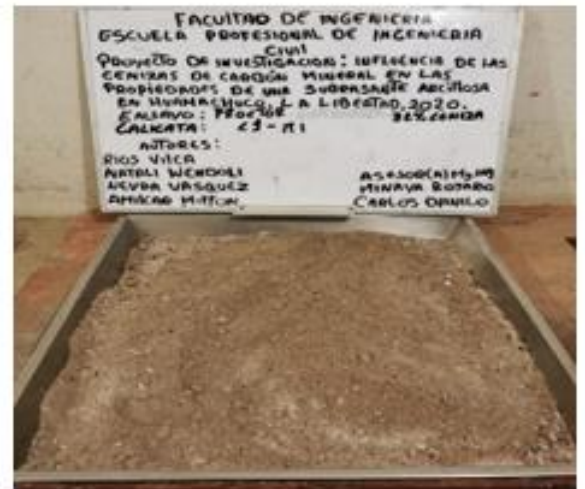
Foto de la Mezcla de muestra para Proctor Modificado.
