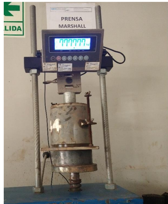
Figura 5. Foto de penetración de muestra. Fuente: Elaboración propia.
