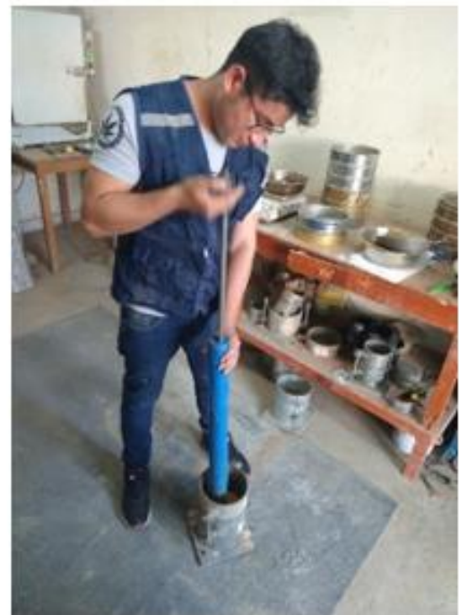
Foto del Ensayo Proctor Modificado muestra natural+24% de CCM.
