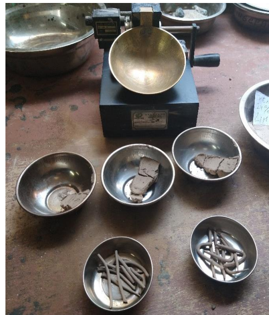
Figura 7. Foto de la determinación de IP y LP. Fuente: Elaboración propia.
