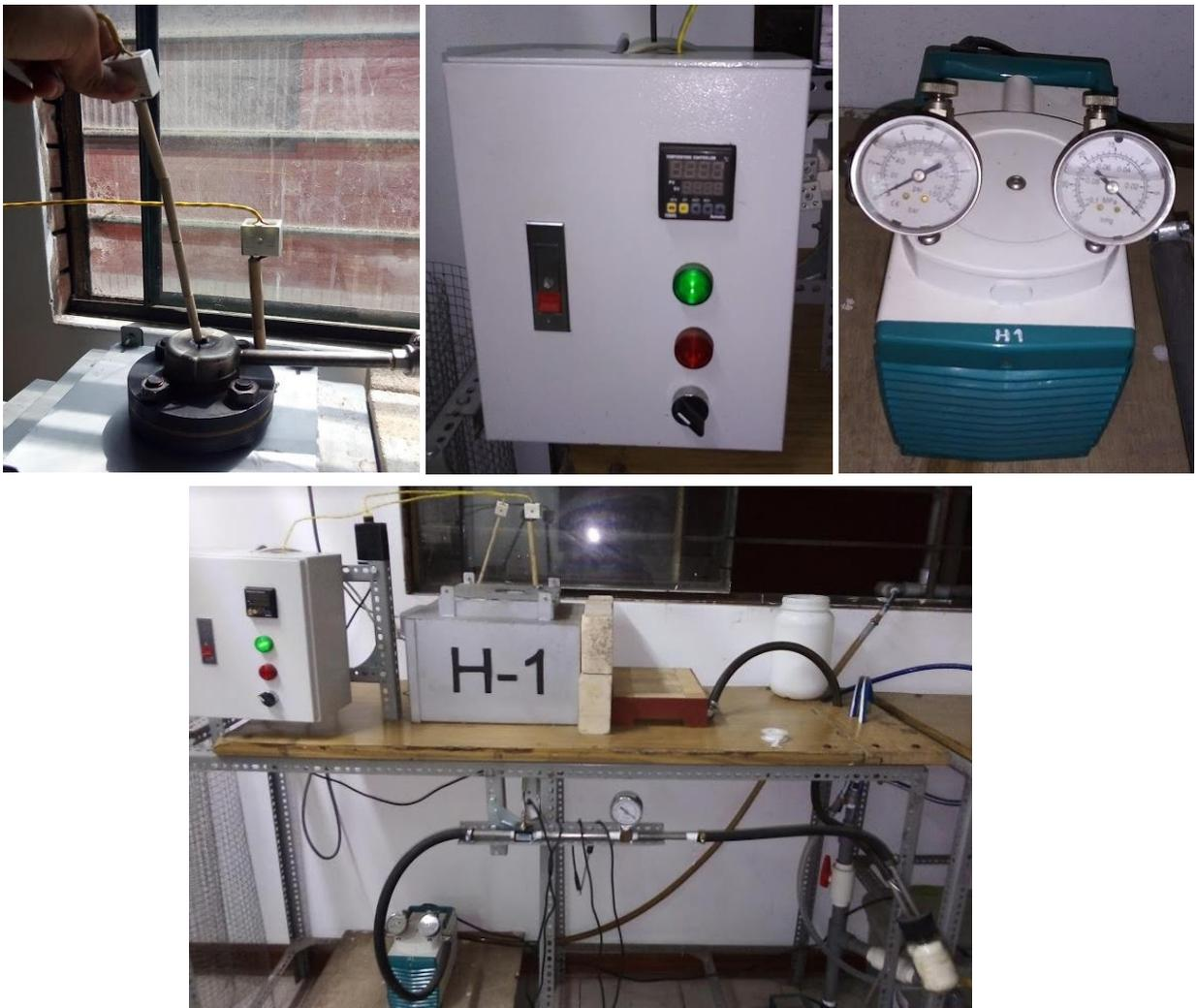
Figura 24. Equipo de pirólisis al vacío
