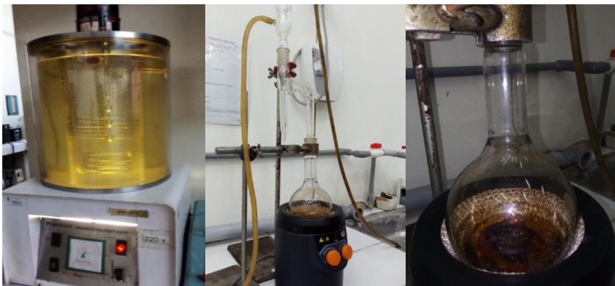
**Figura 27. Viscosímetro y equipo de agua por arrastre**
