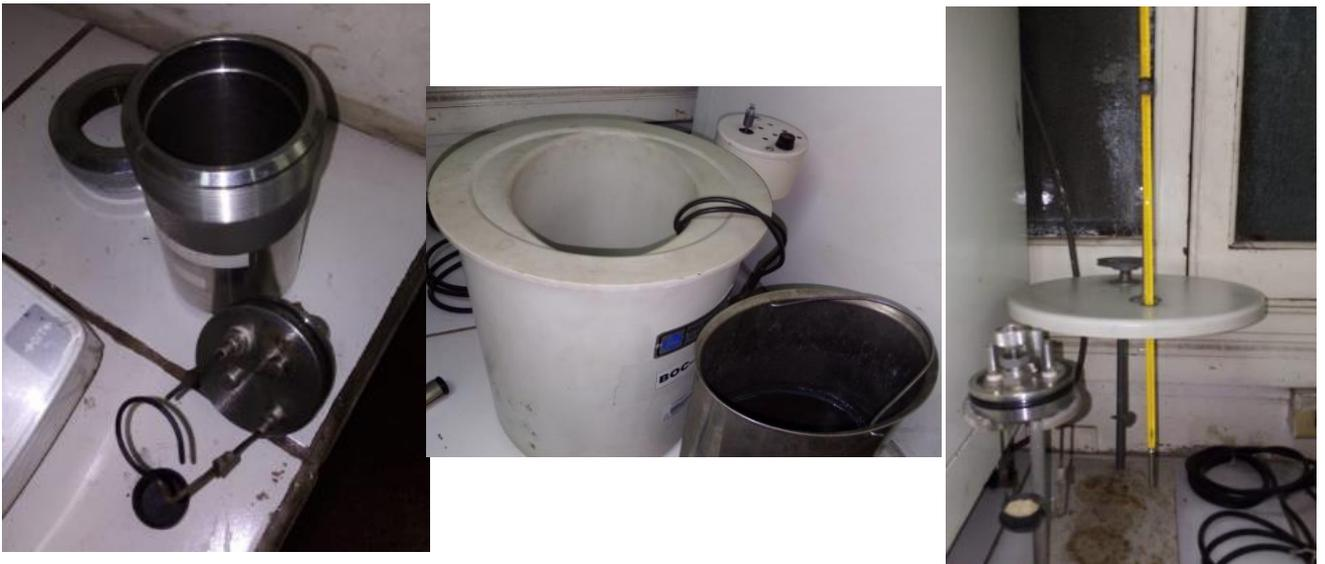
Figura 26. Bomba calorimétrica
