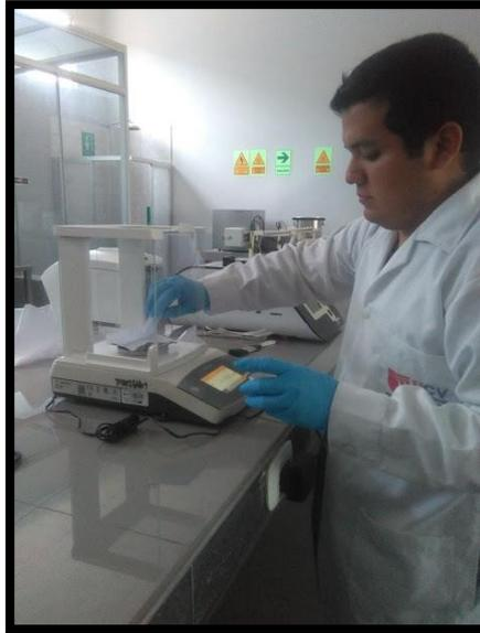
Pesado de sulfato de sodio anhidro ( $\text{Na}_2\text{SO}_4$ ).
