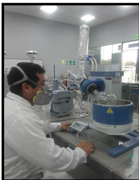
El extracto orgánico es colocado en el matraz de bola en el rotavaporador y esperar. Para su posterior pesado del envase que contiene el sobrenadante.
