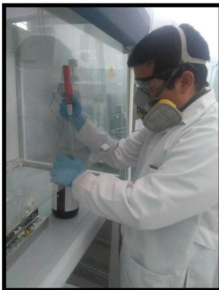
Absorción de diclorometano para agregarlo en el tubo que contiene la mezcla solido suelo seco +sulfato de sodio.
