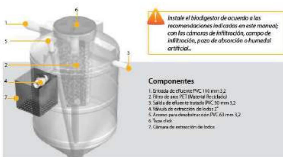
Figura 2. Componentes del Biodigestor (ROTOPLAS).
