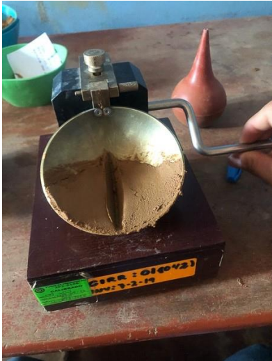
División creada con el acanalador en la cuchara de Casagrande
