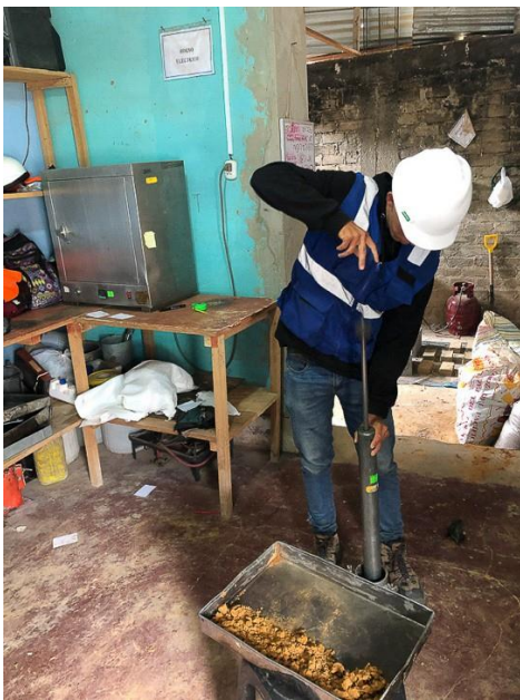
Uso del Martillo con el Molde y la Malla de 4"
