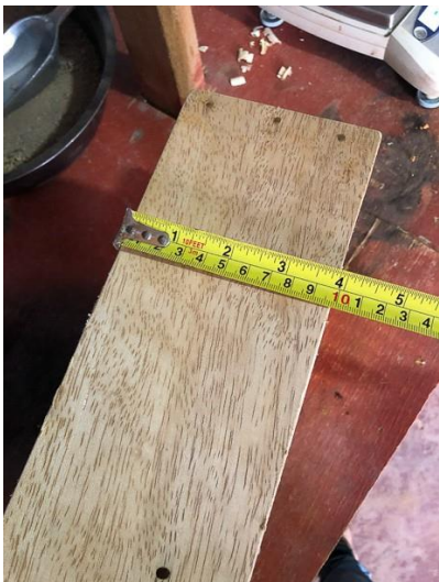
Verificación de las medidas en los moldes (10 cm)
