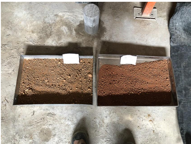
Materiales de diferentes canteras enfriándose despues del secado
