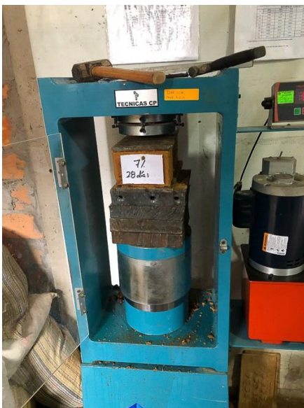
Bloque con 7% de adición de viruta de madera a los 28 días de secado
