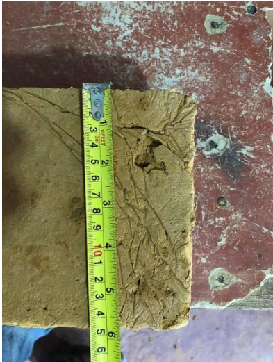
Medición de los bloques después de 28 días de secado en el ambiente
