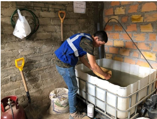
Colocación de los bloques en un recipiente con agua potable
