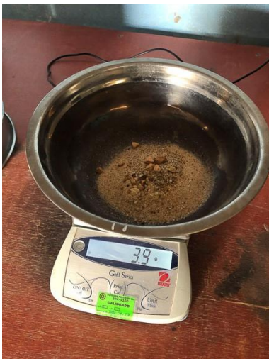
Peso total del material retenido en la malla 200
