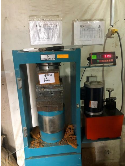
Bloque con 2.5% de adición de viruta de madera a los 14 días de secado
