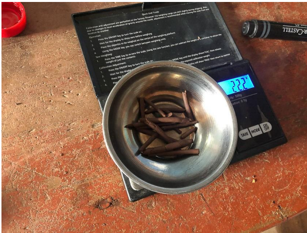
Pesaje de los las muestras alargadas de arcilla
