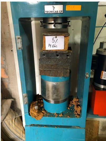
Bloque con 5% de adición de viruta de madera a los 14 días de secado
