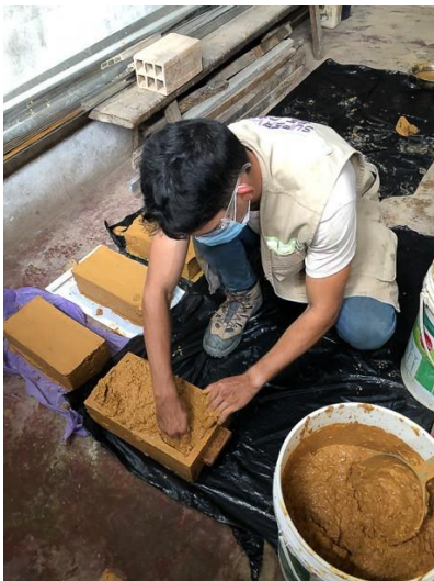
Elaboración de adobes con adición de viruta de madera
