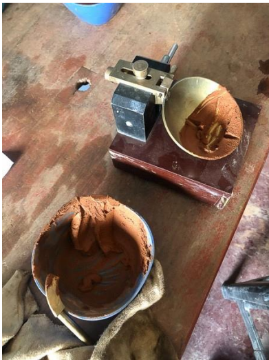
Extracción del material de la cuchara de Casagrande
