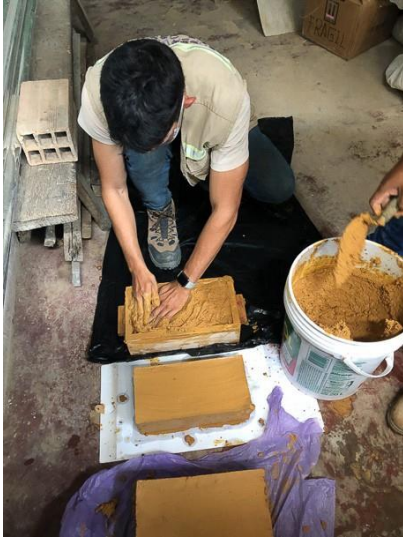
Se usó las manos para compactar el material
