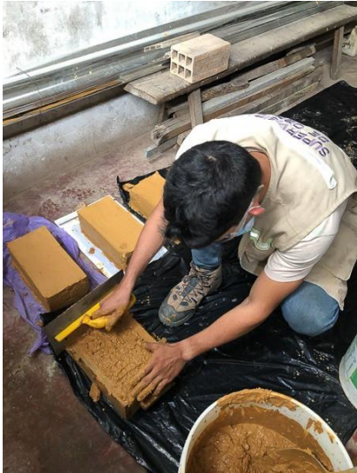
Uso de la espátula para dar forma a la parte superior de los bloques
