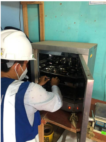
Colocación de los pesajes en el horno
