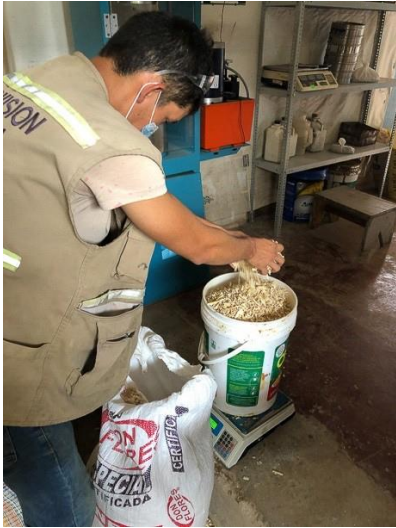
Pesaje de la viruta de madera
