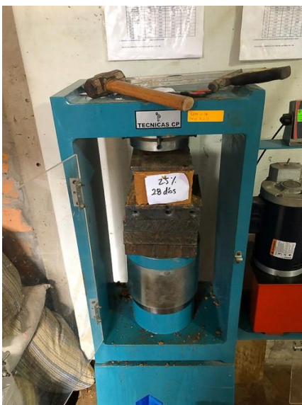
Bloque con 2.5% de adición de viruta de madera a los 28 días de secado
