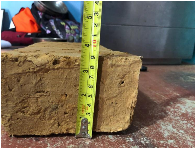
Medición de los bloques después de 28 días de secado en el ambiente
