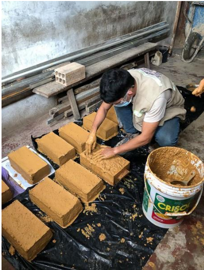
Elaboración de los bloques con adición de viruta de madera
