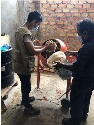
Colocación del aditivo en el trompo con la ayuda de un técnico de laboratorio
