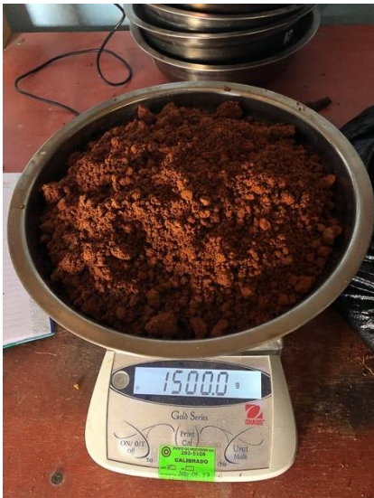
Muestra pesada en la balanza electronica para laboratorio
