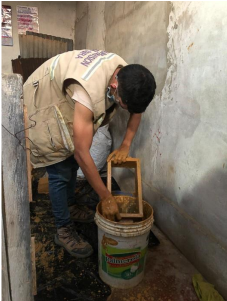
Uso del agua para lubricar las partes del molde de madera
