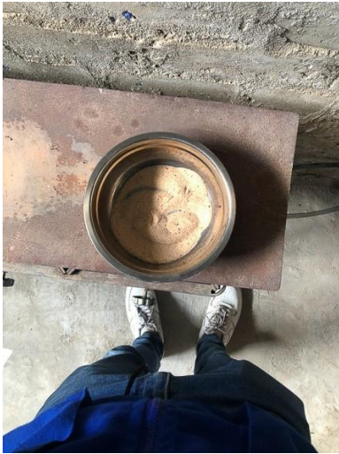
Secado del material en la estufa
