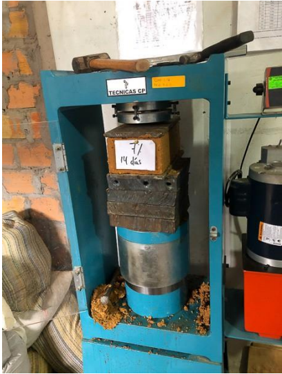
Bloque con 7% de adición de viruta de madera a los 14 días de secado
