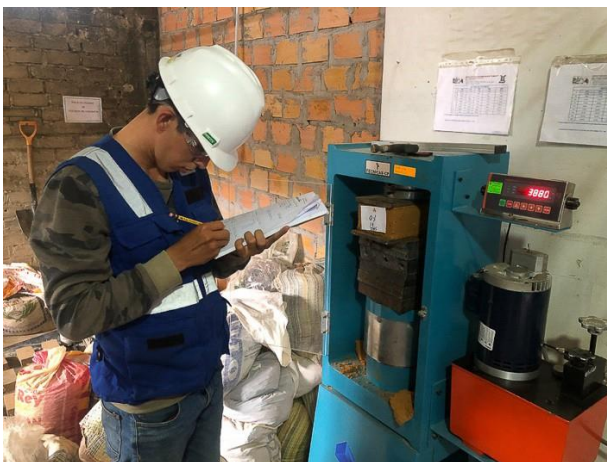
Tomando apuntes de los ensayos a compresión realizados a los 14 días
