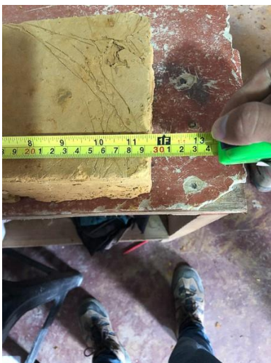
Medición de los bloques despues de 28 días de secado en el ambiente
