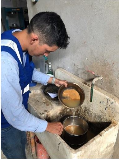
Lavado del material usando la malla N°200
