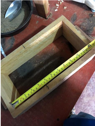
Verificación de las medidas en los moldes (30 cm)
