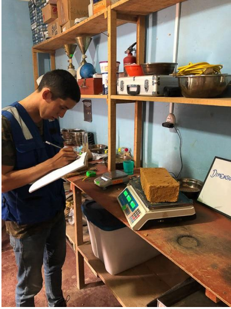
Tomando apuntes del peso del bloque secado a los 28 días
