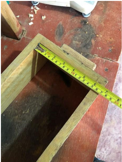
Verificación de las medidas en los moldes (15 cm)
