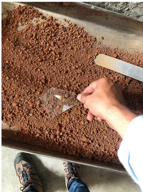
Uso de la pieza de vidrio para verificar el secado del material
