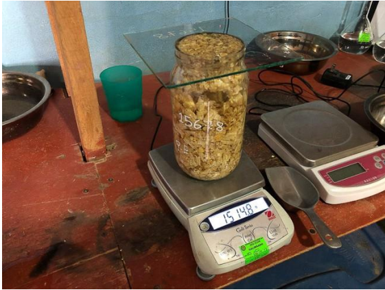
Pesaje del Recipiente con agua y la viruta de madera
