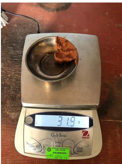
Pesado de material para ensayo
