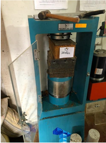
Bloque con 5% de adición de viruta de madera a los 28 días de secado
