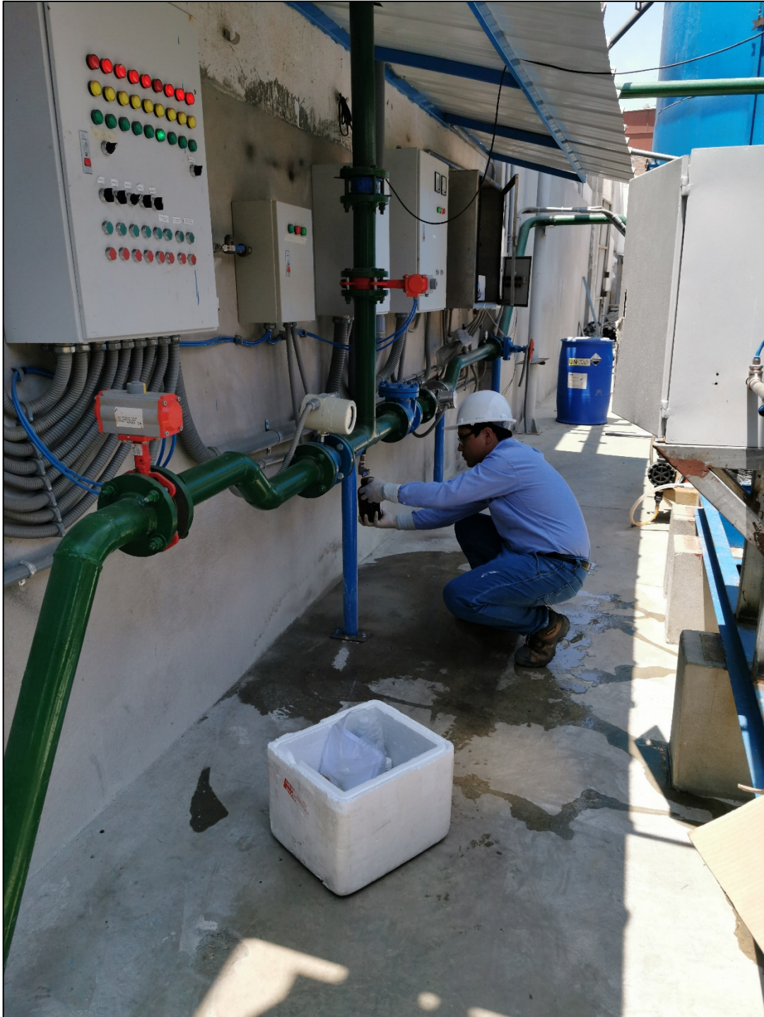
IMAGEN N° 01: Toma de muestra directa del efluente
