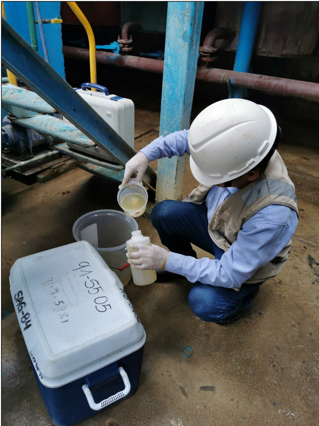
IMAGEN N° 03: Toma de muestra composita del efluente
