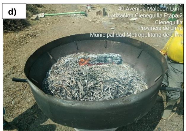
**Figura 12:** a) y b) Pesado de biomasa para Pirólisis. c) Momento en que la capa superior de biomasa se cubre con ceniza blanquecina, es el momento propicio para agregar la siguiente carga. d) Se deja como mínimo 10 cm debajo del borde superior del horno pirolítico para una buena carbonización de la biomasa.
