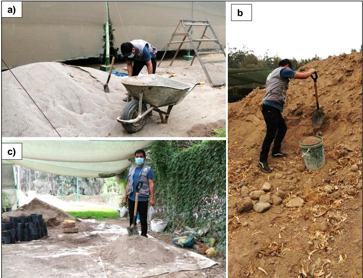
**Figura 18:** a) Arena del Río Lurín. b) Tierra de chacra de la zona. c) Mezcla homogénea de tierra más arena para sustrato de ensayo experimental.
