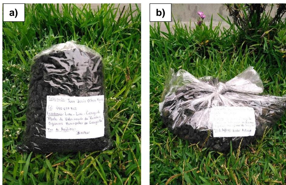
**Figura 15:** a) Muestra de biochar obtenido por pirólisis lenta. b) Muestra de biochar activado en pila de compostaje por 4 meses.
