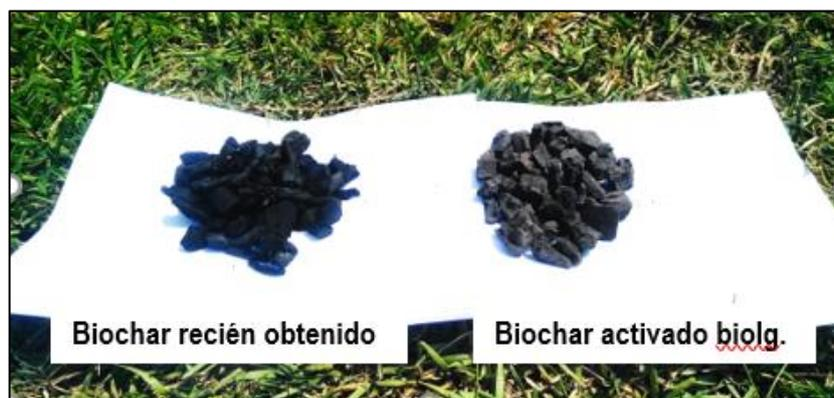
**Figura 27: Visibles diferencias físicas entre biochar recién obtenido y biochar activado biológicamente.**
