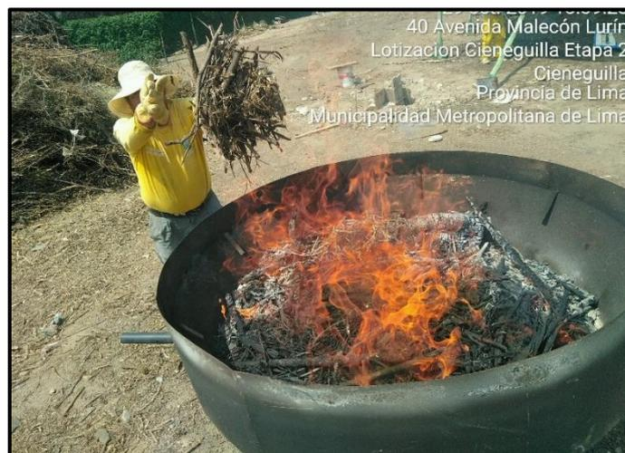
**Figura 9: Horno pirolítico con anillo protector a temperatura óptima de trabajo (650°C – 700°C).**
