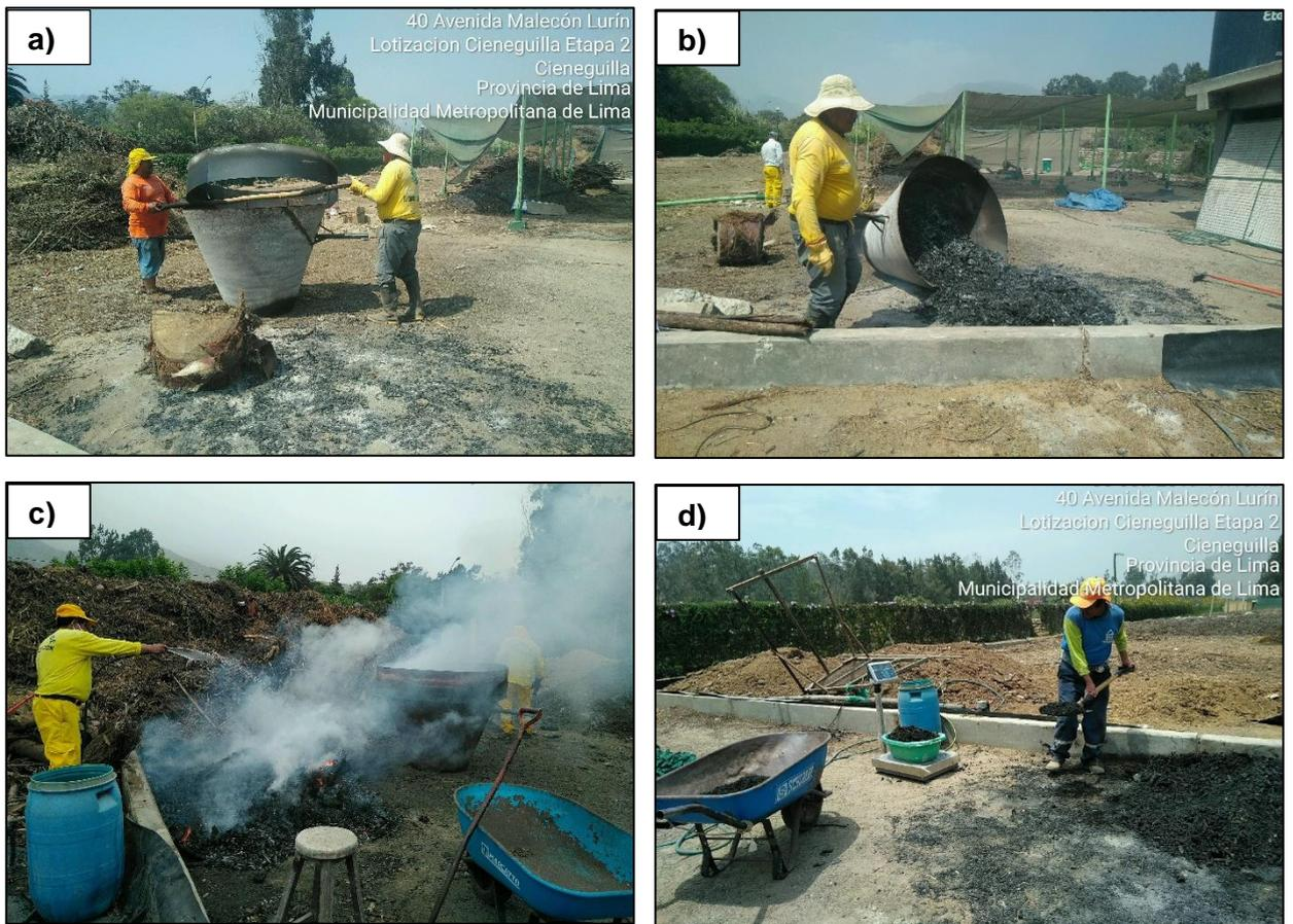
**Figura 13:** a) Retiro del anillo del horno. b) Volteo del horno para enfriar biochar. c) Enfriamiento de biochar. d) Biochar obtenido mediante la técnica de pirólisis lenta.
