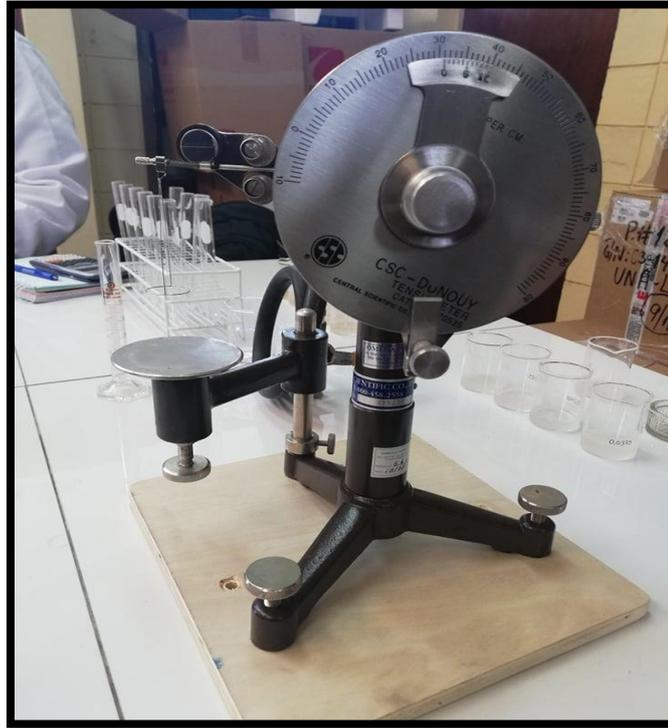
Figura 23. Tensiómetro CSC SCIENTIFIC CO., INC.
