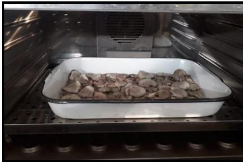
Figura 20. Proceso de estabilización en estufa de aire circulante a 46°C
