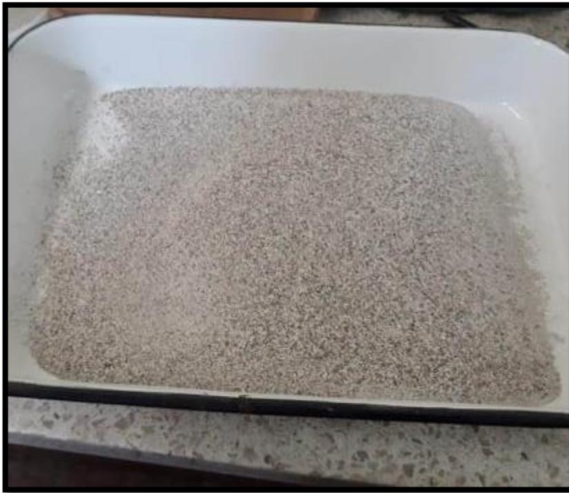
Figura 21. Homogenización del tamaño de partícula menor a 35 mesh
