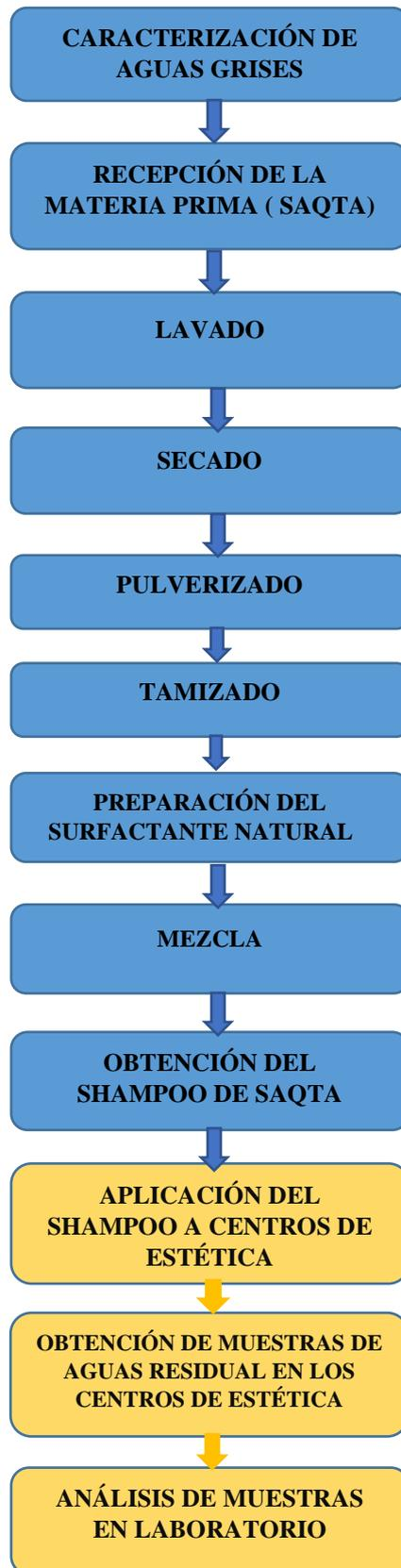
Figura 3. Diagrama de flujo del proceso de obtención del shampoo de Saqta
