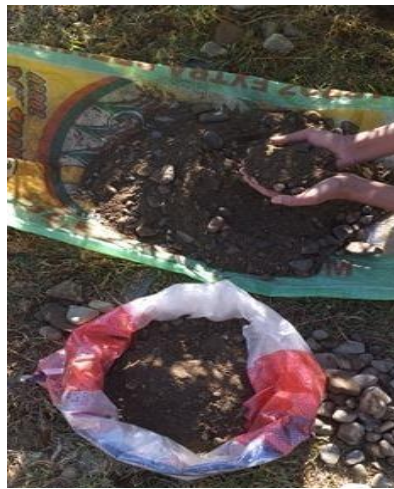
Figura 26. Extracción de 5kg de muestra inalterada.
