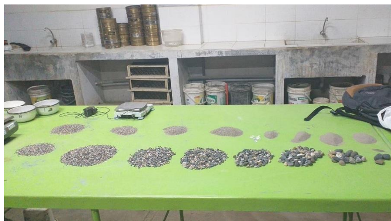
Figura 27. Resultado del análisis granulométrico con tamices.
