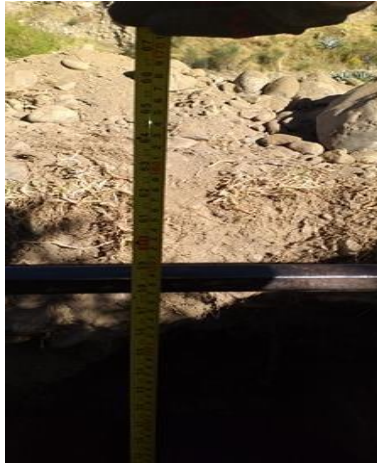
Figura 25. Calicata con profundidad de 1.50m.
