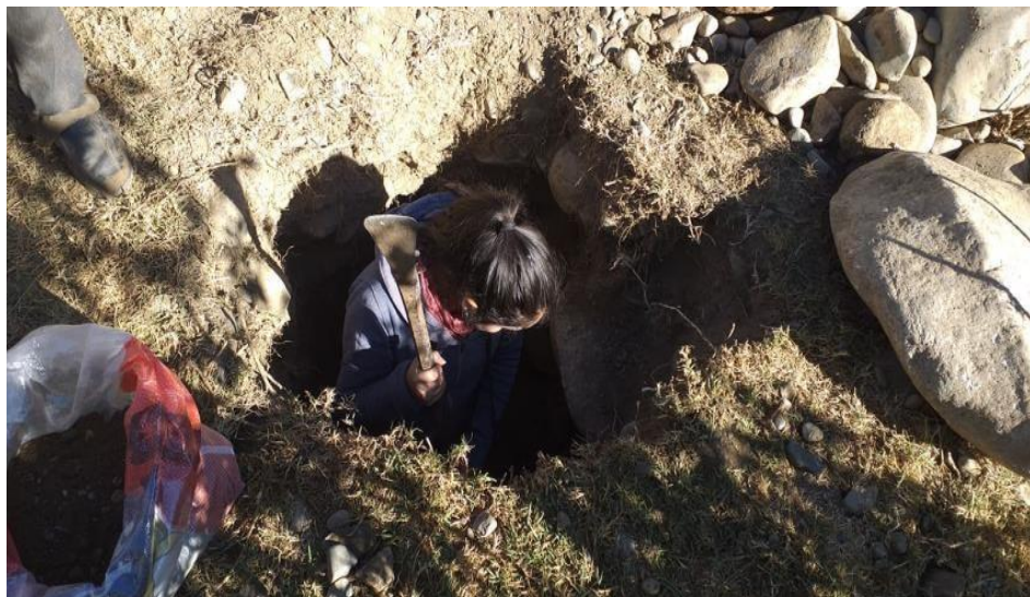
Figura 24. Excavación de la calicata
