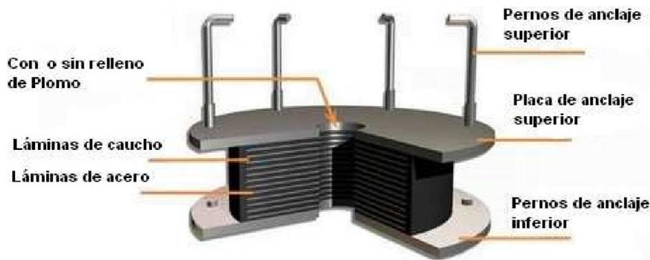
Figura 5:Detalle de un aislador elastomérico (fuente: Aguiar Falconí, Almazan Campillay, Dechent, & Suarez Chacon, 2008)
