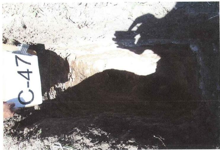
FOTO Nº 94: Vista interior de la calicata C-47, donde se muestra el perfil estratigráfico del suelo que alcanzó una profundidad de exploración de 2.20m. No fue posible continuar la excavación con equipos manuales debido al estado muy compacto a denso del suelo.
