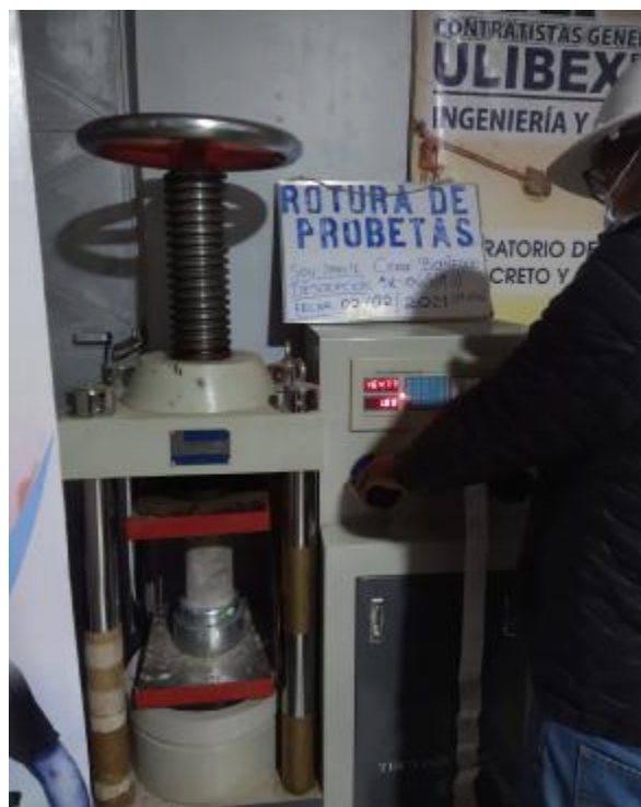
Fotografía 18: Ensayo a la compresión simple (NTP 339.034) del testigo de 4" x 8" en estado endurecido.
