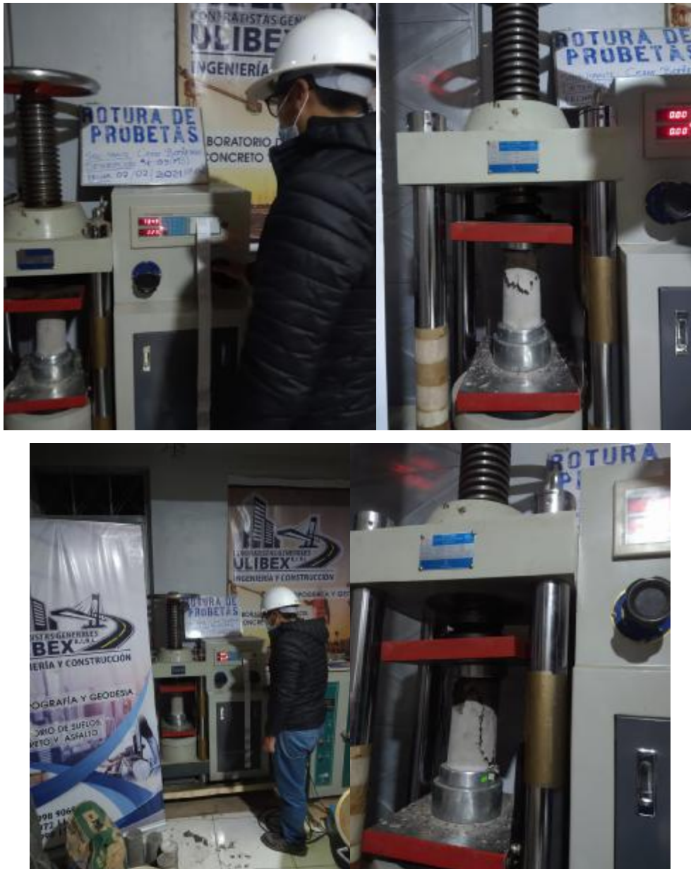
Fotografía 17: Ensayo a la compresión simple (NTP 339.034) del testigo de 4" x 8" en estado endurecido.
