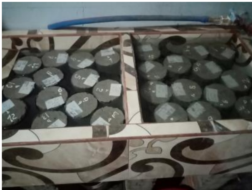
Fotografía 14: Curado de testigos de 4" x 8".
