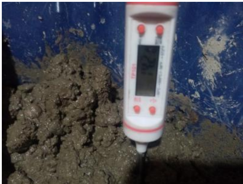
Fotografía 11: Ensayo para determinar la temperatura concreto.
