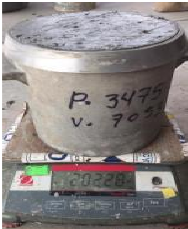
Fotografía 9: Ensayo para determinar el peso unitario del concreto.
