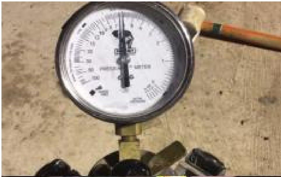
Fotografía 10: Ensayo para determinar el contenido de aire incorporado en el concreto.
