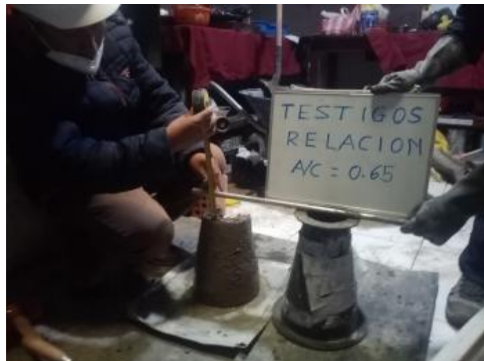
Fotografía 8: Ensayo para determinar el asentamiento del concreto.
