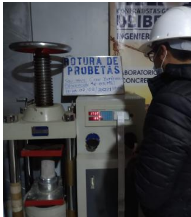
Fotografía 16: Ensayo a la compresión simple (NTP 339.034) del testigo de 4" x 8" en estado endurecido.
