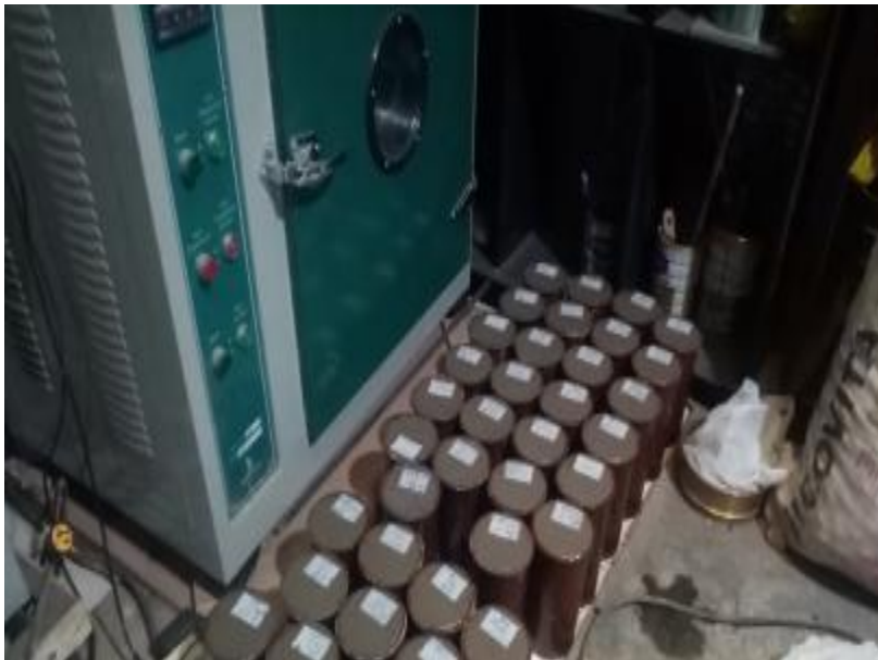
Fotografía 13: Elaboración de testigos de 4" x 8".
