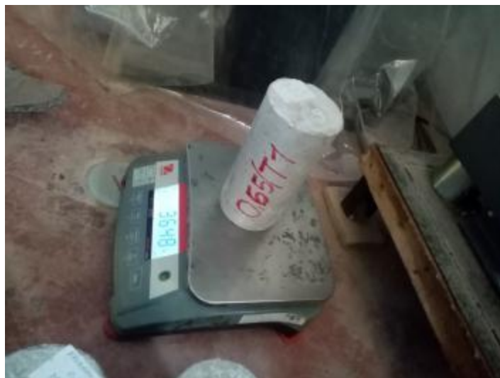
Fotografía 15: Peso del testigo de 4" x 8" en estado endurecido.
