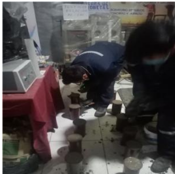
Fotografía 12: Elaboración de testigos de 4" x 8".
