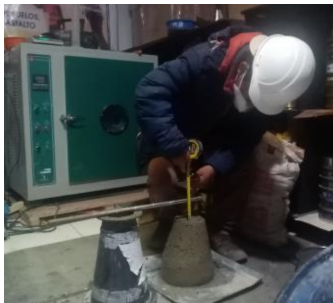
Fotografía 7: Ensayo para determinar el asentamiento del concreto.
