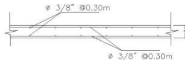
DETALLE TÍPICO DE LOSA MACIZA E=15CM ESCALA: 1/10
