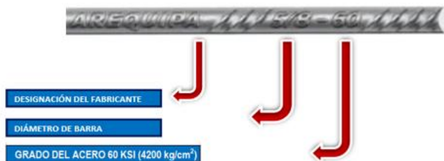
Figura 4: Representación del acero corrugado de grado 60Ksi (4200kg/cm 2 ).
