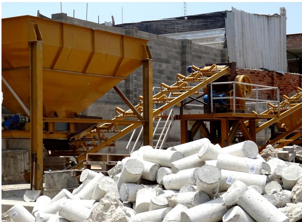
**Figura 13. Dosificación de agregados reciclados para elaboración de bloques**
