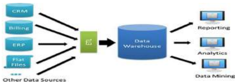
Fig. Nro. 7: Arquitectura de Data Warehouse.
