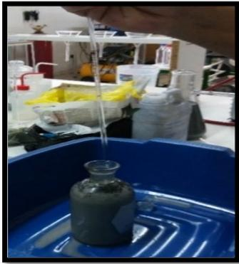
Figura 46: Colocación de la muestra en el vaso winkler.
