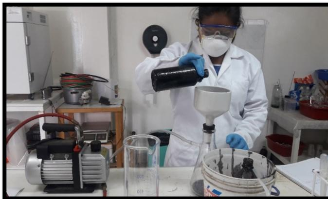
Figura 42: Filtración de la muestra en el matraz Erlenmeyer.
