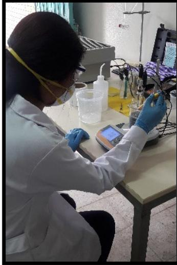
*Figura 35: Medición del potencial rédox.*
