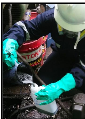
*Figura 8: Toma de muestra del agua residual industrial.*
