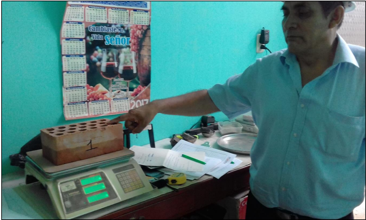
Figura 19. Peso del ladrillo Greq después de ser sumergida al agua fría.
