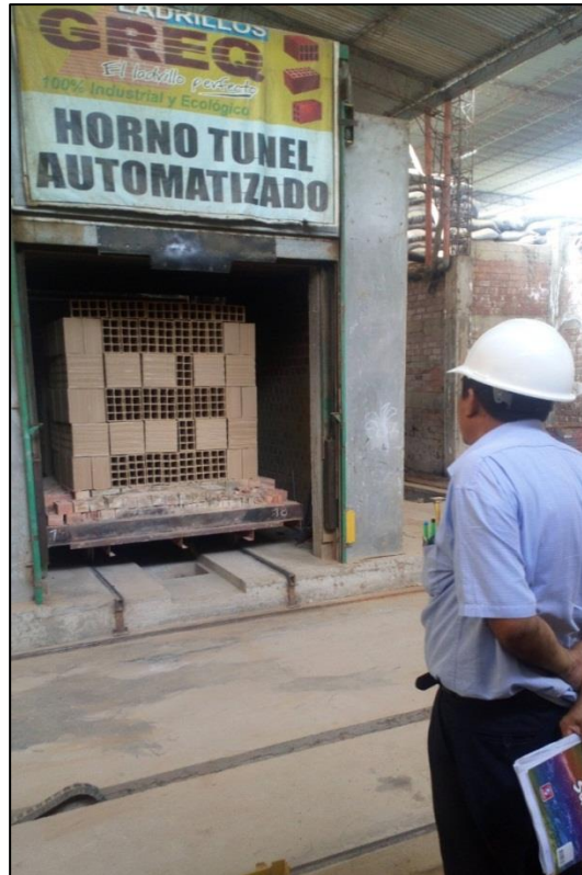
Figura 9. Proceso de cocción de las unidades de albañilería.
