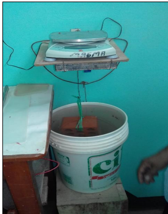
Figura 16. Peso sumergido de las unidades de albañilería.
