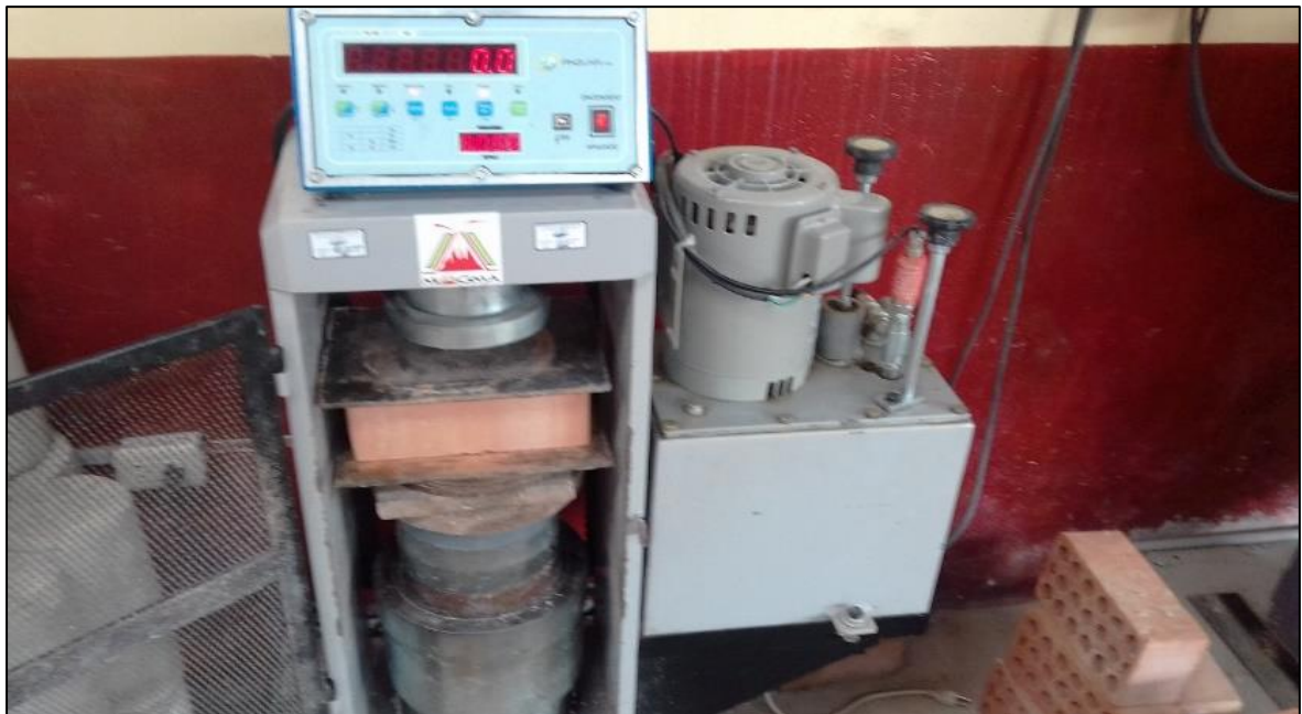
Figura 12. Ensayo de resistencia a la compresión del Ladrillo Greq.
