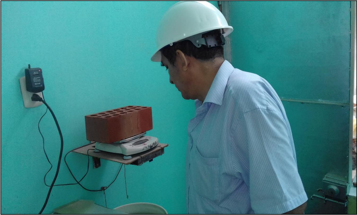
Figura 15. Cálculo del peso específico de las unidades de albañilería.
