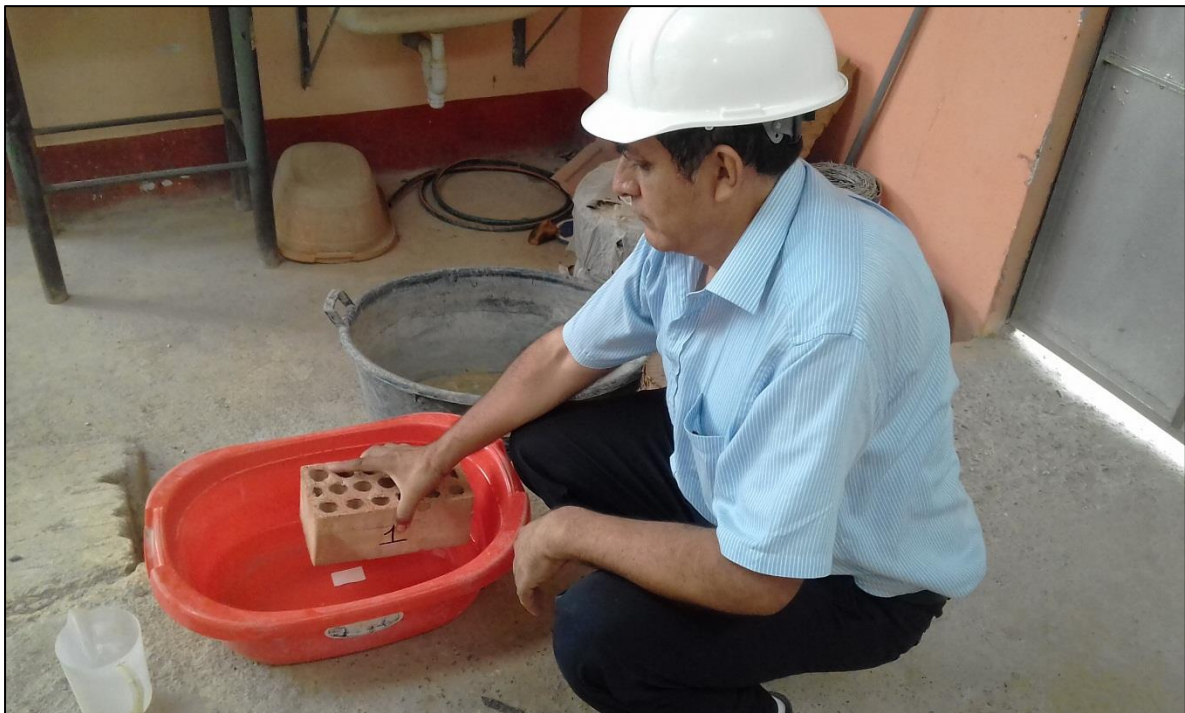
Figura 18. Ensayo de succión de los ladrillos Greq.
