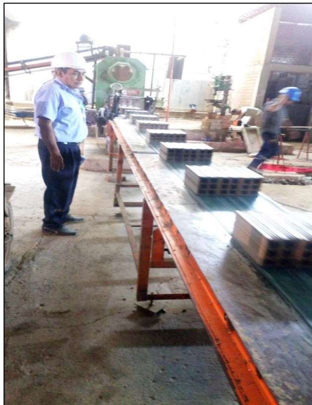
Figura 05. Extrucción del ladrillo prensado.
