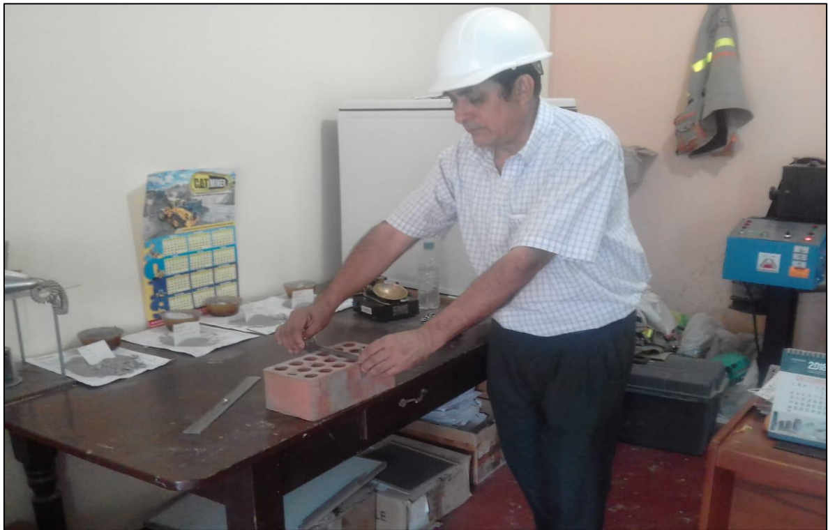
Figura 20. Realizando medición con vernier.
