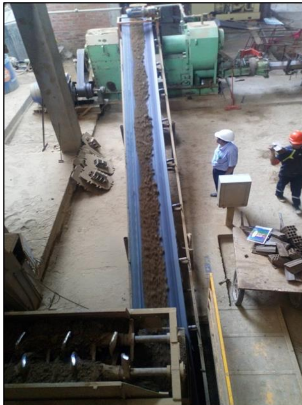
Figura 04. Amasado o Mezclado.
