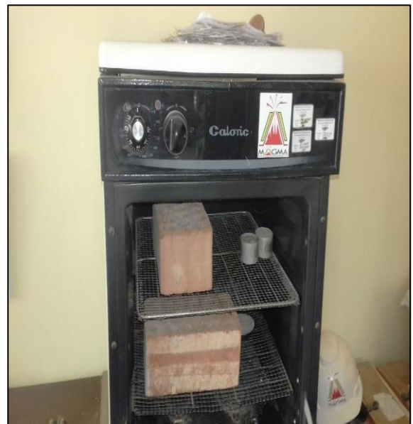
Figura 14. Secado de las unidades de albañilería en el horno 24 horas.
