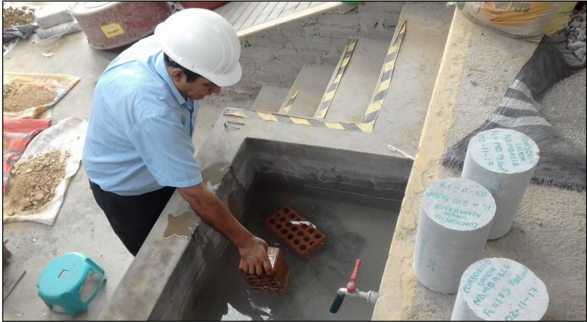
Figura 13. Colocación de los Ladrillos Greq en agua fría 24 horas - Ensayo de absorción.
