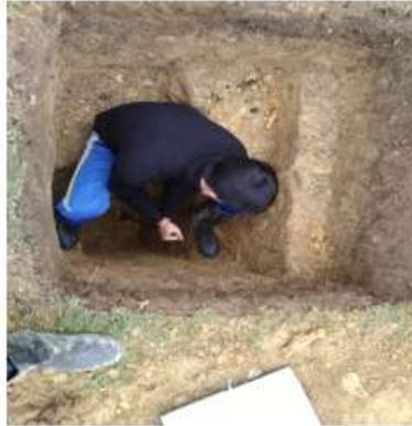
Foto 14. Calicata de obtención de datos del tes de percolación
