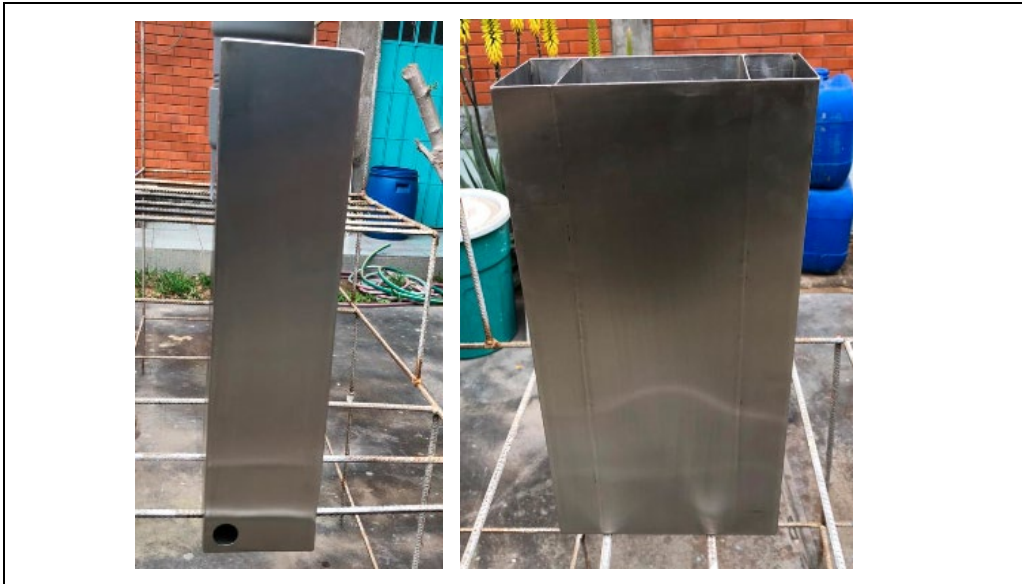
Imagen lateral y frontal del tanque de oxidación
