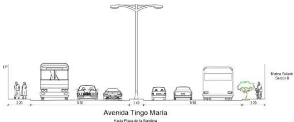
Figura 24. Sección vial Avenida Tingo María. Elaboración propia
