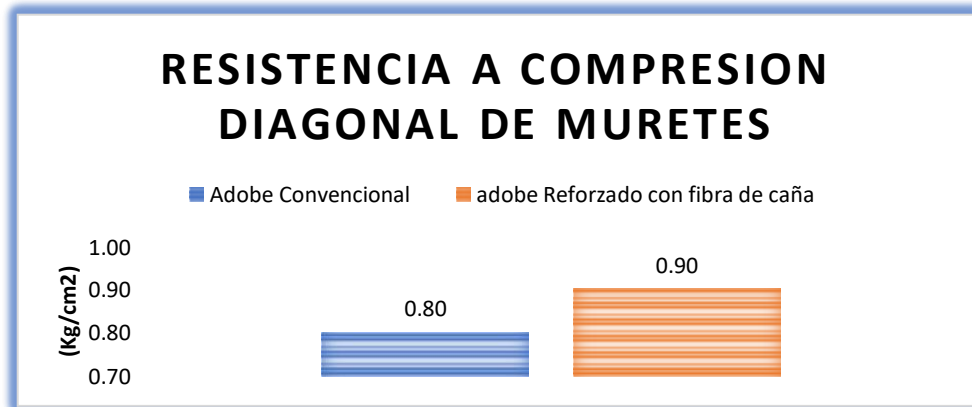
Gráfico 3 Resistencia a compresión diagonal de muretes de adobe reforzado con fibra de caña y el adobe convencional
