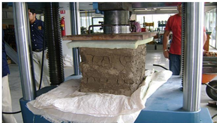
Figura N° 4 Prueba de compresión del adobe de barro
