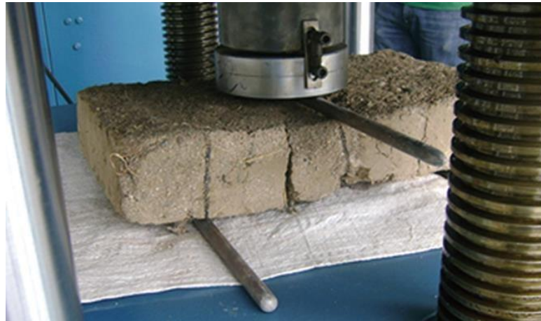
Figura N° 6 Prueba de Flexión del adobe de barro
