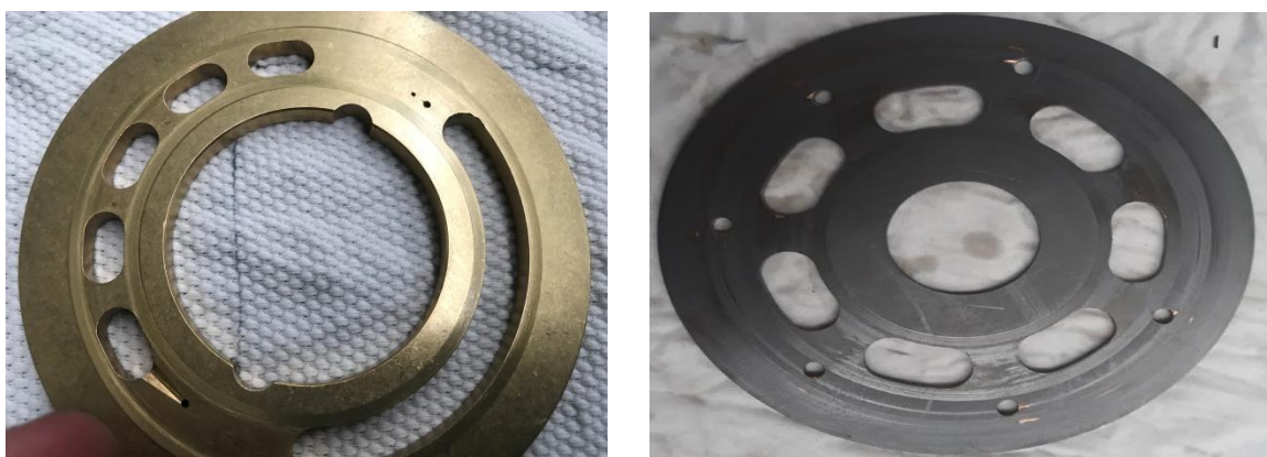
Figura 7: Muestras de piezas con deficiente control de limpieza de aceite.
