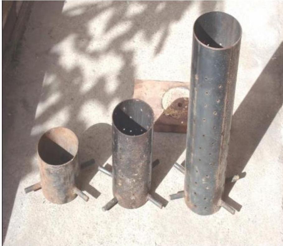
Figura 05. Moldes de Briquetas de diferente tamaño usados para los ensayos de compactación.
