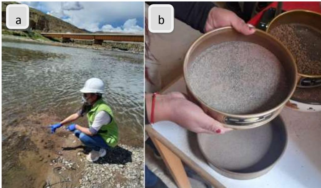
Figura 5. Muestreo de arena en el río Unucolla (a) y tamizando la arena (b)
