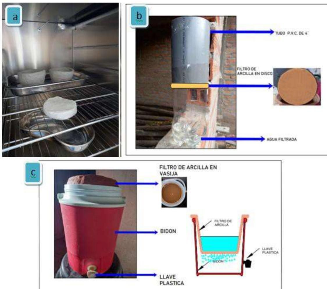
Figura 9. Calcinación de filtro en vasija y disco (a), filtro en disco (b) y filtro en vasija (c)
