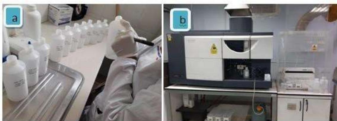
**Figura 12. Frascos para recolección de muestras (a) y Equipo ICP – MS (b)**
