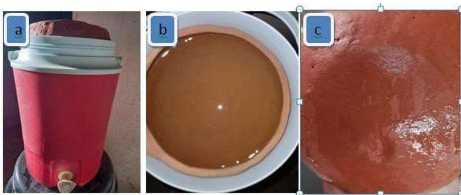
Figura 11. Proceso de filtración (a y b) y parte externa del filtro (c)
