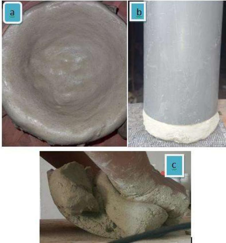
*Figura 7. Filtro en forma de vasija (a), filtro en forma de disco acoplado a un tubo de 4" y masa de para la elaboración del filtro (c)*
