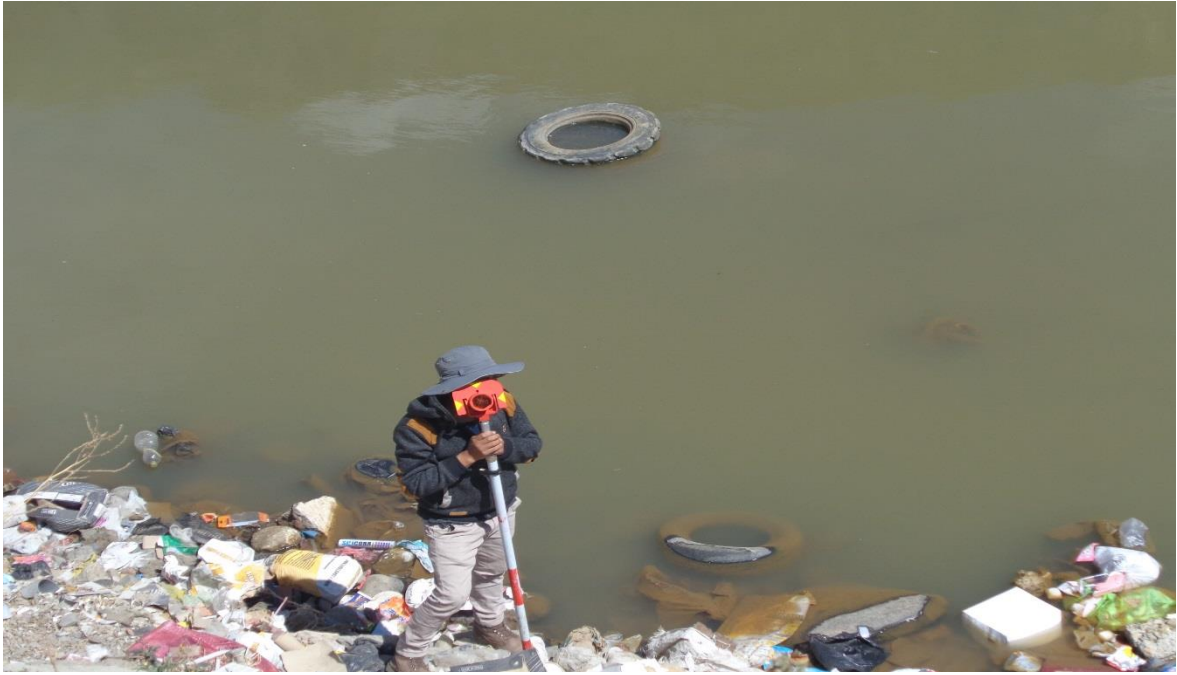
Fotografía 05: Toma de puntos topográficos en el borde del río.
