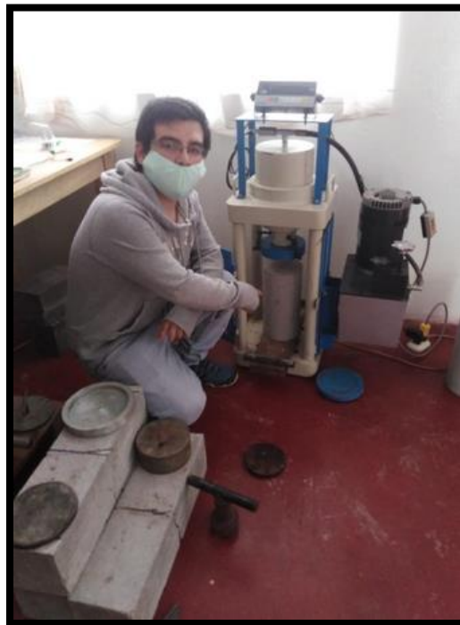
Imagen03: Ensayo de ruptura de probetas a la compresión
