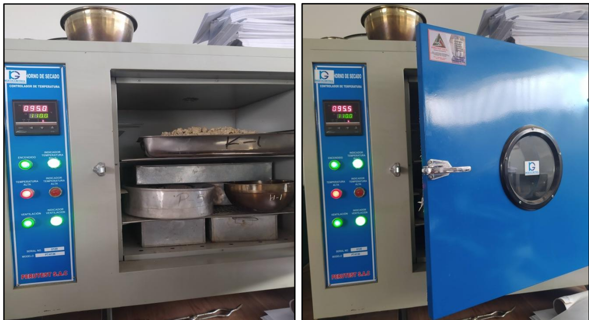
Figura 16. Colocado de muestras de lodo de papel en el horno
