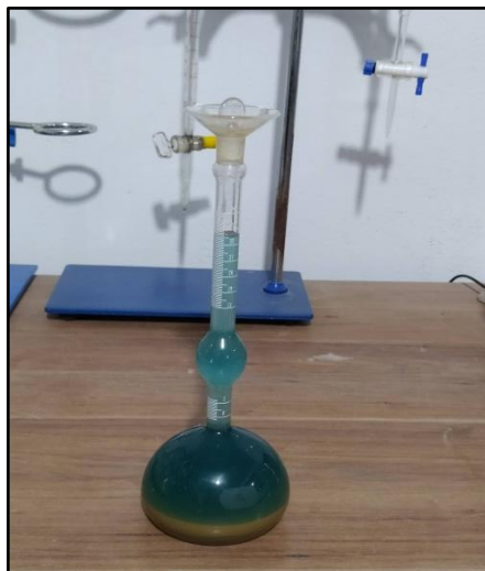
Figura 36. Peso específico de esquisto calcinado
