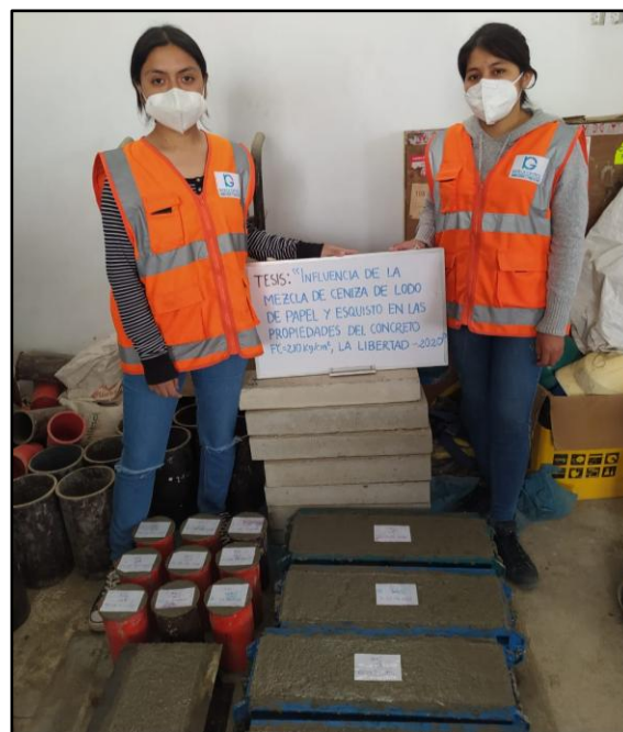
Figura 49. Elaboración de probetas cilíndricas y vigas
