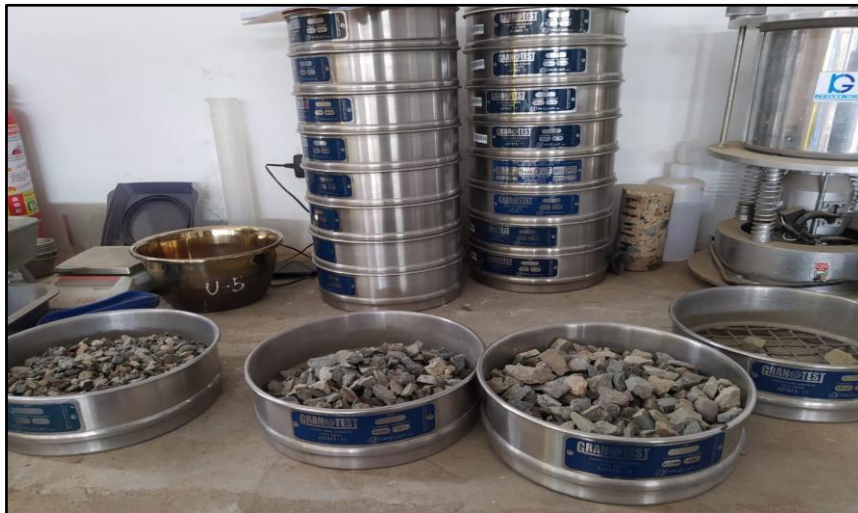
Figura 27. Agregado grueso retenido en los tamices
