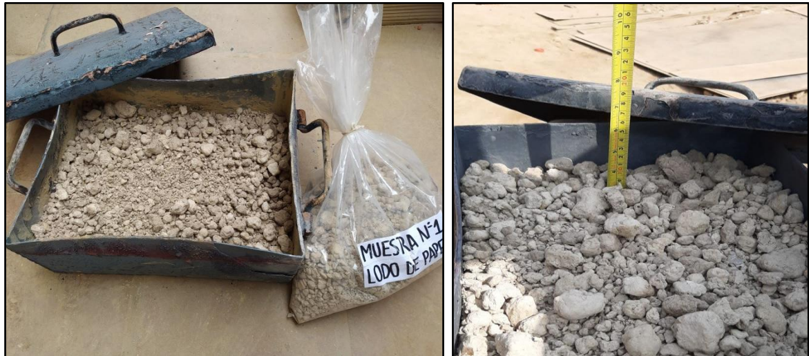
Figura 17. Molde de acero con la muestra de lodo de papel
