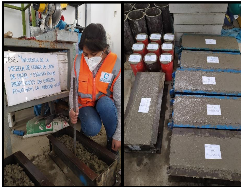
Fotografía 8. Llenado, compactado de probetas cilíndricas y vigas.
