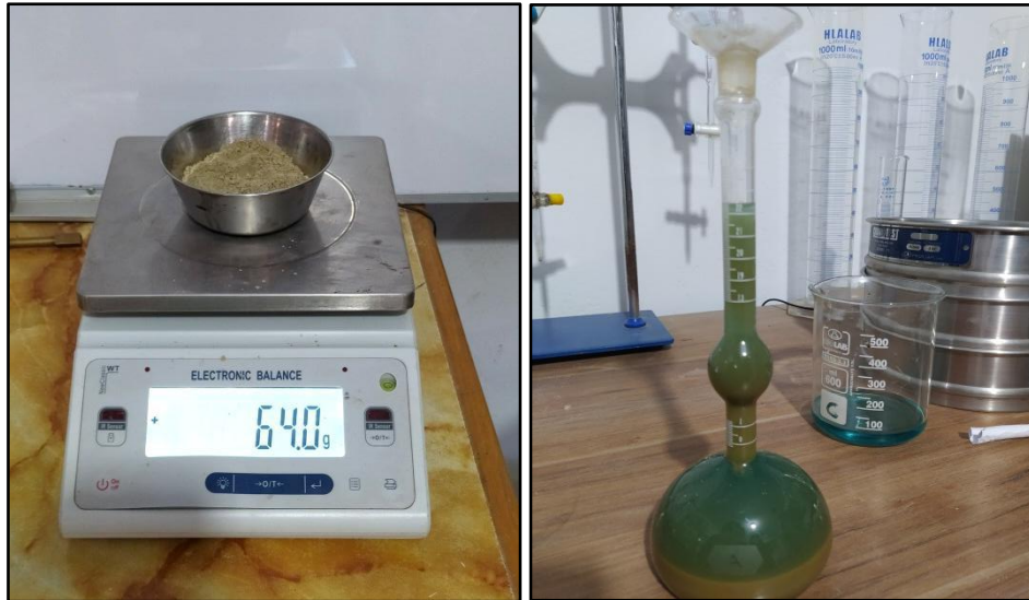
Figura 35. Llenado de esquisto calcinado en el “Le Chatelier”
