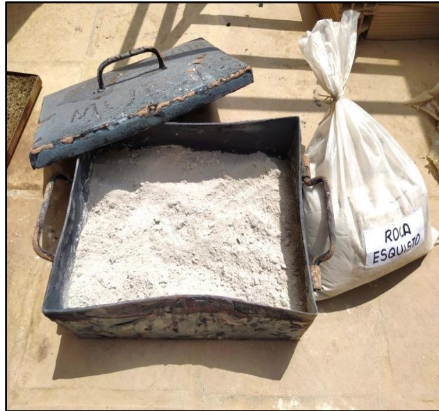
Figura 19. Molde de acero con la roca esquisto pulverizada
