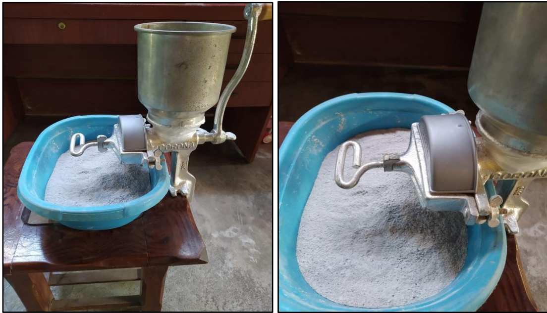
Figura 17. Molienda manual del lodo de papel calcinado
