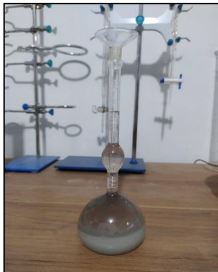
Figura 34. Peso específico de ceniza de lodo de papel
