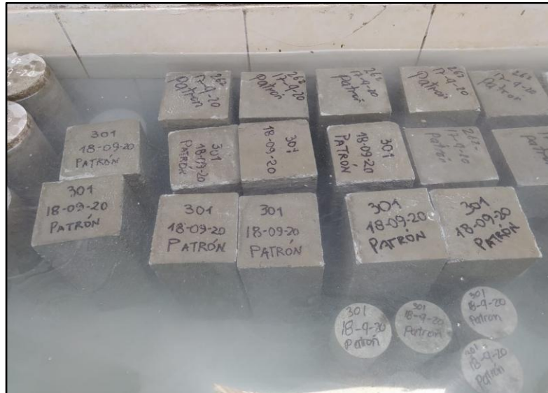
Figura 50. Curado de probetas cilíndricas y vigas
