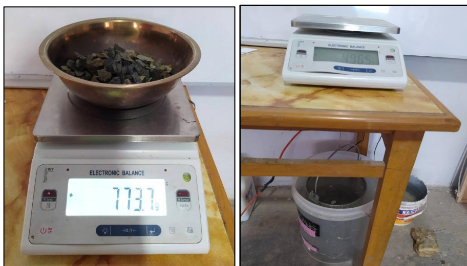
Figura 32. Muestra de agregado saturada y sumergida
