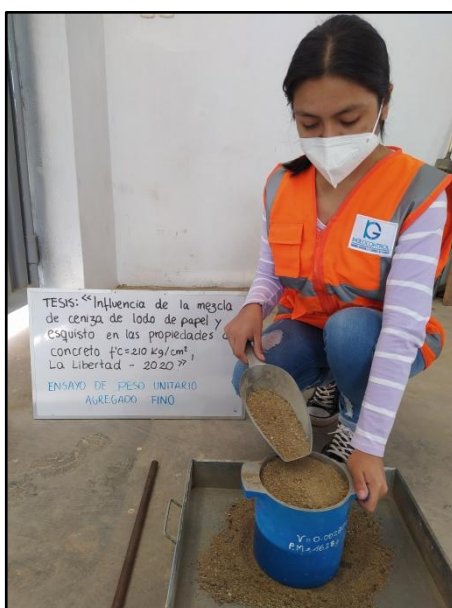
Figura 28. Llenado del molde con agregado fino
