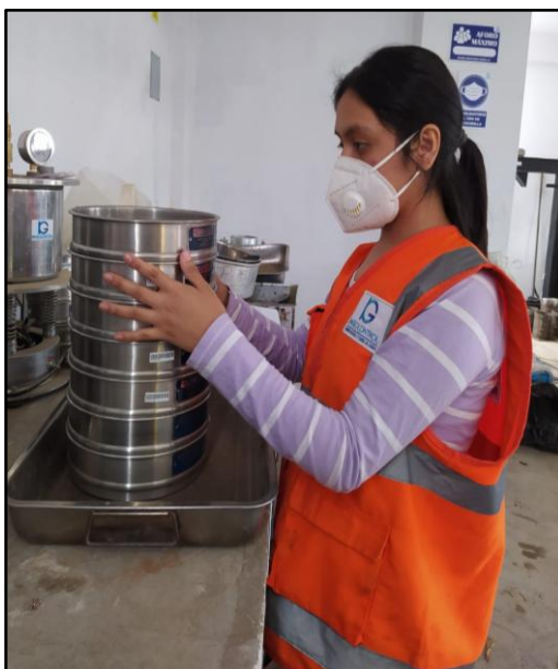
Figura 24. Tamizado del agregado fino
