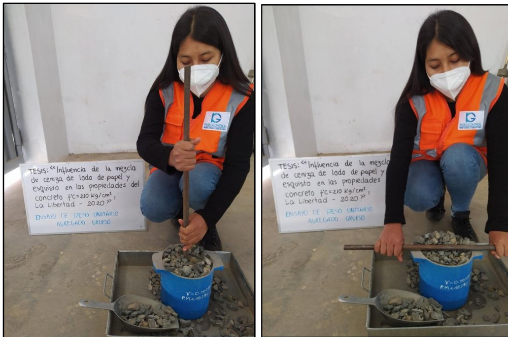
Figura 31. Compactado y enrasado del agregado grueso
