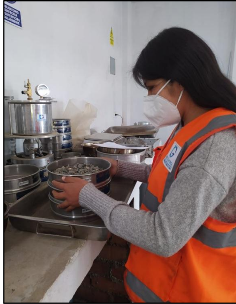
Figura 26. Tamizado del agregado grueso
