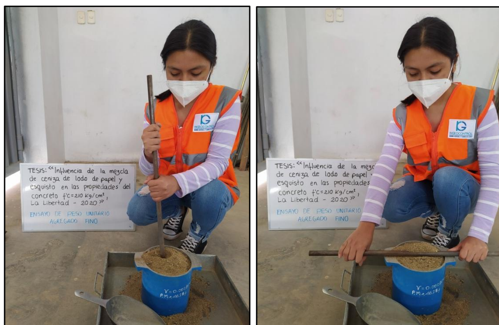
Figura 29. Compactado y enrasado del agregado fino
