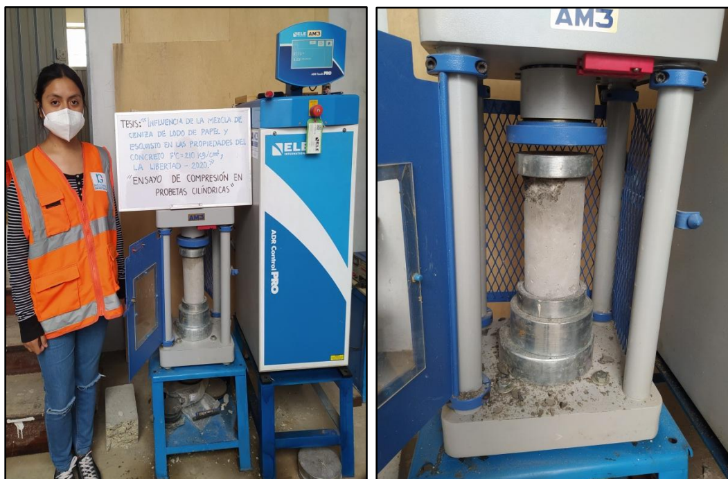
Figura 52. Rotura de probetas cilíndricas
