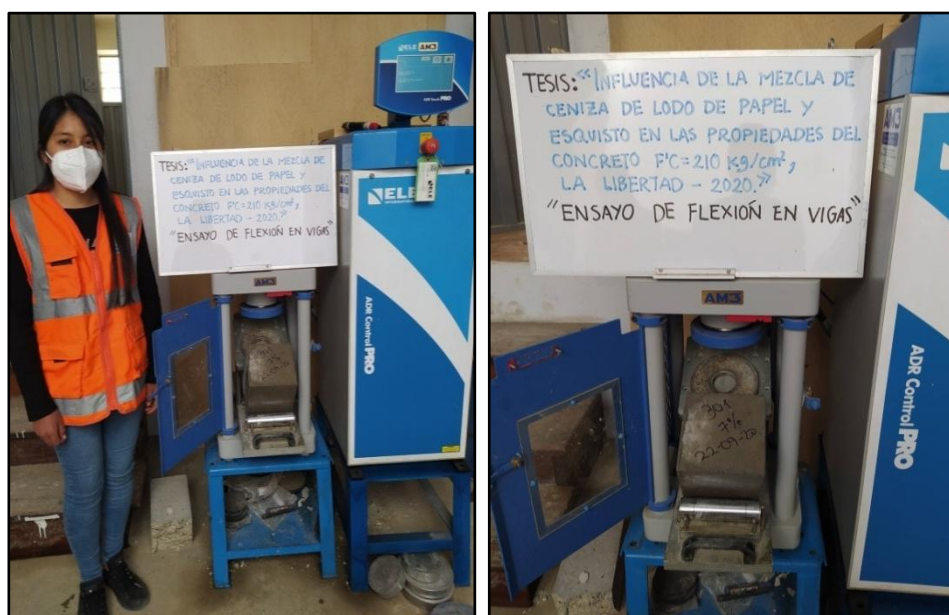
Figura 53. Rotura de vigas
