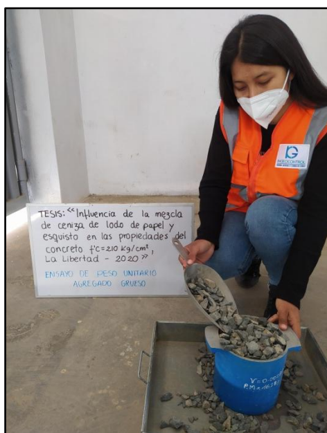
Figura 30. Llenado del molde con agregado grueso
