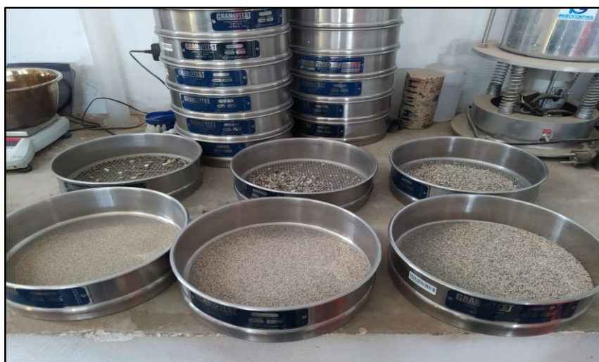
Figura 25. Agregado fino retenido en los tamices
