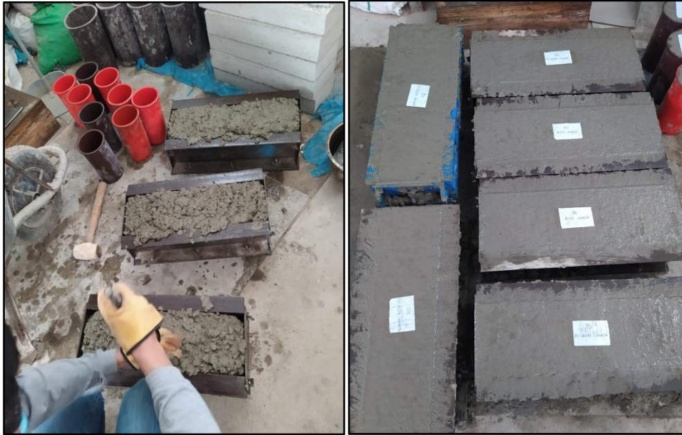
Figura 48. Llenado y compactado de vigas
