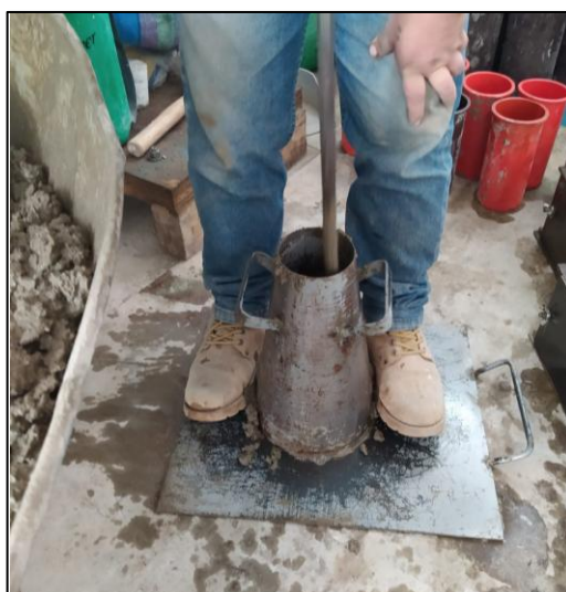
Figura 42. Compactado y enrasado de la mezcla en el cono de Abrams
