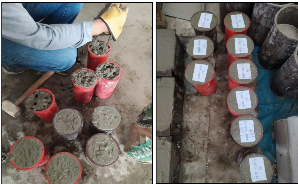
Figura 47. Llenado y compactado de probetas cilíndricas
