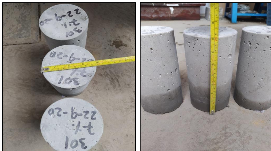
Figura 51. Medición de probetas cilíndricas
