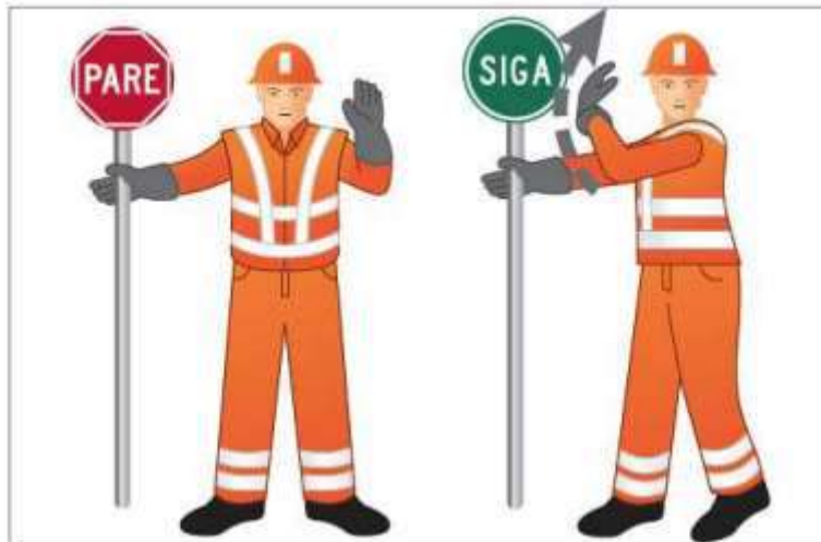
Ilustración 15 Ejemplo de “Banderillero” con señales portátiles reglamentarias “PARE”
