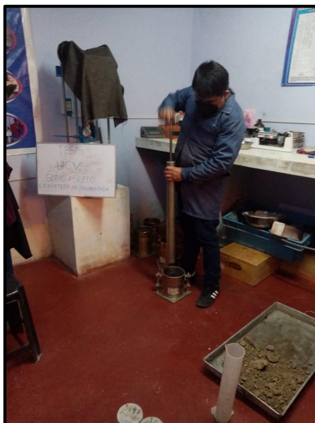
Fotografía 4. Procedimiento de compactación de los suelos Fuente: elaboración propia.
