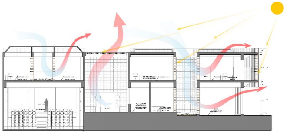
Imagen 119. El Proyecto se protege del asoleamiento protegiendo las ventanas al oeste y norte mediante parasoles de madera. Fuente: Elaboración Propia.
