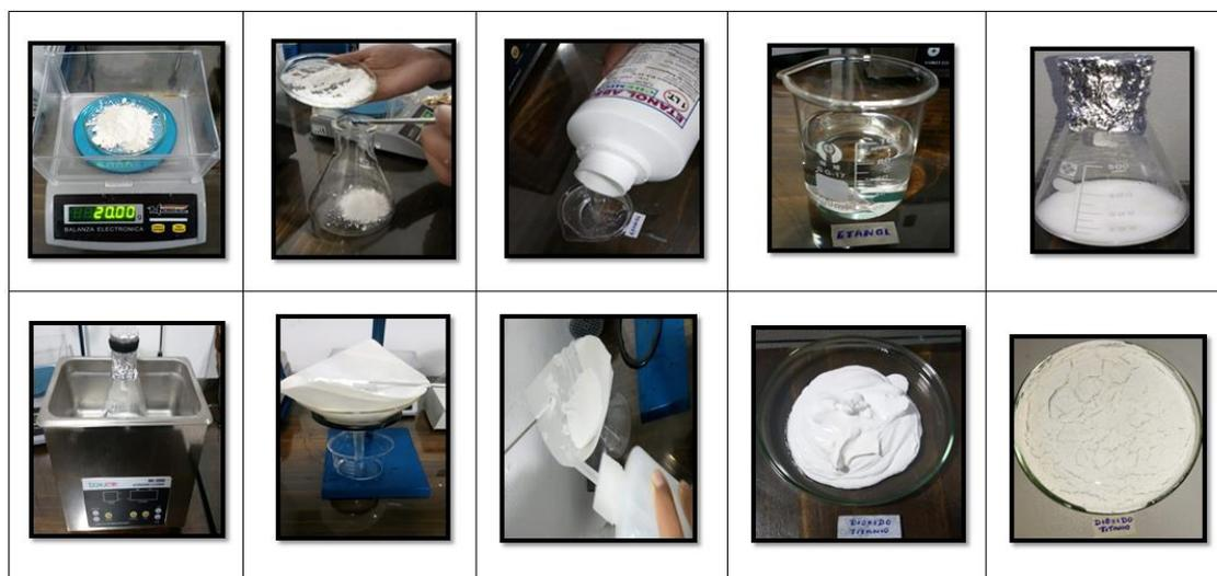
**Figura 18: Proceso para la obtencion de particulas de  $TiO_2$**
