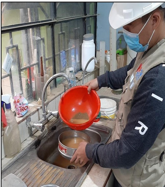
FOTO N°11, 12 y 13: Para la grava se tamizo por las mallas 3", 2", 1 ½", 1", ¾", ½", 3/8" y N°4 y se pesó lo retenido.
