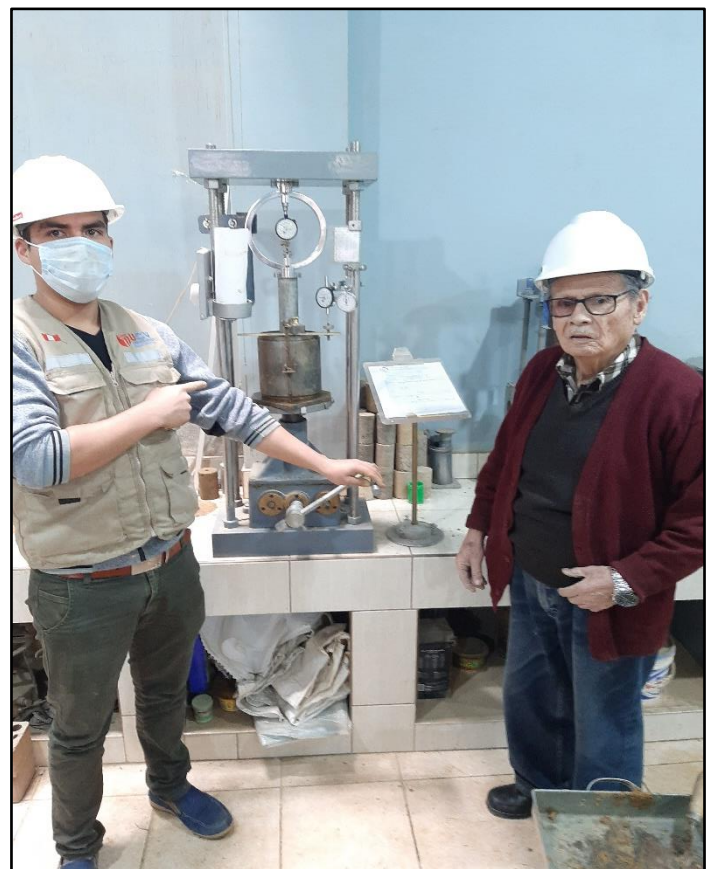
FOTO N°34 y 35: Proctor Modificado con dosificación de 2%, 4% y 6% se mesclo 6kg de muestra y se añadió los porcentajes según el peso y se elaboró el mismo procedimiento.
