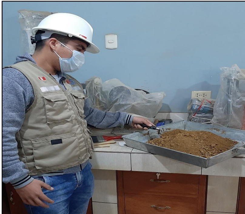
FOTO N°42 y 43: California Bearing Ratio con dosificación de 2%, 4% y 6% se mesclo 6kg de muestra y se añadió los porcentajes según el peso y se elaboró el mismo procedimiento para el ensayo de CBR.
