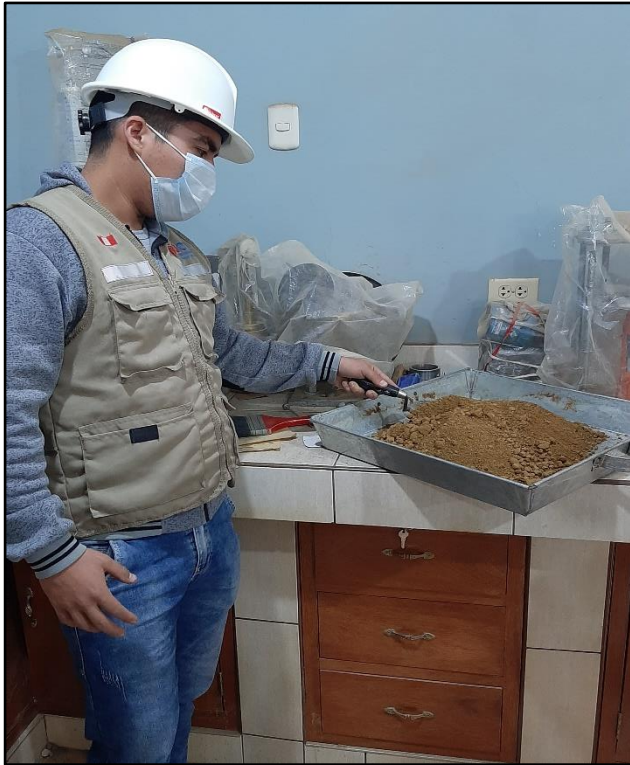
FOTO N°34 y 35: Proctor Modificado con dosificación de 2%, 4% y 6% se mesclo 6kg de muestra y se añadió los porcentajes según el peso y se elaboró el mismo procedimiento.
