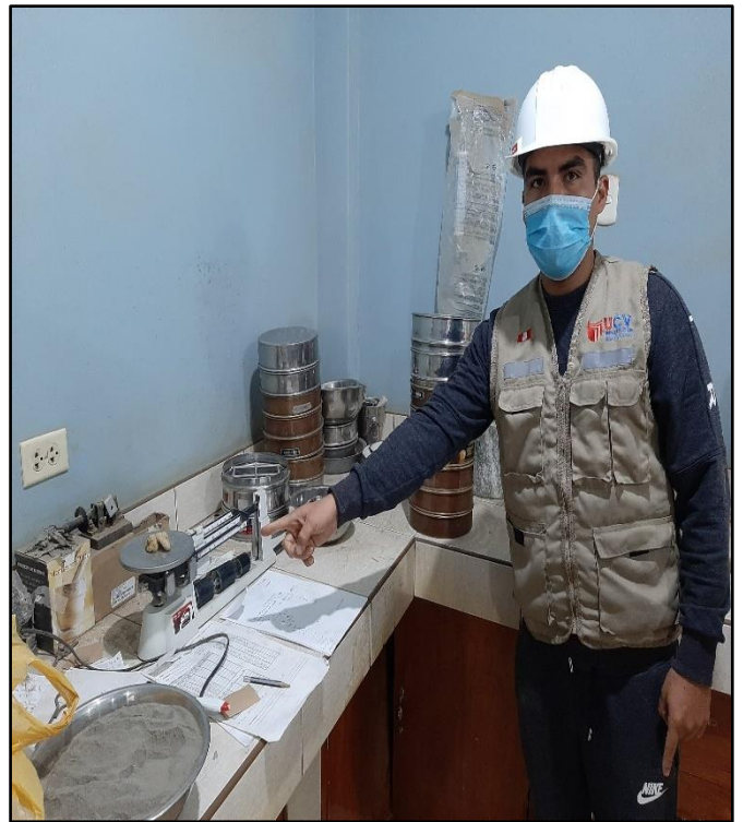
FOTO N°07, 08, 09 y 10: La muestra se pasa por la malla N°4 para separar la muestra para grava y finos, se limpia la grava con un cepillo de hierro para separar los finos y con la ayuda de un martillo se machuca la muestra.
