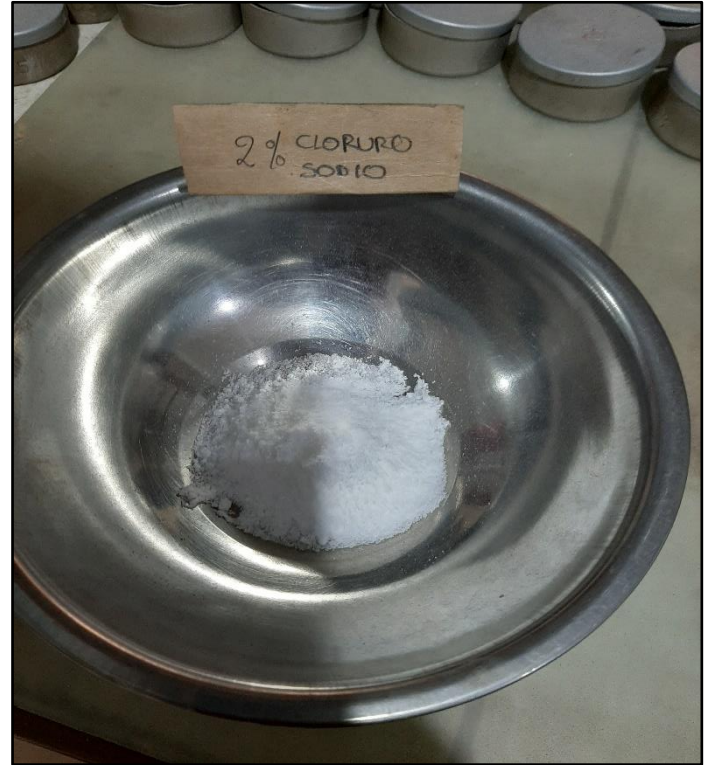
FOTO N°34 y 35: Proctor Modificado con dosificación de 2%, 4% y 6% se mesclo 6kg de muestra y se añadió los porcentajes según el peso y se elaboró el mismo procedimiento.
