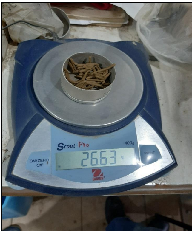
FOTO N°27, 28, 29 y 30: Limite Plástico con la mano se hizo rollitos delgados y luego enzima de papel filtro para quitar humedad, después se sigue haciendo rollitos y lo que se parte se coloca en un recipiente se tomó muestra hasta 26gr, se pesó la muestra húmeda se deja secar y se volvió secar.
