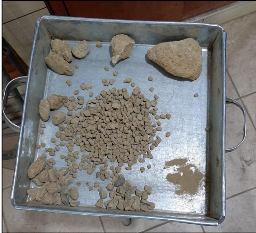
FOTO N°11, 12 y 13: Para la grava se tamizo por las mallas 3", 2", 1 ½", 1", ¾", ½", 3/8" y N°4 y se pesó lo retenido.
