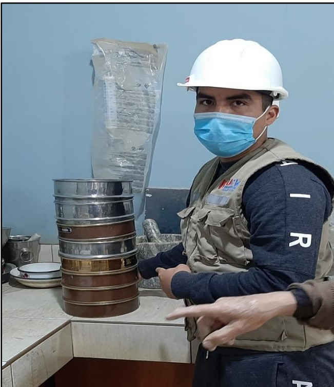
FOTO N°07, 08, 09 y 10: La muestra se pasa por la malla N°4 para separar la muestra para grava y finos, se limpia la grava con un cepillo de hierro para separar los finos y con la ayuda de un martillo se machuca la muestra.
