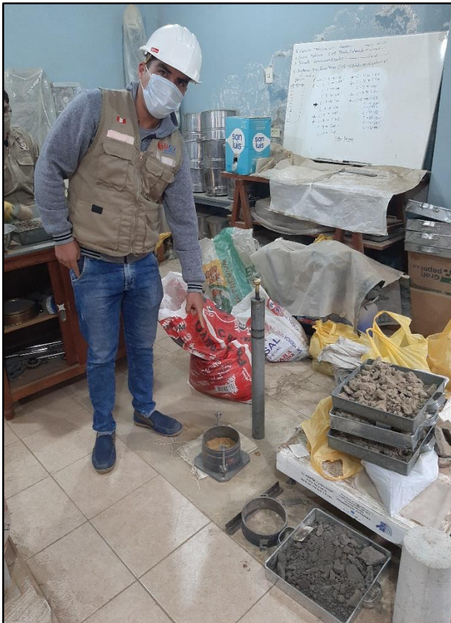
FOTO N°34 y 35: Proctor Modificado con dosificación de 2%, 4% y 6% se mesclo 6kg de muestra y se añadió los porcentajes según el peso y se elaboró el mismo procedimiento.
