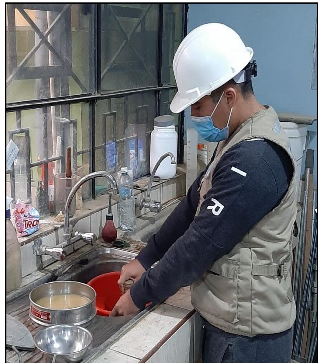
FOTO N°11, 12 y 13: Para la grava se tamizo por las mallas 3", 2", 1 ½", 1", ¾", ½", 3/8" y N°4 y se pesó lo retenido.
