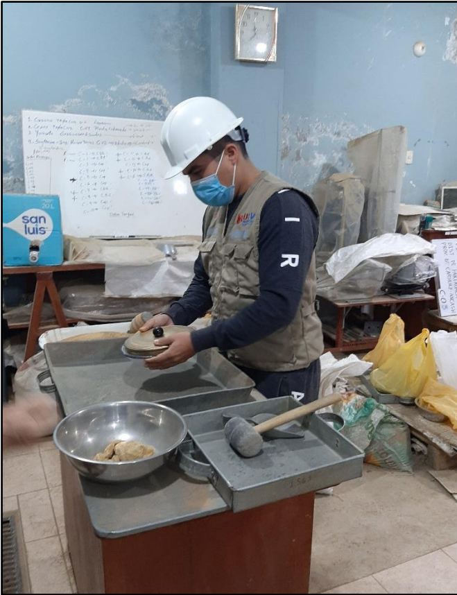
FOTO N°07, 08, 09 y 10: La muestra se pasa por la malla N°4 para separar la muestra para grava y finos, se limpia la grava con un cepillo de hierro para separar los finos y con la ayuda de un martillo se machuca la muestra.
