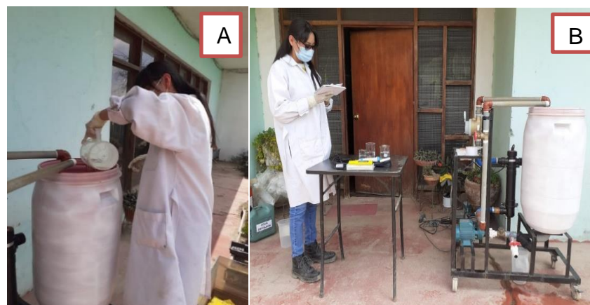
Figura 16. (A) Agregando el agua contaminada de subsuelo al sistema colector de UV, (B) Sistema colector realizando el ciclo
