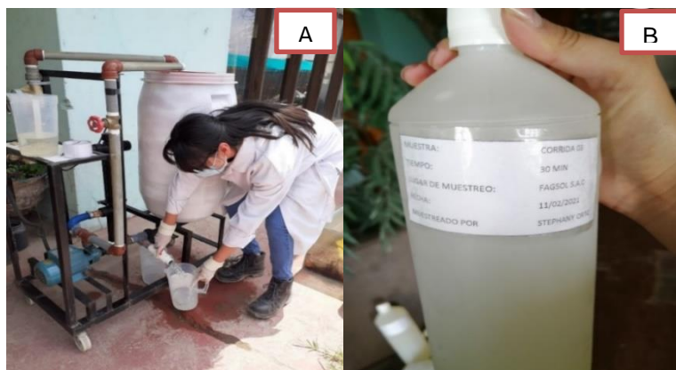
Figura 17. (A) Recolección del agua tratada mediante Luz ultravioleta, (B) Rotulado de la muestra de agua
