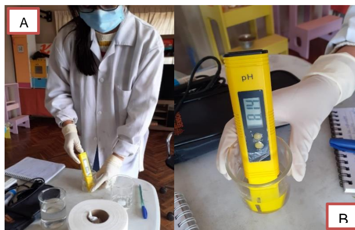
Figura 14. (A) Toma de muestra del Potencial de hidrogeno, (B) Equipo de medición Ph-metro”; todo ello para la caracterización de aguas contaminadas de subsuelo
