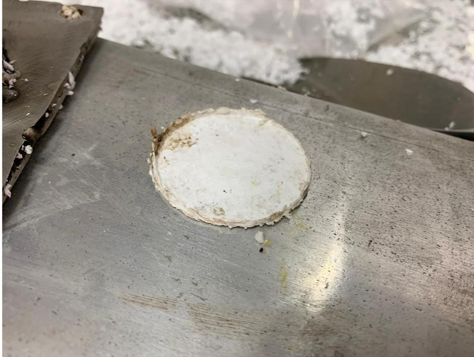
*Figura 11.* Poliestireno expandido comprimido.
