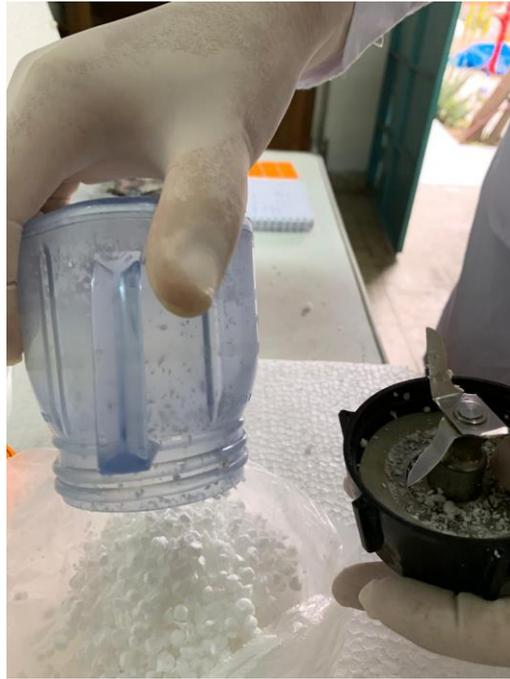
*Figura 26. Poliestireno expandido Cizallado*
