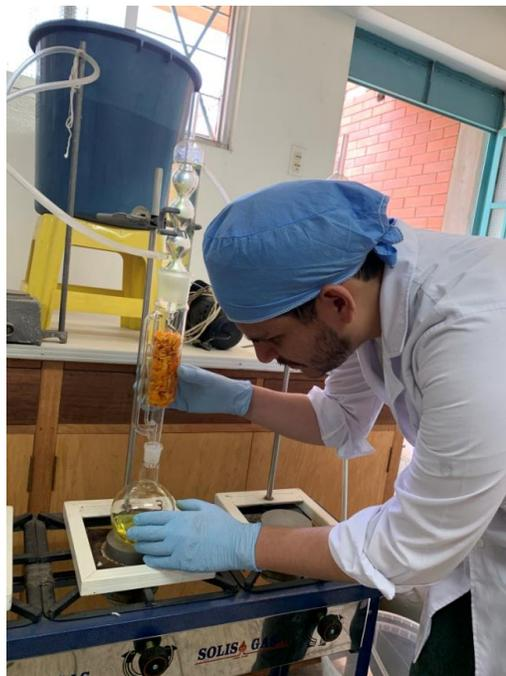
*Figura 18. Instalación del Soxhlet*
