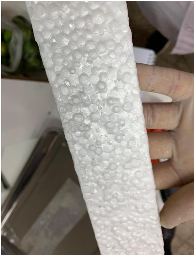
*Figura 12.* Deformación del EPS
