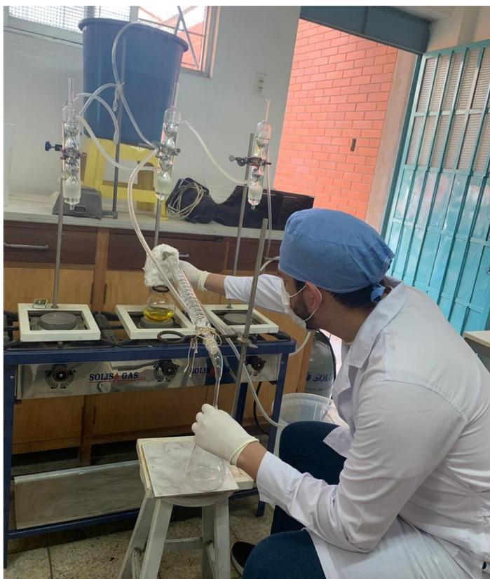
Figura 15. Destilación con vapor de agua
