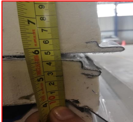
Figura 40. Toma de medida de espesor del panel
