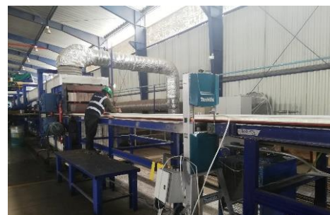
Figura 53. personal verificando espesor
