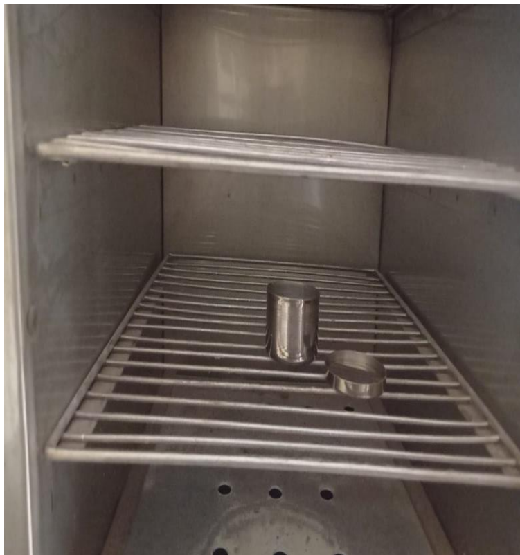
Fotografía 22: colocación de las muestras en el horno eléctrico para limite plástico y liquido
