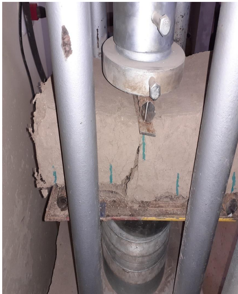
Fotografía 38: ensayo de flexión 0.5%
