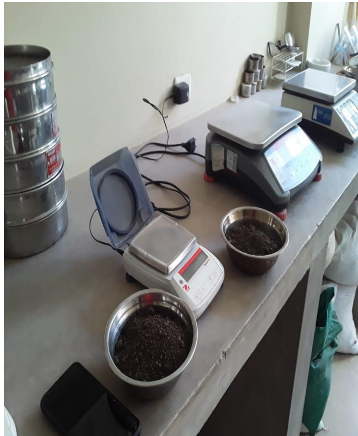
Fotografía 10: Muestras para ensayo de Humedad
