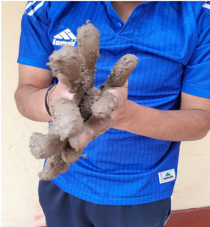
Fotografía 4: Prueba Del Rollito
