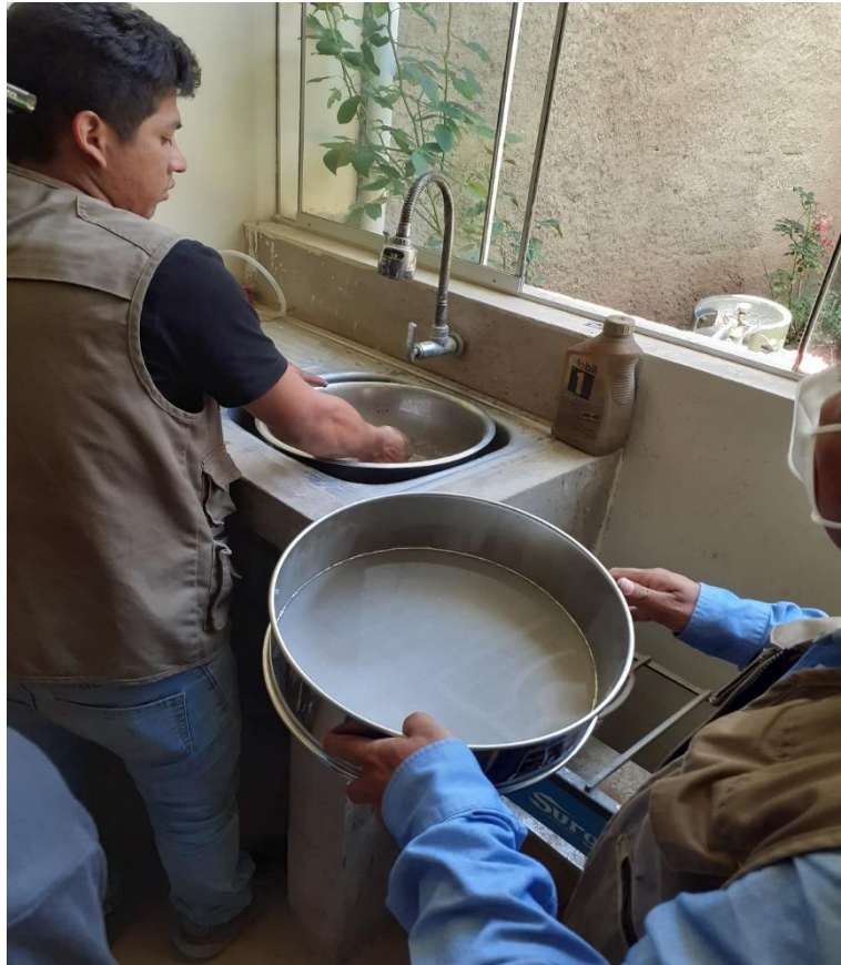
Fotografía 16: colocación del material en mallas para ensayo de granulometría
