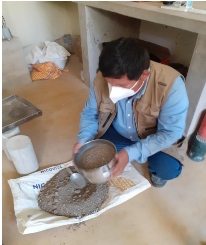
Fotografía 20: moja de una parte de la muestra para limite liquido
