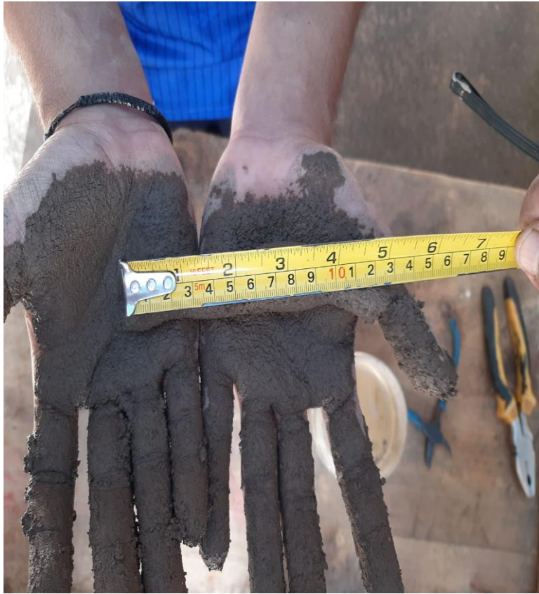
Fotografía 6: Prueba De La Bolita
