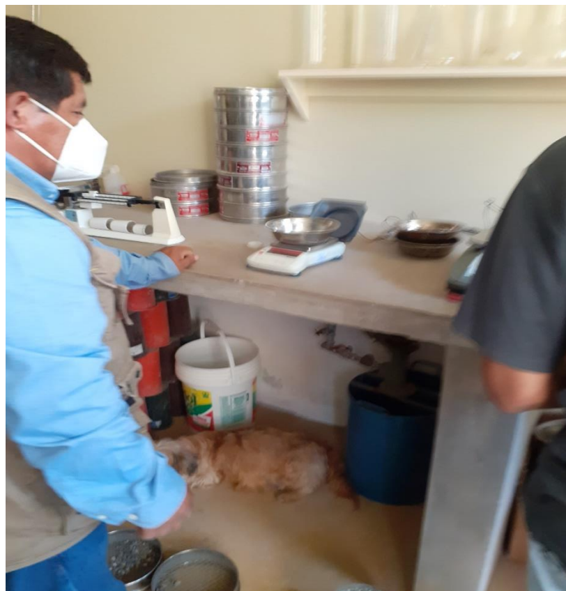
Fotografía 18: pesos de cada malla para ensayo de granulometría
