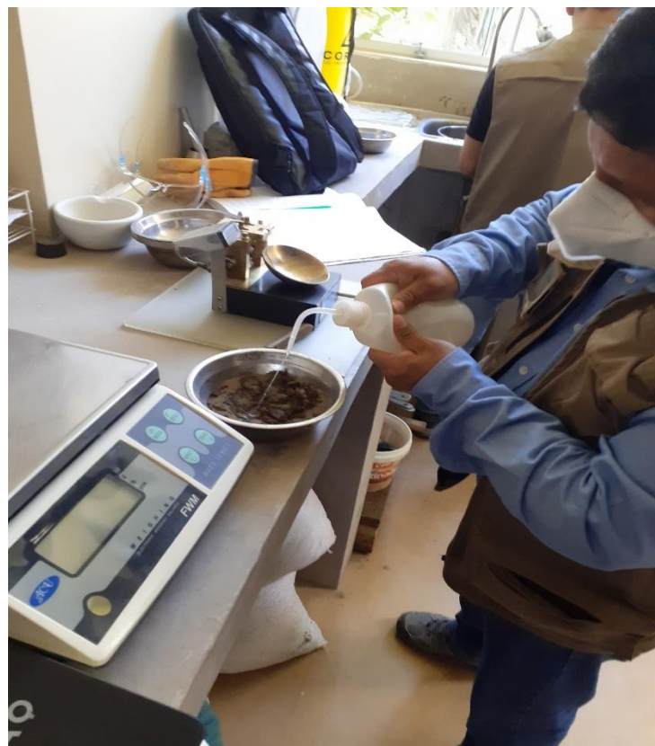
Fotografía 20: moja de una parte de la muestra para limite liquido
