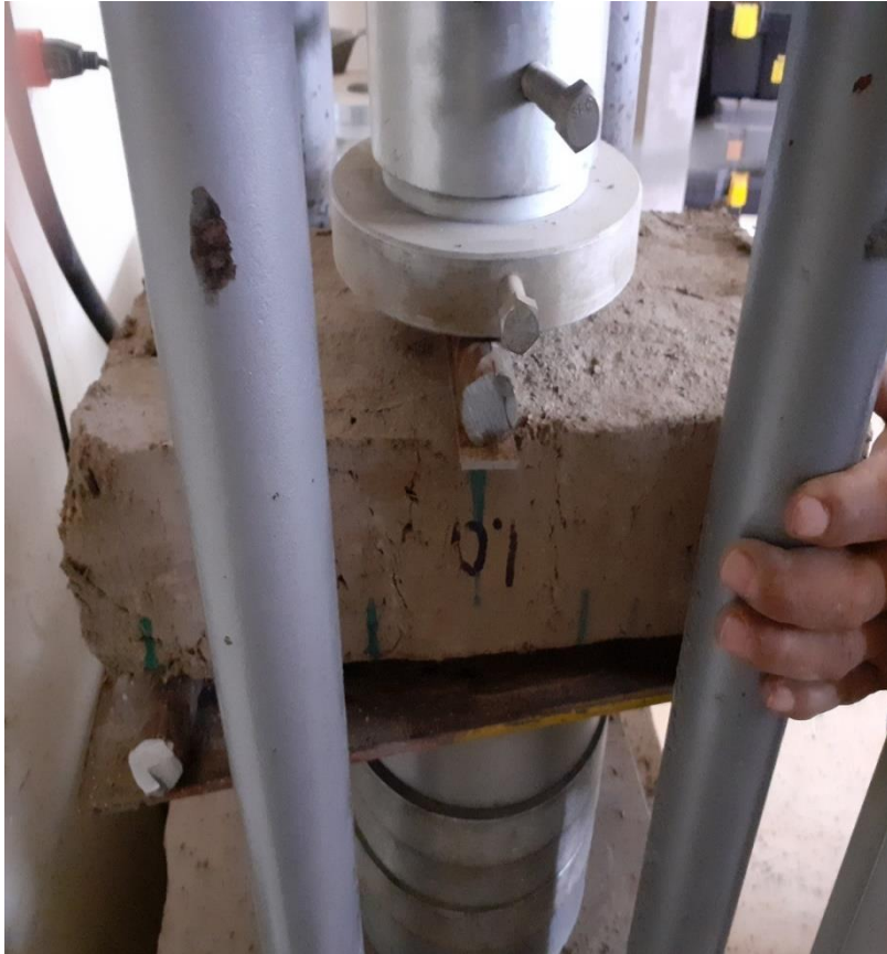
Fotografía 40: ensayo de flexión con 1.5%
