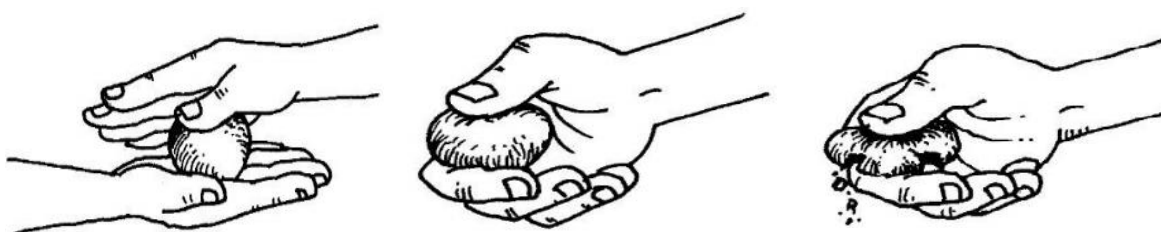
Figura 4: Prueba de bolita para identificar si la tierra sirve para la elaboración de adobe (Vargas,2010-p-23)
