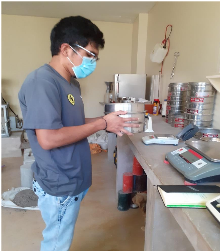
Fotografía 16: colocación del material en mallas para ensayo de granulometría
