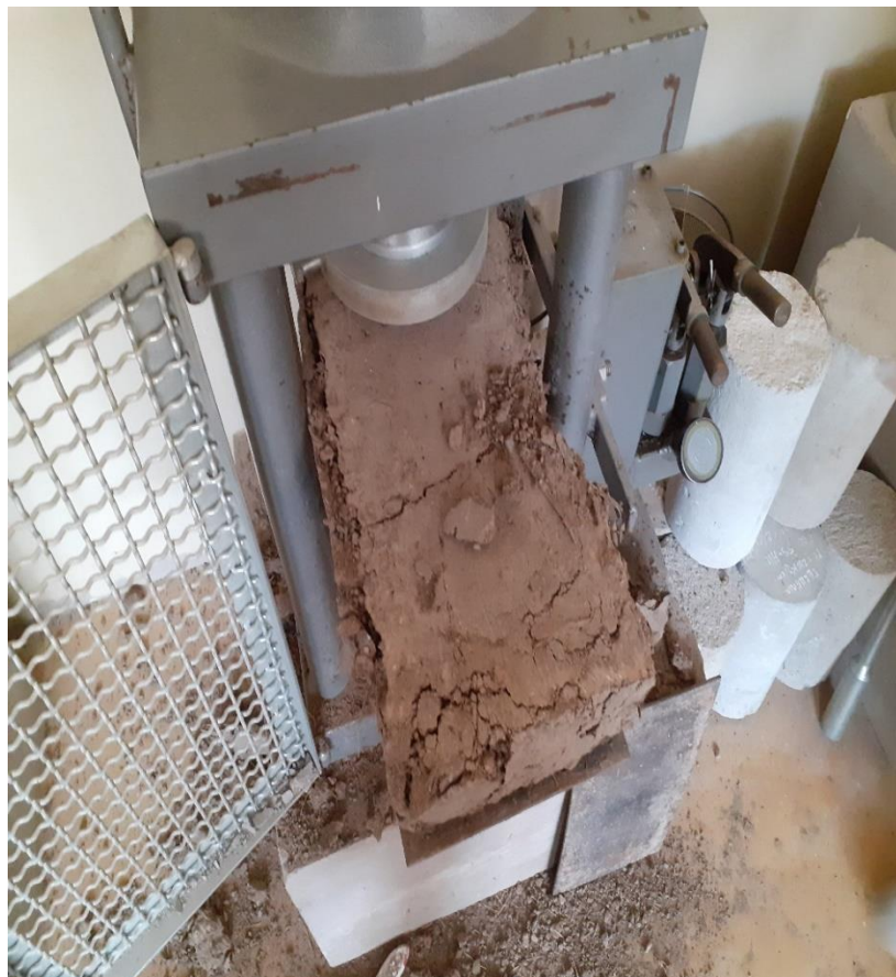
Fotografía 36: ensayo de rotura con 1.5%
