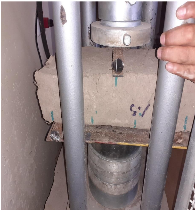
Fotografía 40: ensayo de flexión con 1.5%
