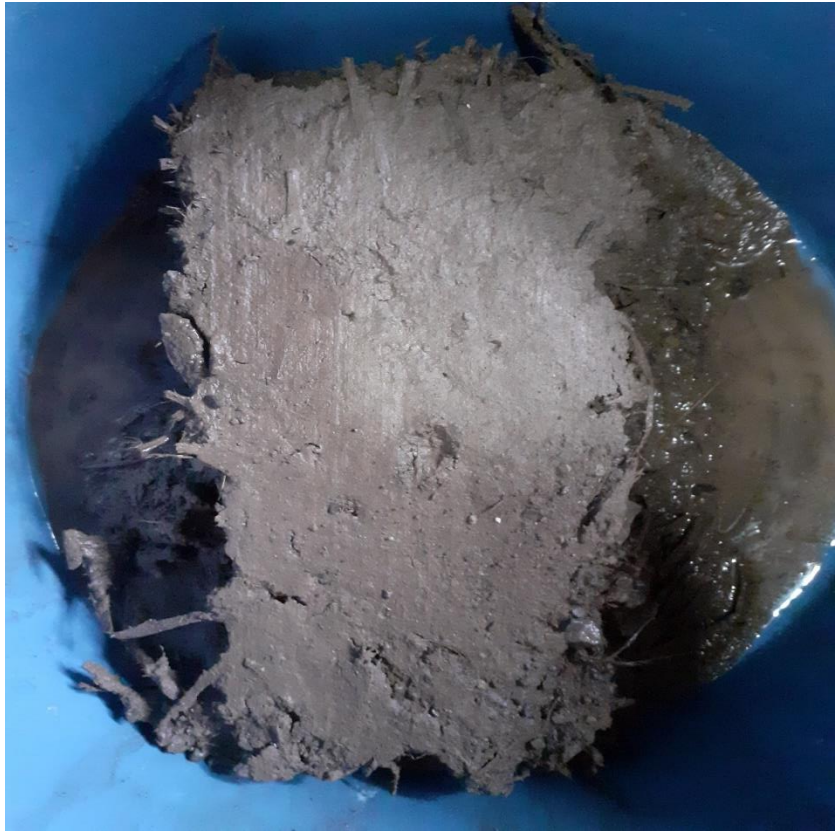
Fotografía 44: ensayo de absorción con 1.5%
