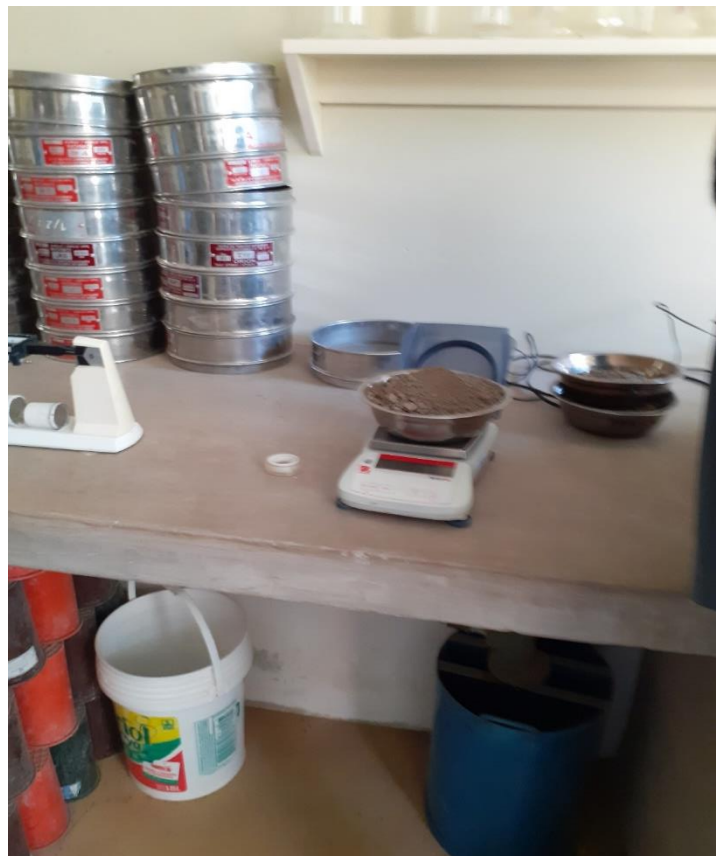
Fotografía 14: Peso inicial de la muestra para ensayo de granulometría
