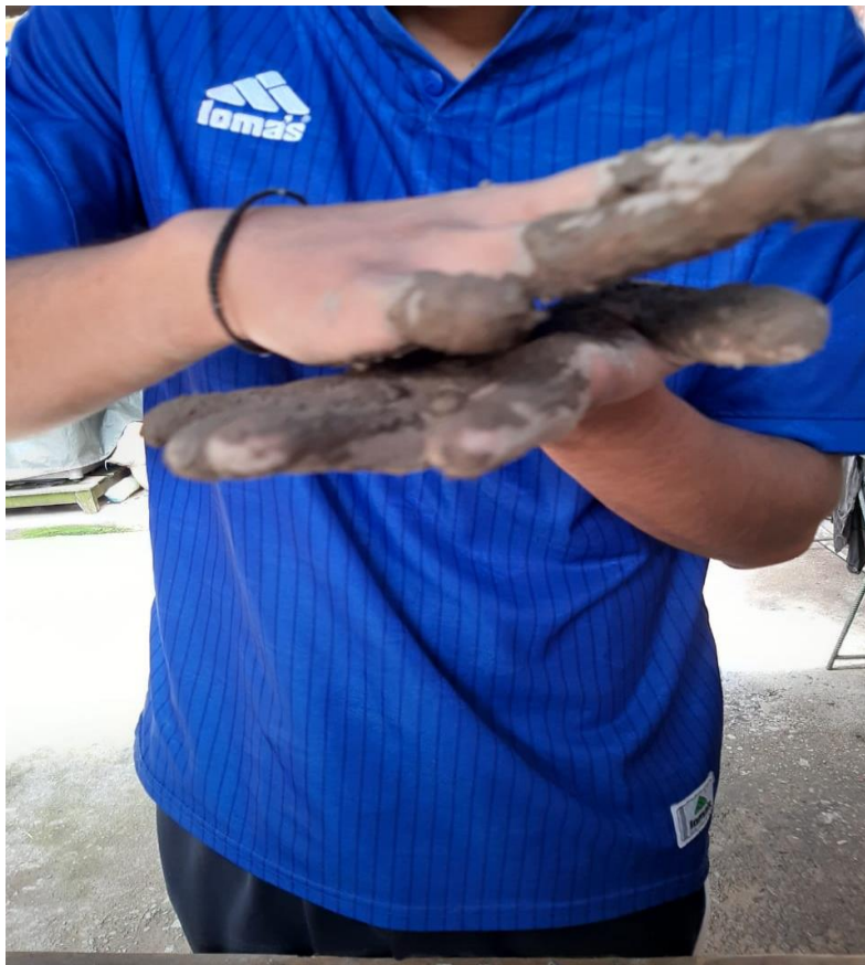
Fotografía 6: Prueba De La Bolita
