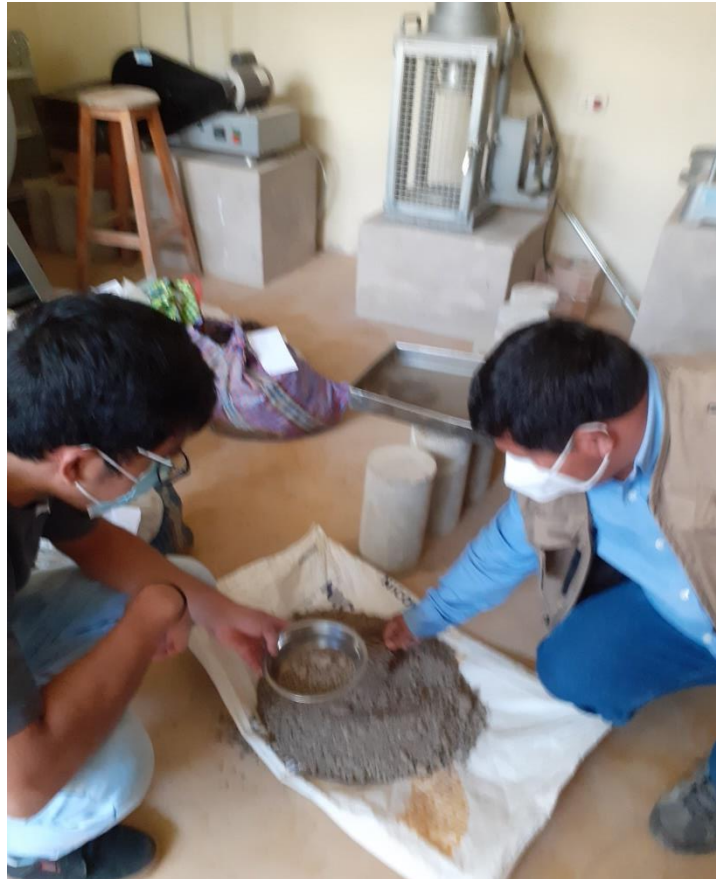
Fotografía 14: Peso inicial de la muestra para ensayo de granulometría
