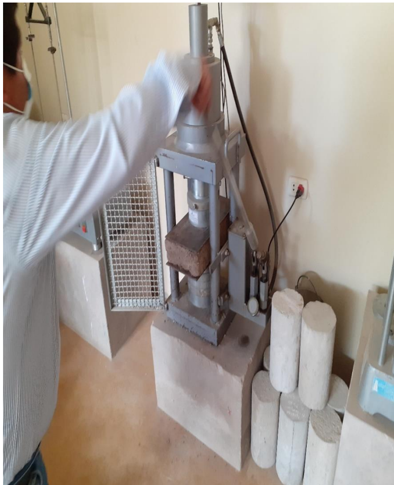
Fotografía 34: Ensayo de rotura con 0.5%
