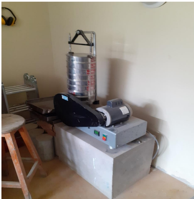
Fotografía 18: pesos de cada malla para ensayo de granulometría
