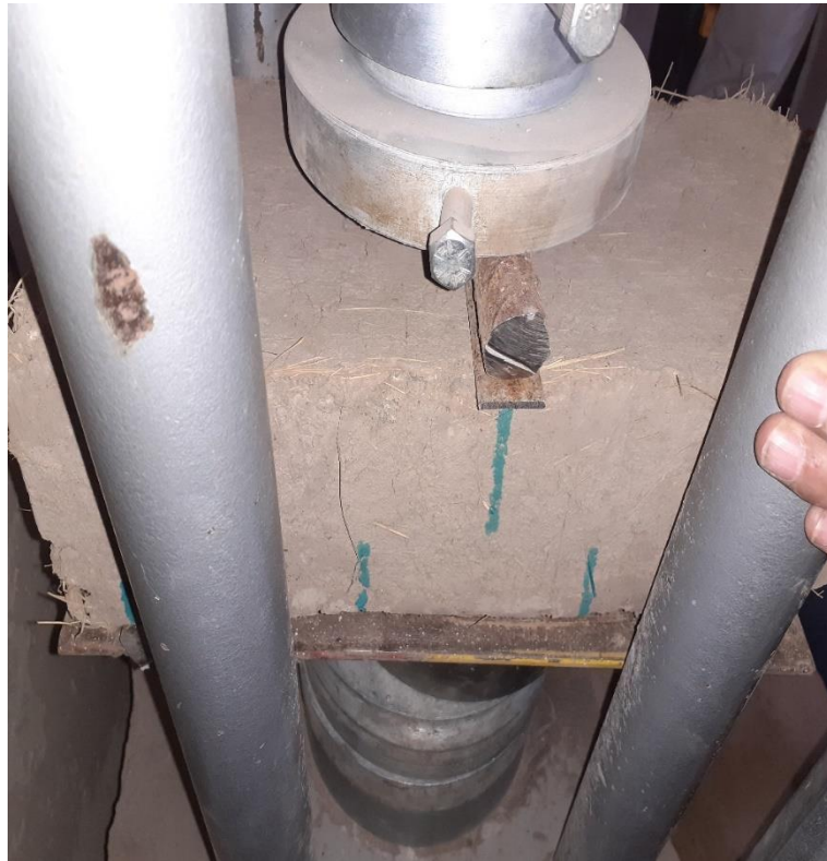
Fotografía 38: ensayo de flexión 0.5%
