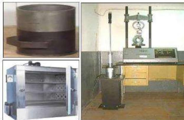
*Nota.* La figura muestra los implementos necesarios para la aplicación de carga. Adaptado de *Manual de ensayo de materiales*, por MTC, 2016.
