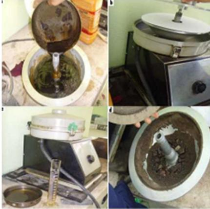
Nota. La figura muestra el ensayo para la determinación de contenido asfáltico en la muestra.
