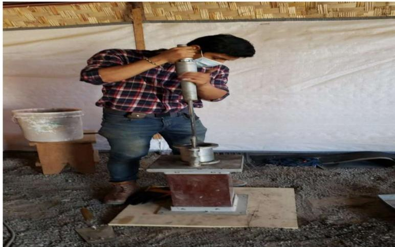
*Figura 56: Conformación de pastillas con martillo Marshall.*
