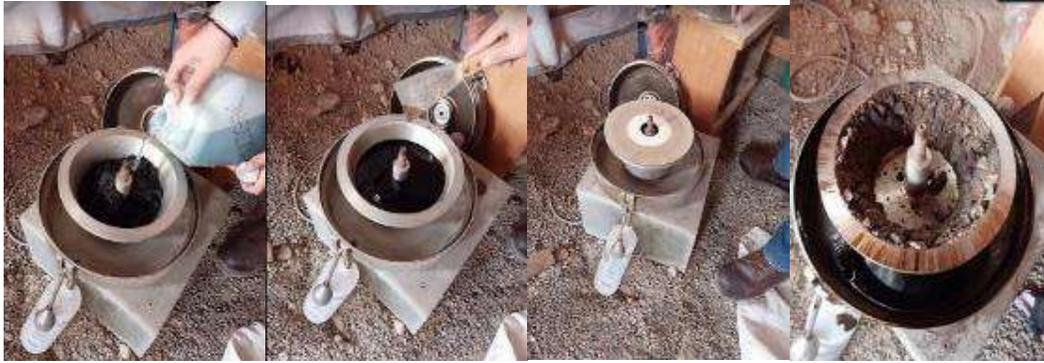
*Figura 52: Proceso de lavado asfáltico*
