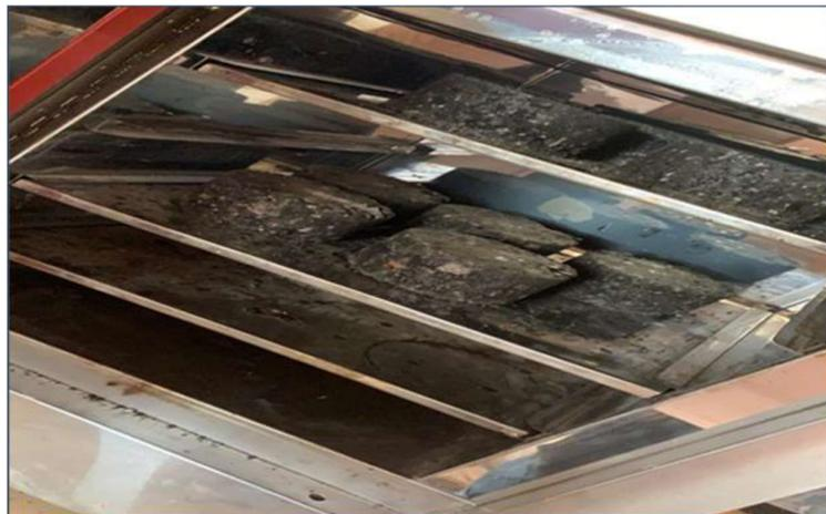
*Figura 57: Secado de pastillas a 60° en horno eléctrico.*
