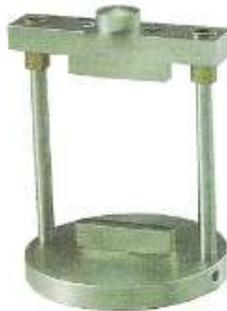
Nota. La figura muestra el cabezal lottman. Adaptado de *Manual de ensayo de materiales*, por MTC, 2016.
