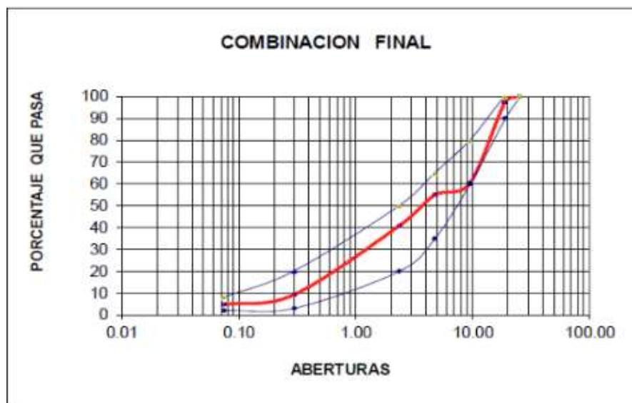
Nota. La imagen muestra la distribución de la granulometría de la combinación final de los agregados.
