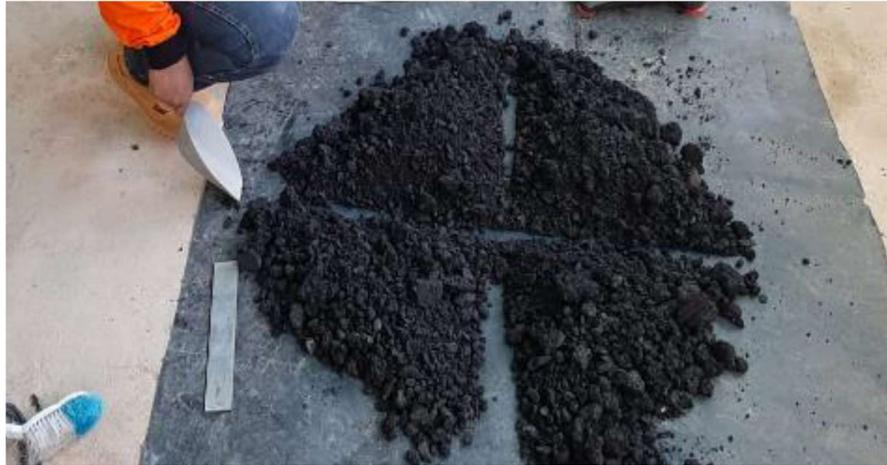
Nota. La figura muestra el cuarteo del remanente asfáltico.
