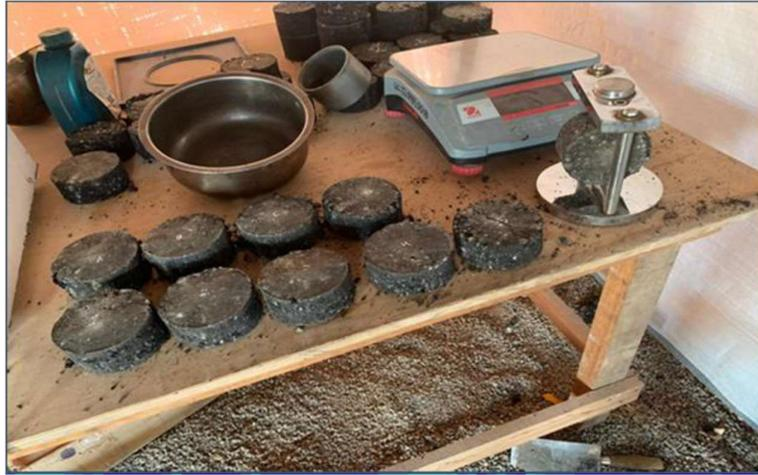
Figura 58: Extracción de pastillas previo a los ensayos.
