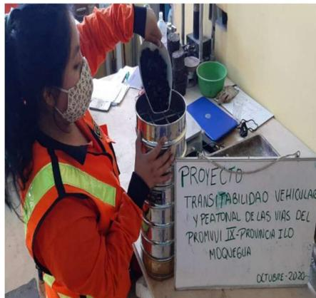
Nota. La figura muestra la determinación de la granulometría.
