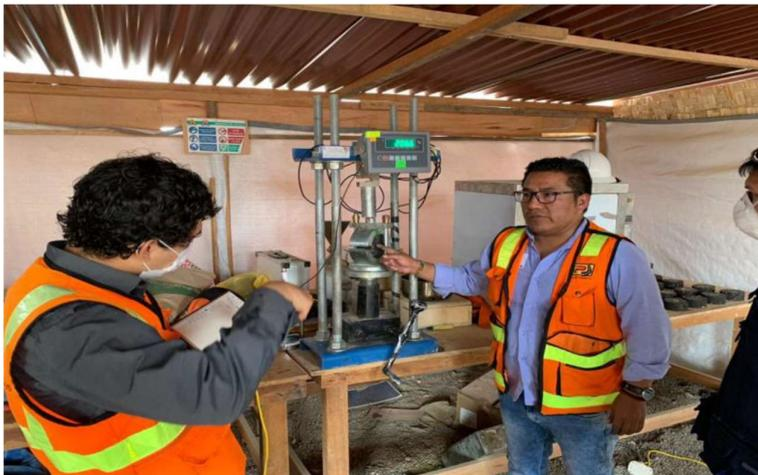
Figura 59: Ensayo estabilidad Marshall con el especialista del laboratorio.
