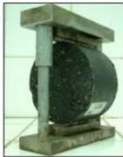
Nota. La figura muestra el espécimen utilizado para el ensayo de compresión diametral. Adaptado de *Manual de ensayo de materiales*, por MTC, 2016.
