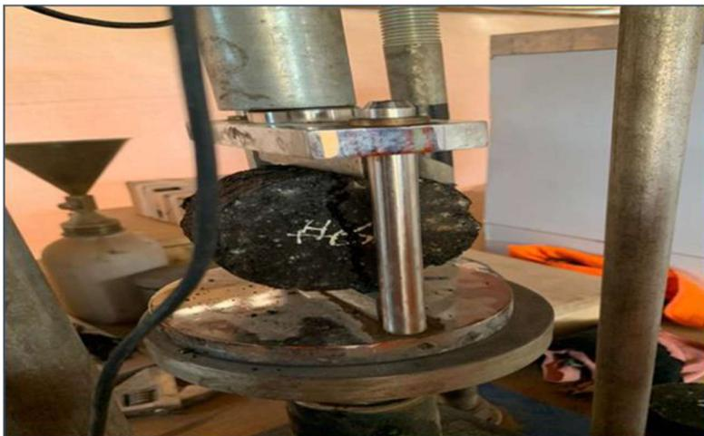
Figura 60: Ensayo a la resistencia de tracción indirecta, empleando el cabezal lottman
