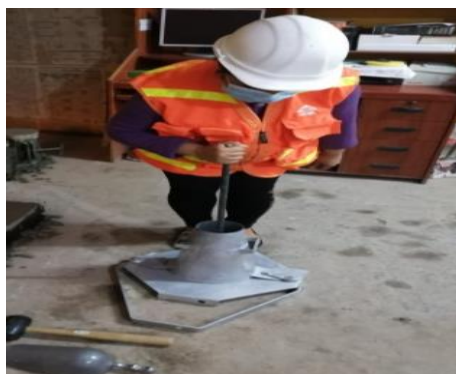
Figura N°42. Proceso de ensayo de asentamiento, chuseo a 5 golpes.
