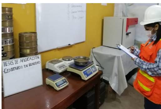
Figura N°37. Proceso de ubicación y ensayo del agregado Fino para la obtención del contenido de humedad.
