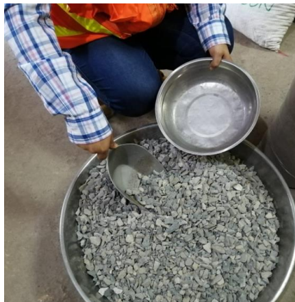
Figura N°30. Estado de agregados gruesos traídos de cantera a ser utilizados en el laboratorio.
