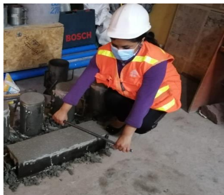
Proceso de uso de la varilla para la nivelar el ras de la viga
