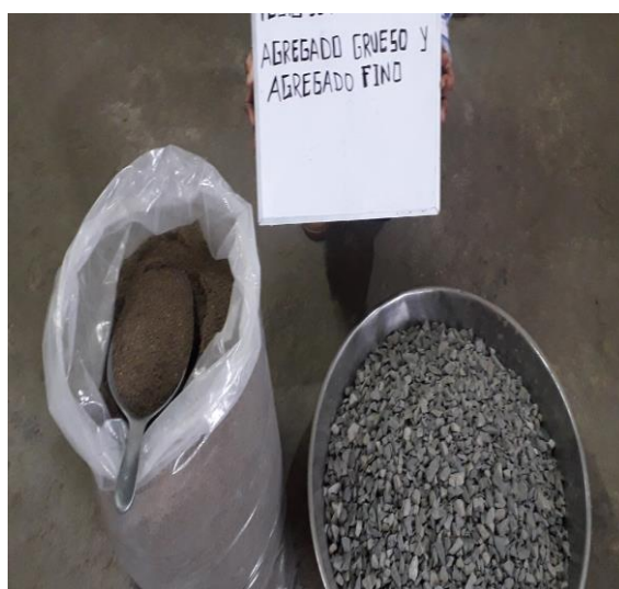
Figura N°24. Estado de agregados finos y gruesos traídos de cantera a ser utilizados en la siguiente tesis.
