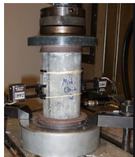
Figura: N°13. Método de ensayo a compresión del concreto en muestras de material cilíndricas.
