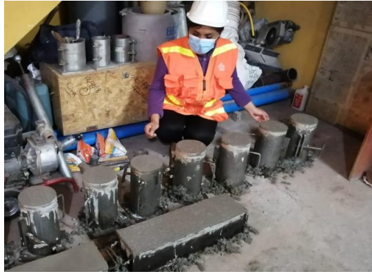
Probetas y vigas para ser ensayadas
