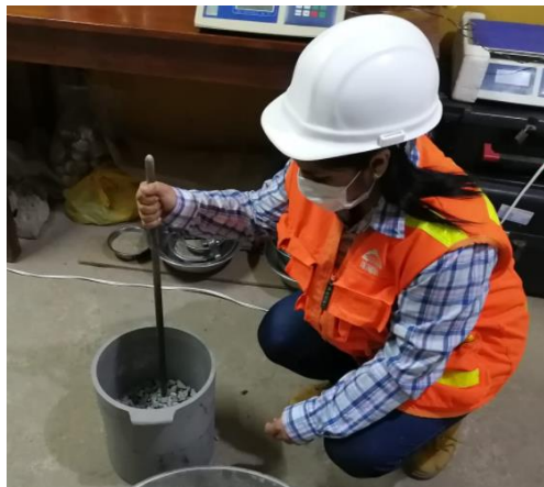
Figura N°39. Proceso de 25 golpes con una varilla de 5/8" de diámetro por 60 cm de longitud.
