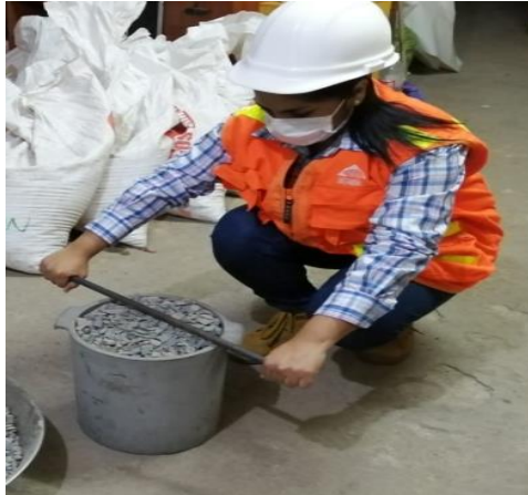
Figura N°40. Proceso de moldeo con la Varilla al ras del borde del molde.
