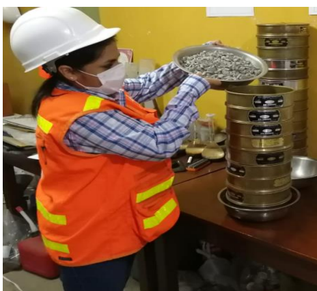
Figura N°31. Tamices ½", 3/8", ¼", N°4, N°6, N°8, N°10, N°16, N°20, N°30, N°40, N°5, N°60, N°80, N°100, N°200.
