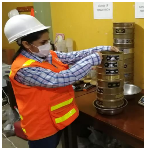
Figura N°26. Tamices de 3", 2", 1 1/2", 1", 3/4", 1/2", 3/8", 1/4", N°4, N°6, N°8, N°10, N°16, N°20, N°30, N°40, N°5, N°60, N°80, N°100, N°200 a ser utilizados en el laboratorio.
