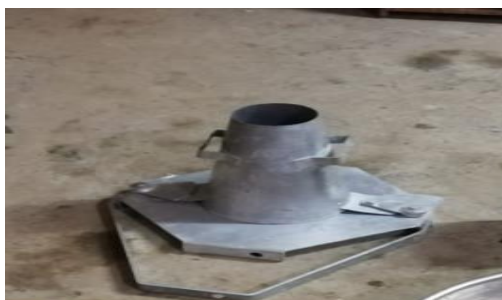
Figura N°41. Instrumento de Cono de Abrams para el ensayo de Asentamiento del concreto.
