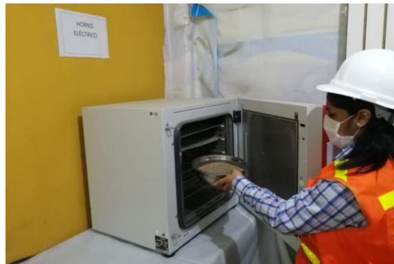
Figura N°34. Horno regulado a una temperatura de 110^{\circ}\text{C} .
