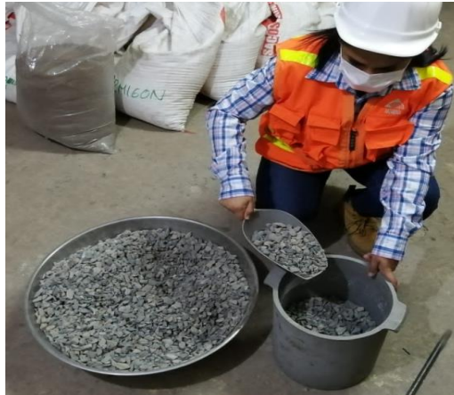
Figura N°38. Colocación del agregado grueso en el molde a ser ensayado.
