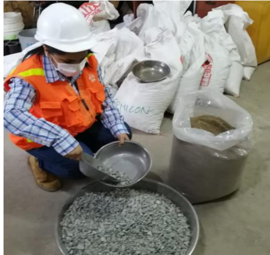
Figura N°25. Estado de agregados finos y gruesos traídos de cantera a ser utilizados en el laboratorio.
