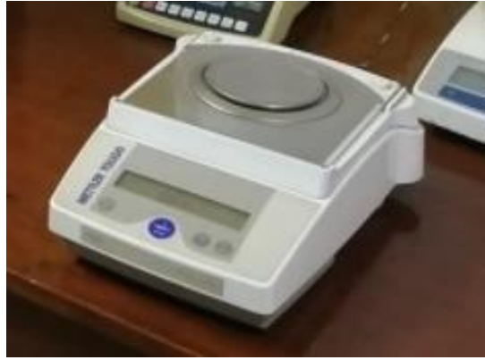
Figura N°33. Balanza sensible a 0.5 gr. de acuerdo con el peso de la muestra. Así mismo un picnómetro o llamado también fiola que es un frasco volumétrico con capacidad de 500ml, un molde metálico, un apisonador de metal con un peso de 340 \pm 15 gr con un extremo de superficie circular de 25 \pm 3 mm de diámetro de contacto. Un horno con temperatura de 110^{\circ}\text{C} y bomba de vacío.
