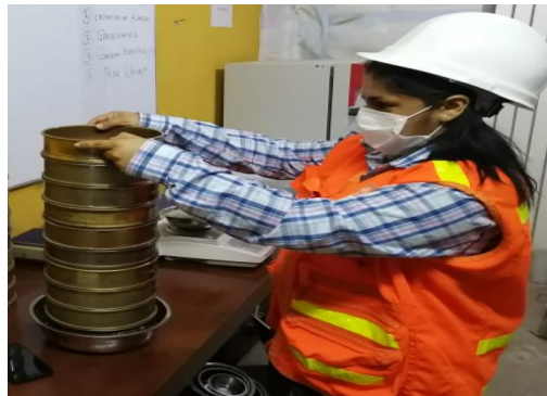
Figura N°28. Ensayo de granulometría del Agregado Fino con los tamices de N°04+ N°08+N°16+ N°30+N°50+N°100/100.
