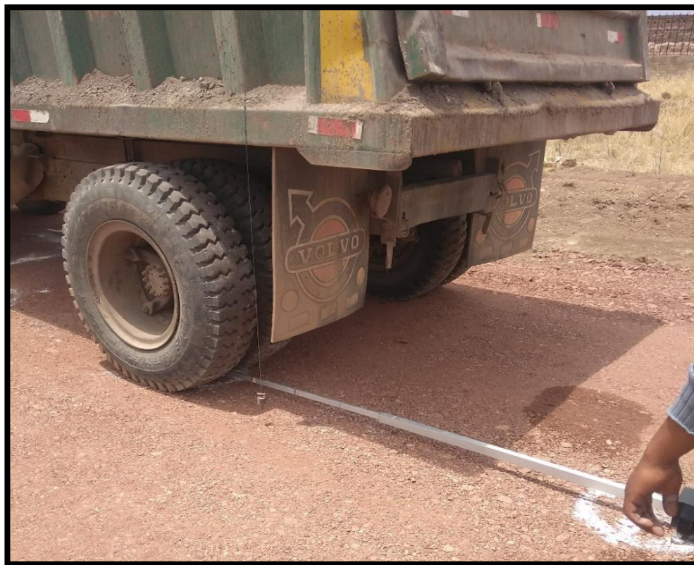
Ilustración N° 14. Lecturando los puntos con la Viga Benkelman.
