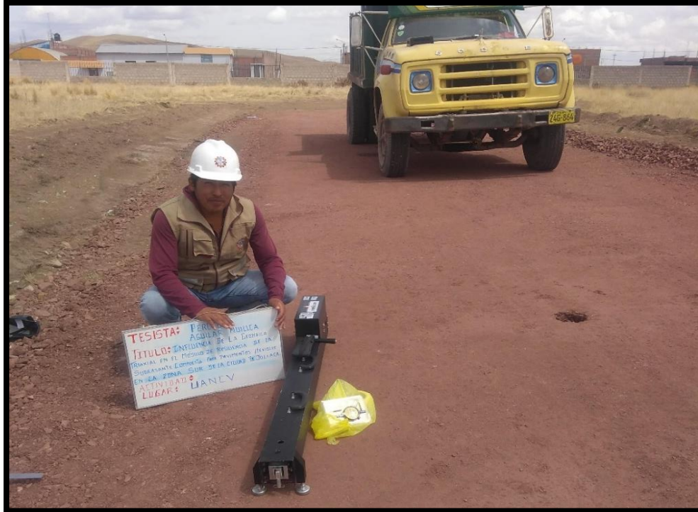
Ilustración N° 11. Viga Benkelman y el camión pesante de 18000lb.
