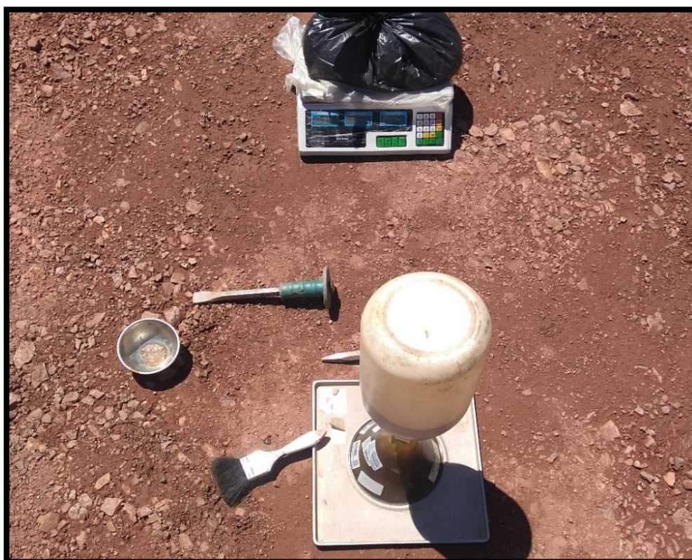
Ilustración N° 10. Ensayo Cono de Arena.
