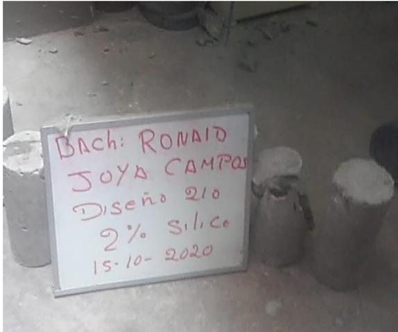
**Figura 8.** Rotura de probetas con el 2%
