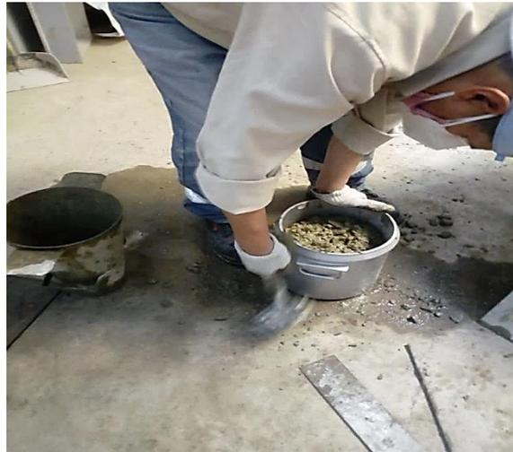
Fotografía 8. Ensayo de Peso unitario
