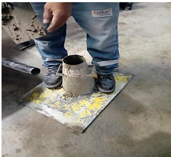
Fotografía 5. Ensayo de asentamiento
