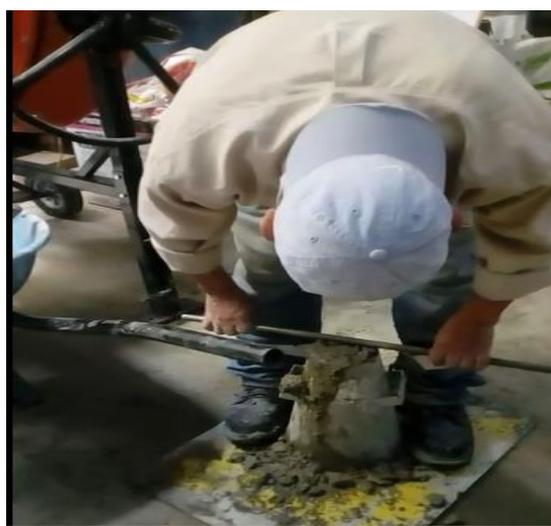
**Figura 7.** Enrazado de la parte superior del cono
