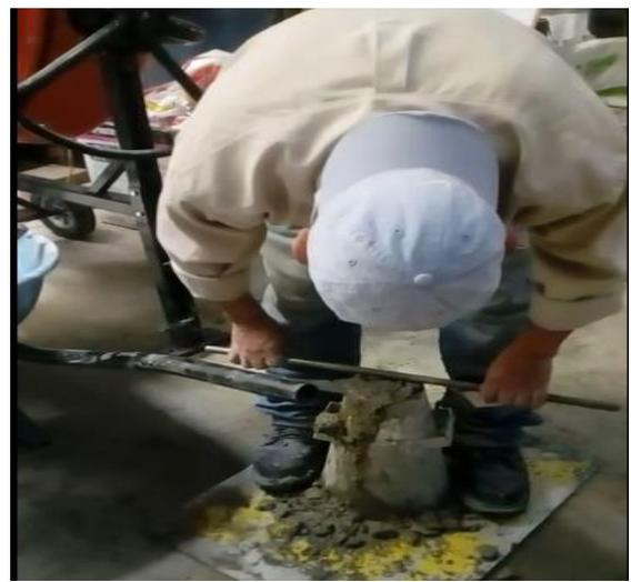
Fotografía 6. Ensayo de asentamiento
