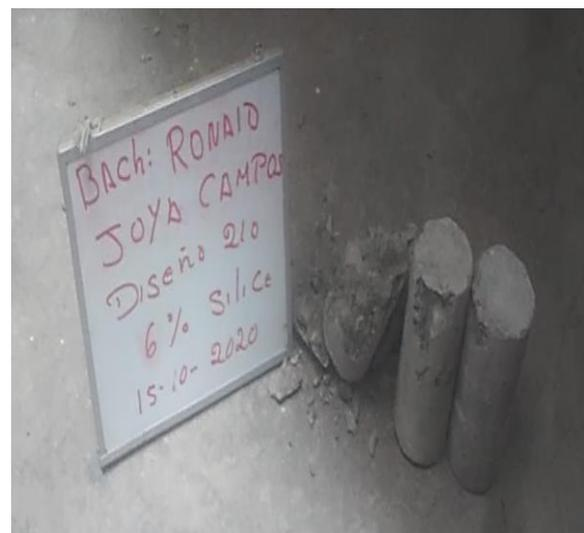
Fotografía 17. Rotura de testigos
