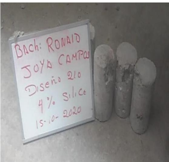
Fotografía 16. Rotura de testigos
