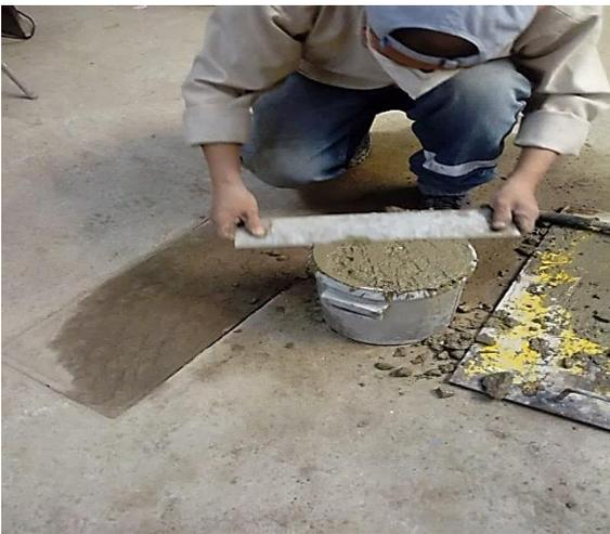
Fotografía 9. Ensayo de Peso unitario
