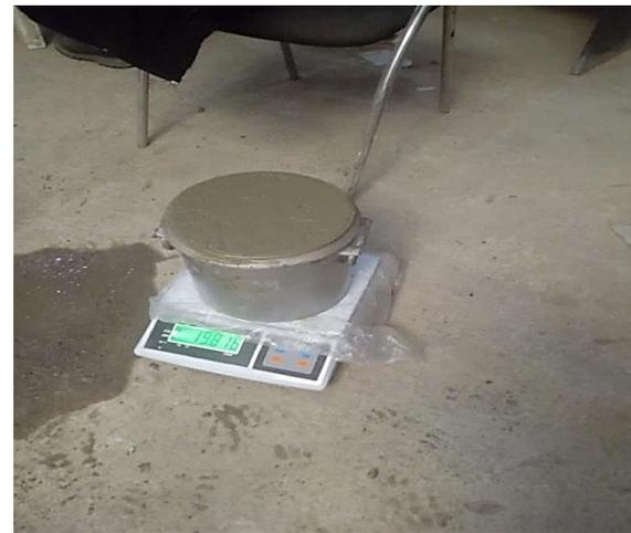
Fotografía 10. Ensayo de Peso unitario
