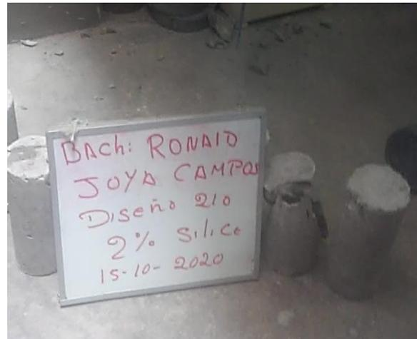
Fotografía 16. Rotura de testigos
