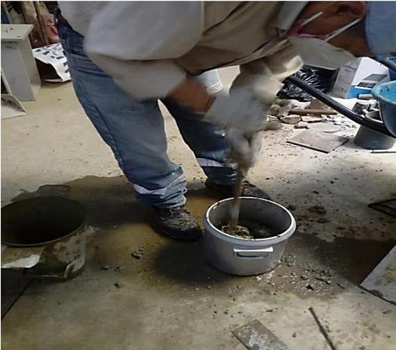
Fotografía 7. Ensayo de Peso unitario
