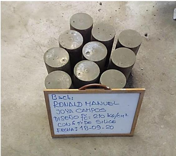
Fotografía 13. Testigos de concreto con Sílice
