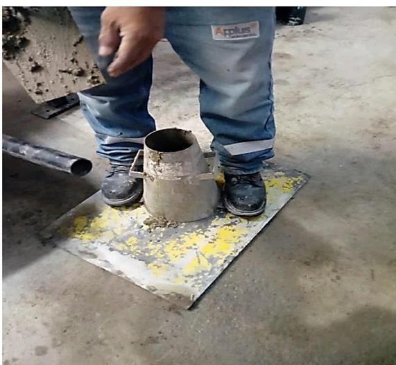
**Figura 6.** Ensayo de Asentamiento
