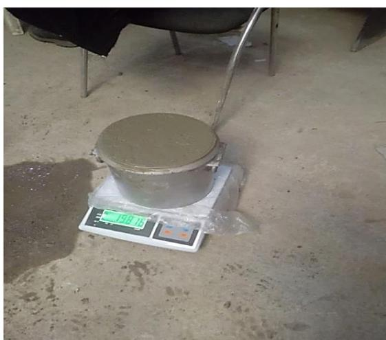
**Figura 10.** Ensayo de peso unitario del concreto **Figura 11.** Peso unitario del concreto
