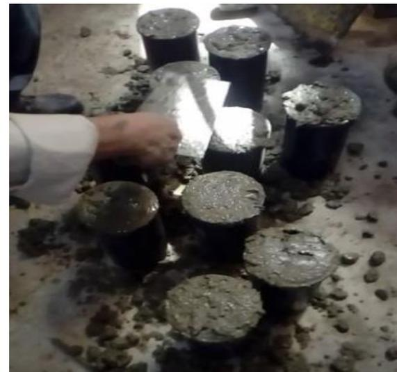
Fotografía 12. Probetas con concreto
