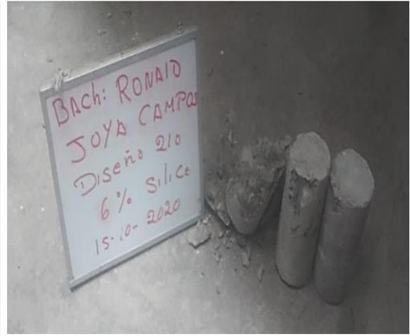
**Figura 9.** Rotura de probetas con el 6%
