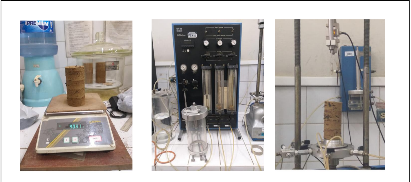
Ilustración 42. Preparación de briqueta para ensayo triaxial
