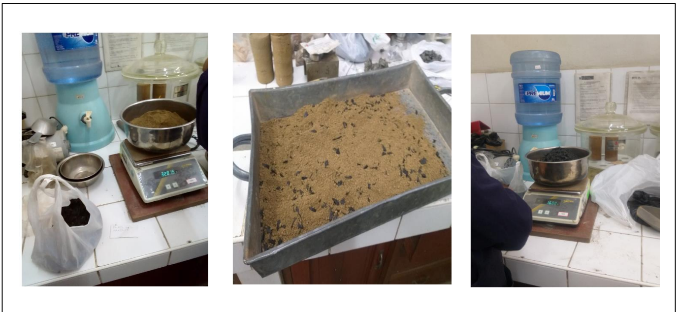
Ilustración 41. Preparación de mezcla suelo - fibra
