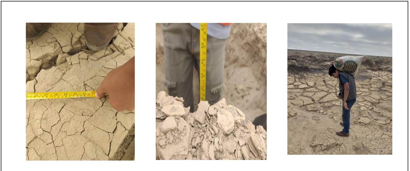
Ilustración 34. Segunda Calicata de Extracción de muestra
