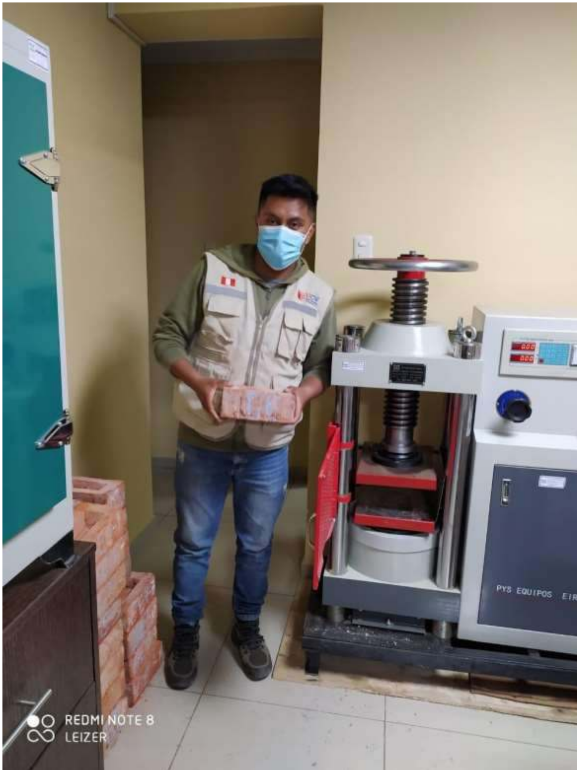
Figura 83 Rotura De Ladrillo En Laboratorio
