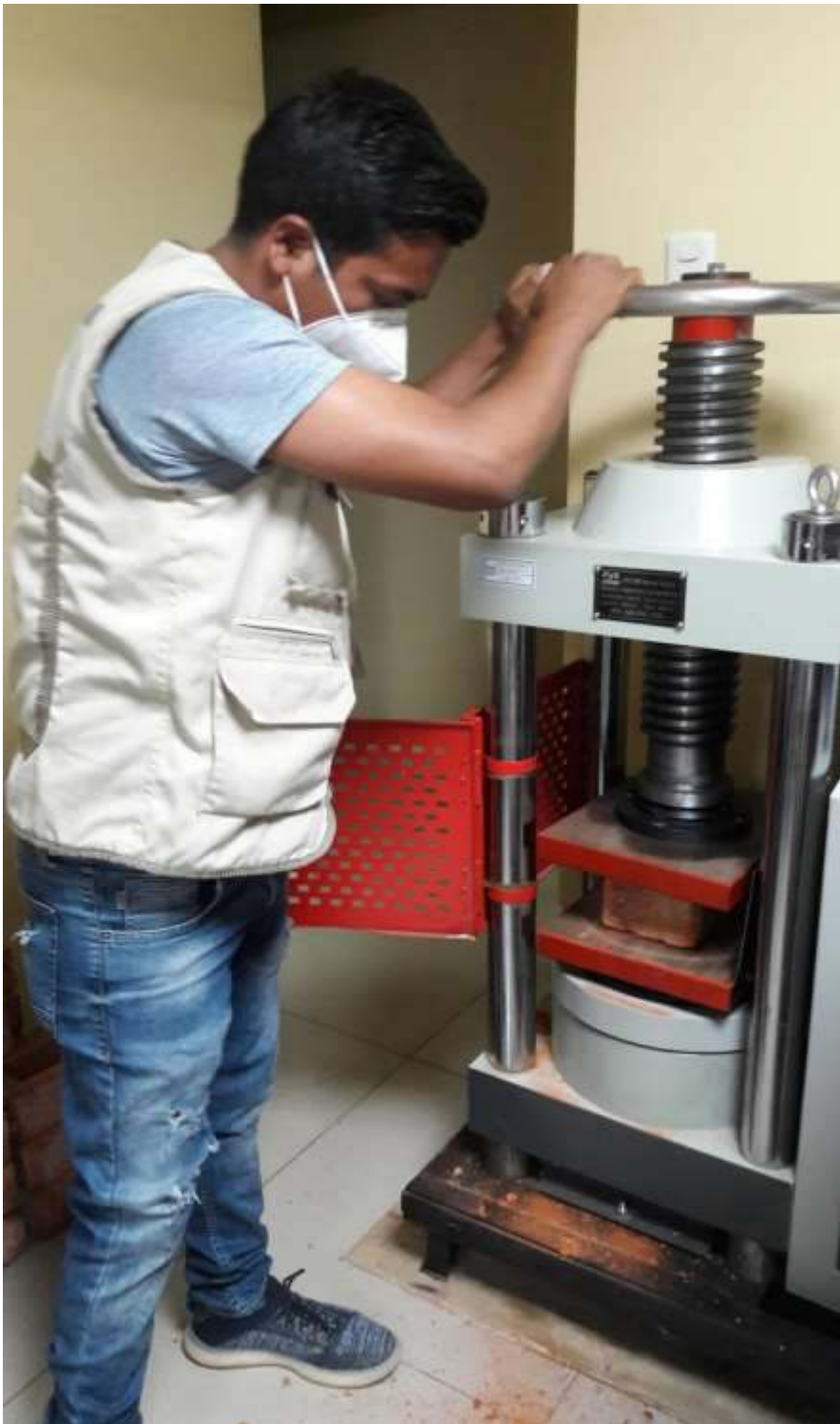
Figura 84 Rotura De Ladrillos En Laboratorio
