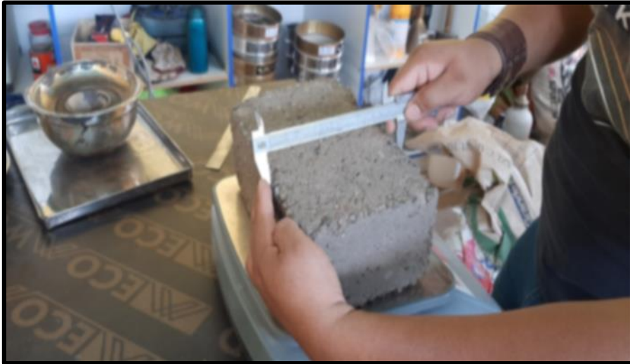
Imagen 09: Toma de datos de unidad de albañilería.
