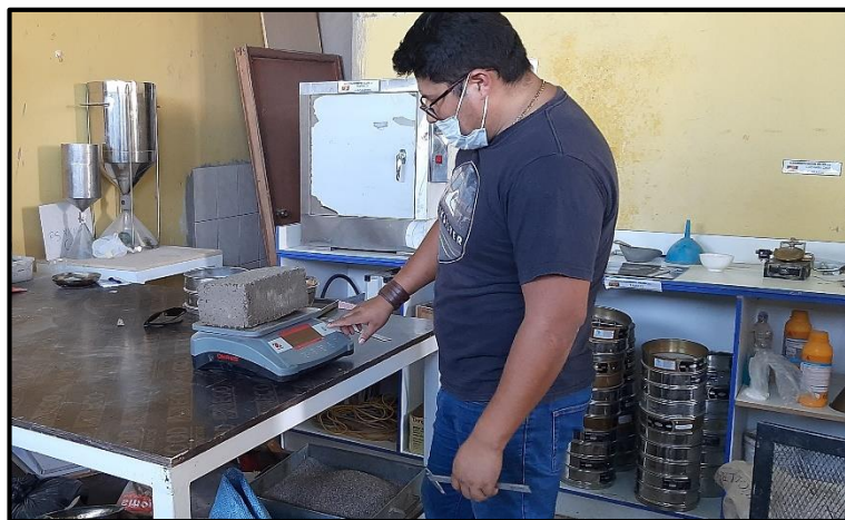
Figura 23: Recolección de datos de Unidades de albañilería de concreto. Elaboración propia.
