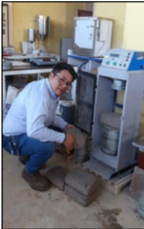
Imagen 11: Ensayo de compresión de unidades de albañilería.
