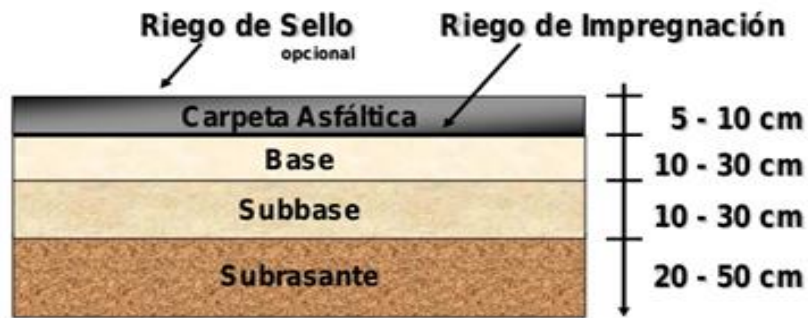
Figura 1: Sección transversal de pavimento. Fuente: Cámara nacional del cemento
