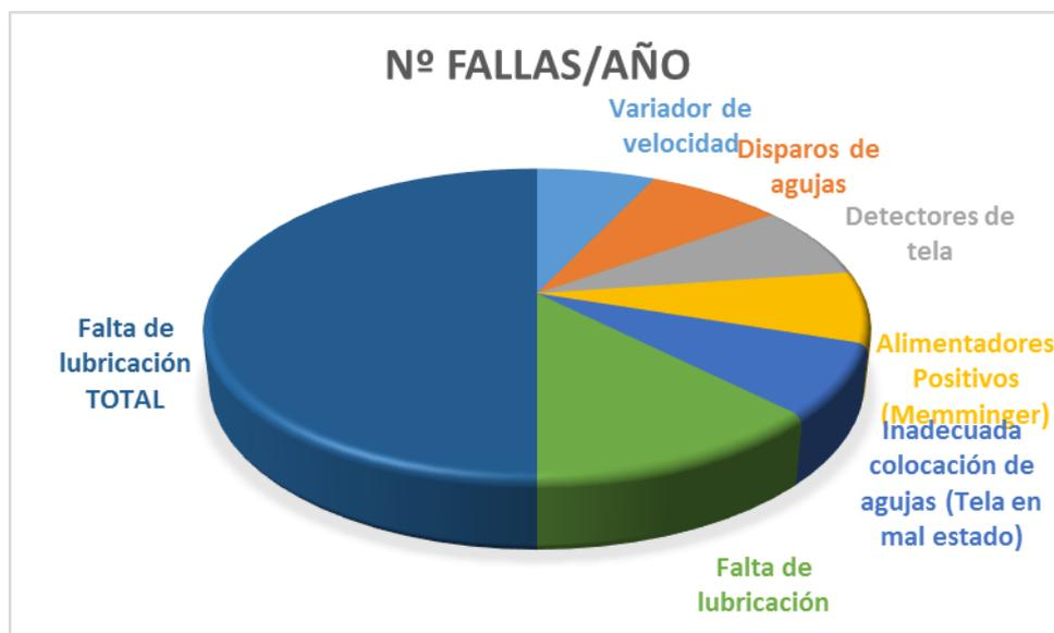
Figura 01. Fallas en máquinas circulares Fuente:
