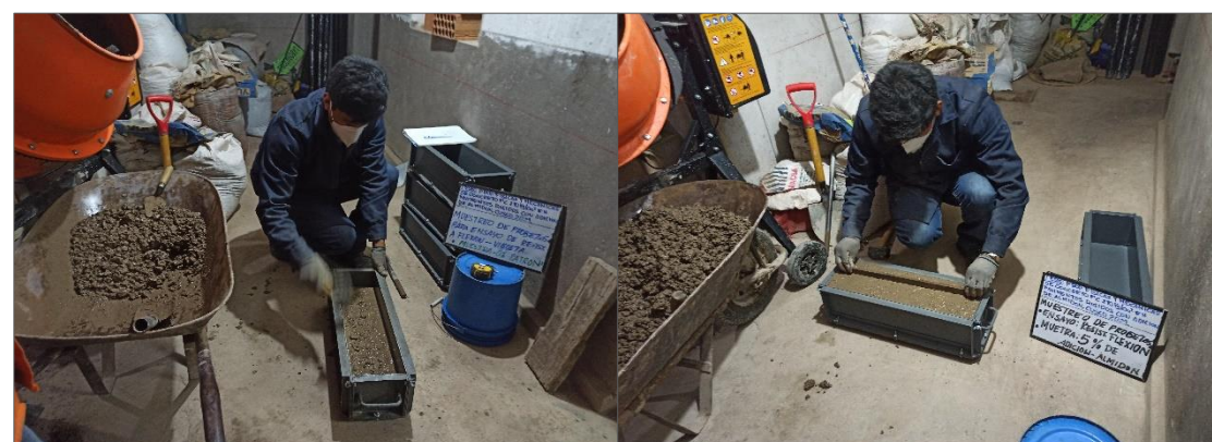
Figura 17. Elaboración de las probetas prismáticas (vigas)
