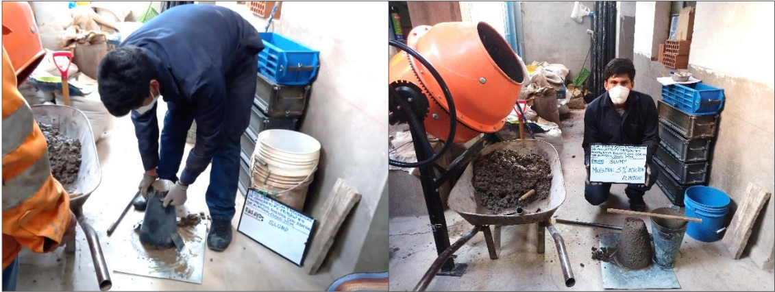
Figura 19. Ensayos de asentamiento de concreto fresco
